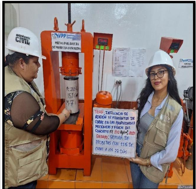
**Figura Ñ:** Se realizó el diseño de mezcla con 20% de filamento de cobre, asimismo la rotura de las probetas a los 7,14 y 28 días.
