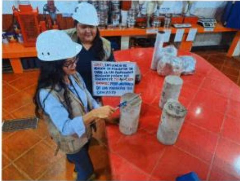
**SE OBSERVA, A LAS TESISISTAS REALIZANDO EL ENSAYO DE PESO UNITARIO DE LA PROBETA**
