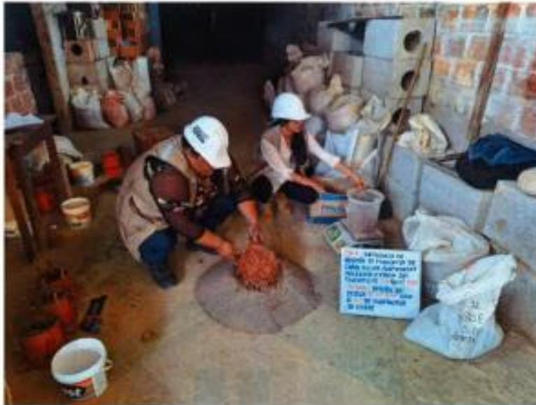
**SE OBSERVA, A LA TESISISTA REALIZANDO EL MEZCLADO DE LOS AGREGADOS CON ADICION DE FILAMENTOS DE COBRE, PARA EL DISEÑO DE MEZCLAS DE CONCRETO**
