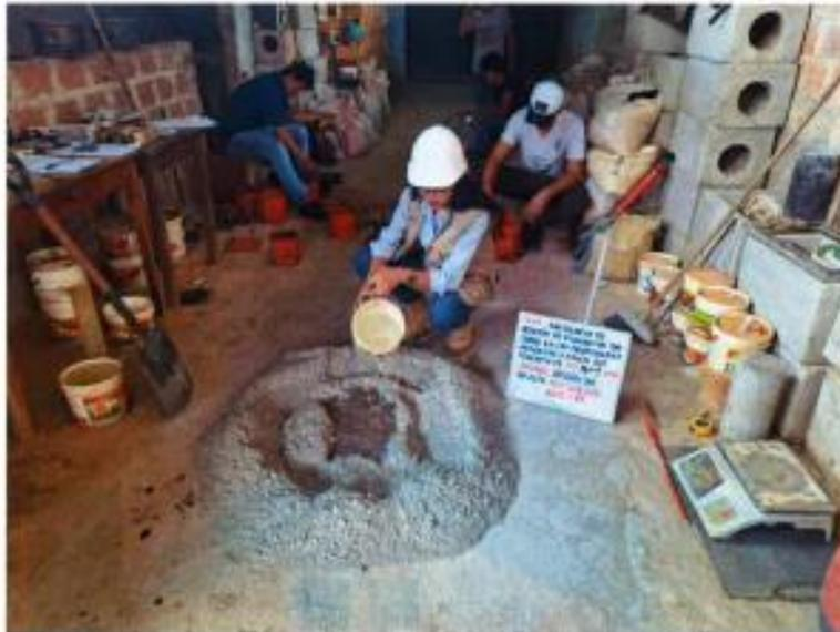
**SE OBSERVA, A LAS TESISTAS REALIZANDO PRUEBA DE ASENTAMIENTO O SLUMP**
