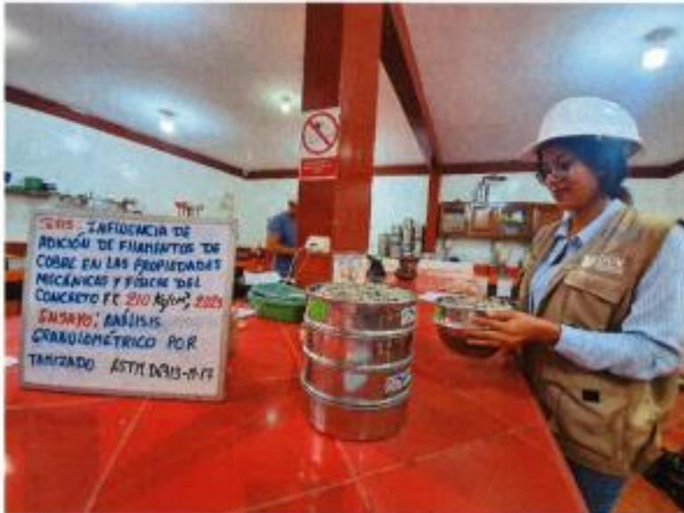
SE OBSERVA AL TESISTA, REALIZANDO LOS ENSAYOS EN EL LABORATORIO DE MECÁNICA DE SUELOS, CONCRETO Y ASFALTO – ANÁLISIS GRANULOMÉTRICO POR TAMIZADO
