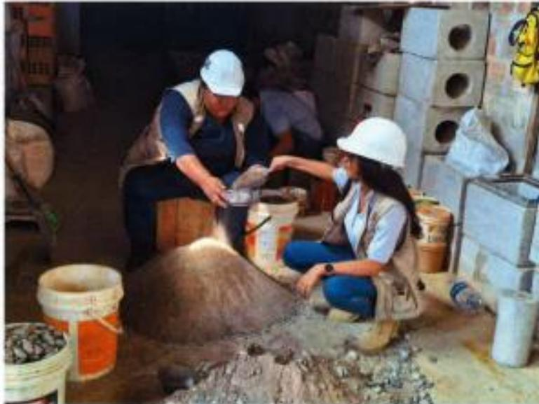
**SE OBSERVA, A LA TESISISTA REALIZANDO EL MEZCLADO DE LOS AGREGADOS PARA EL DISEÑO DE MEZCLAS DE CONCRETO**
