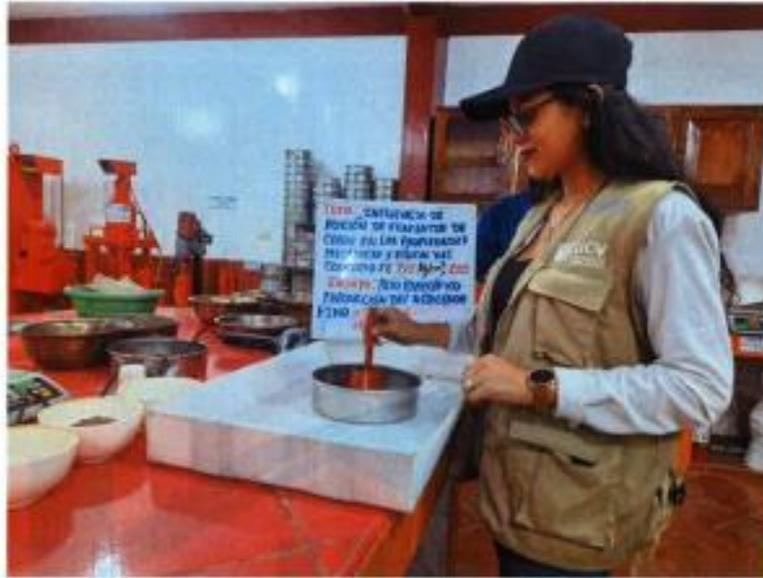
SE OBSERVA LA TESISTA, REALIZANDO LOS ENSAYOS EN EL LABORATORIO DE MECÁNICA DE SUELOS, CONCRETO Y ASFALTO – PESO ESPECIFICO Y ABSORCIÓN DEL AGREGADO FINO
