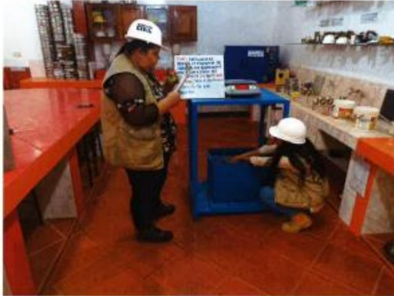
**SE OBSERVA, A LAS TESISTAS REALIZANDO EL ENSAYO DE PESO ESPECIFICO Y ABSORCION DE LA PROBETA**
