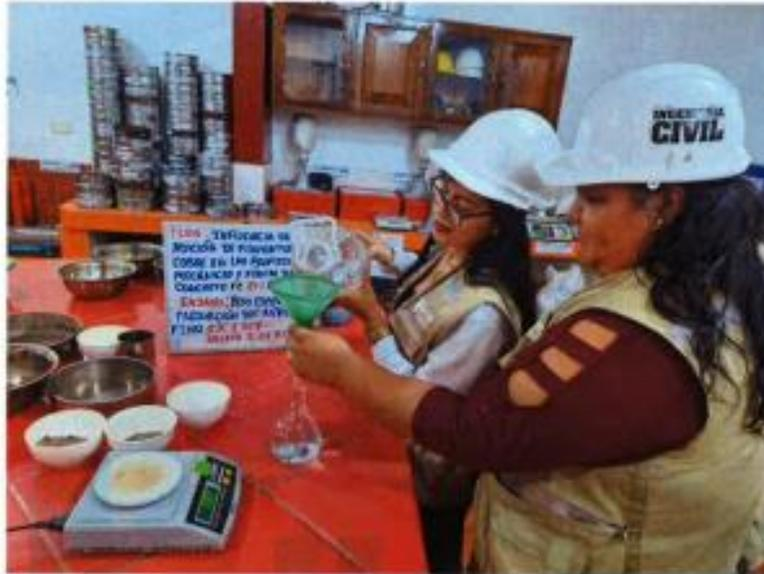
SE OBSERVA LAS TESISISTAS, REALIZANDO LOS ENSAYOS EN EL LABORATORIO DE MECÁNICA DE SUELOS, CONCRETO Y ASFALTO – PESO ESPECIFICO Y ABSORCIÓN DEL AGREGADO FINO
