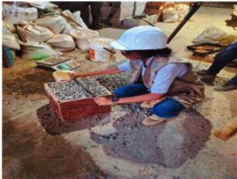
**SE OBSERVA LOS TESISISTAS, REALIZANDO LOS ENSAYOS EN EL LABORATORIO DE MECÁNICA DE SUELOS, CONCRETO Y ASFALTO – PESO UNITARIO VARILLADO DEL AGREGADO FINO**
