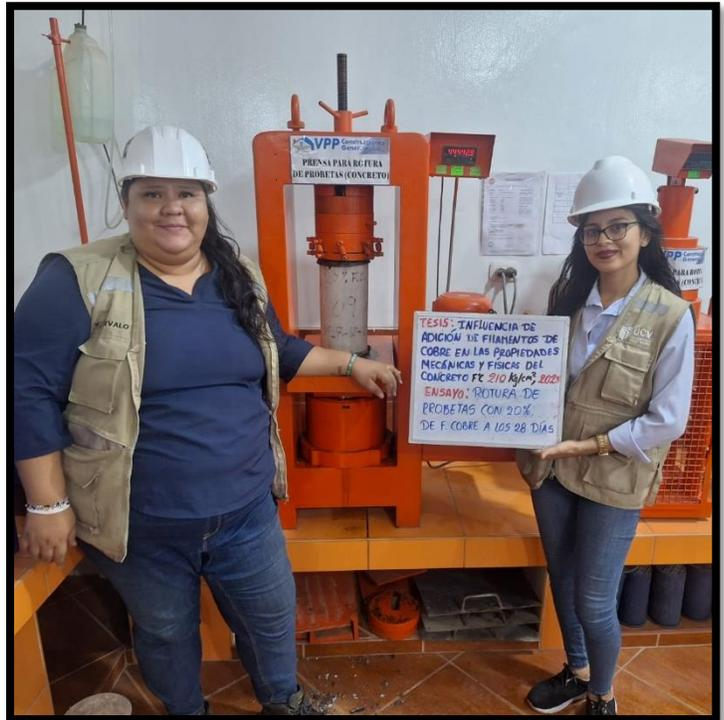
**Figura O:** Se realizó el diseño de mezcla con 25% de filamento de cobre, asimismo la rotura de las probetas a los 7,14 28 días.
