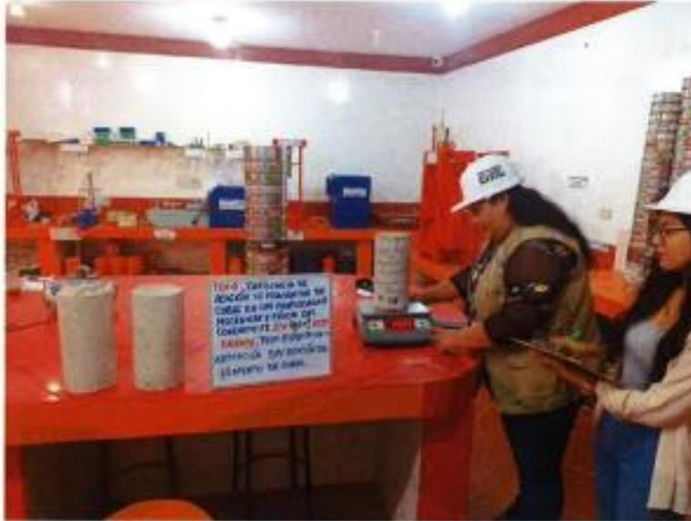
**SE OBSERVA, A LAS TESISISTAS REALIZANDO EL ENSAYO DE PESO ESPECIFICO Y ABSORCION DE LA PROBETA**
