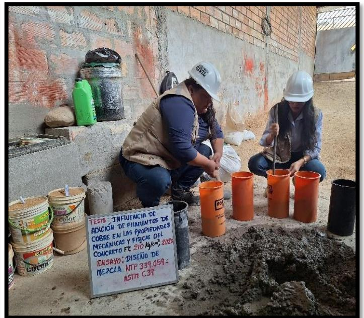
**Figura K:** Se realizó el diseño de mezcla con 15% de filamento de cobre y se verificó el asentamiento de la mezcla obteniendo 3.5”.
