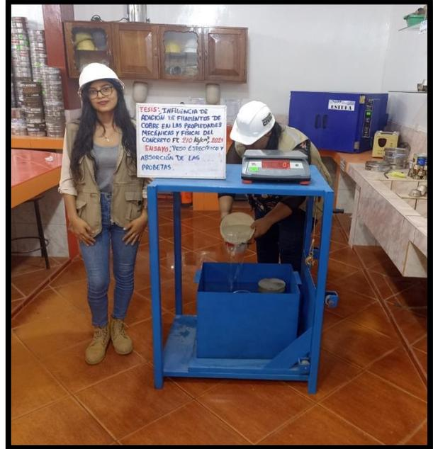
**Figura N:** Además, se realizó el ensayo de peso específico y absorción de los especímenes (Secado en estufa a  $110 \pm 5^\circ\text{C}$ ). Posterior se realizó el ensayo de resistencia a la compresión del 15% de filamentos de cobre a los 7, 14 y 28 días respectivamente.
