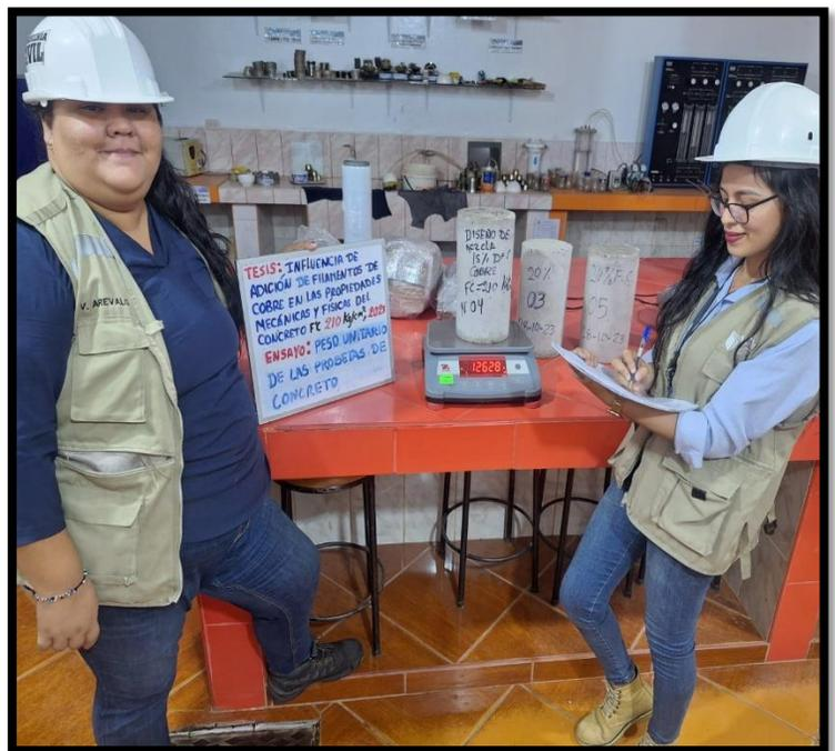
**Figura M:** Se realizó el ensayo de peso unitario (medición de diámetro y de altura de los especímenes de concreto). Además, se realizó el ensayo de peso específico y absorción de los especímenes (Probetas sumergidas en agua).
