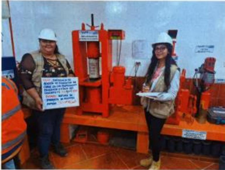
**SE OBSERVA, ENSAYOS DE RESISTENCIA A LA COMPRESIÓN DEL CONCRETO EN MUESTRAS CILINDRICAS EN LABORATORIO DE MECÁNICA DE SUELOS, CONCRETO Y ASFALTO.**
