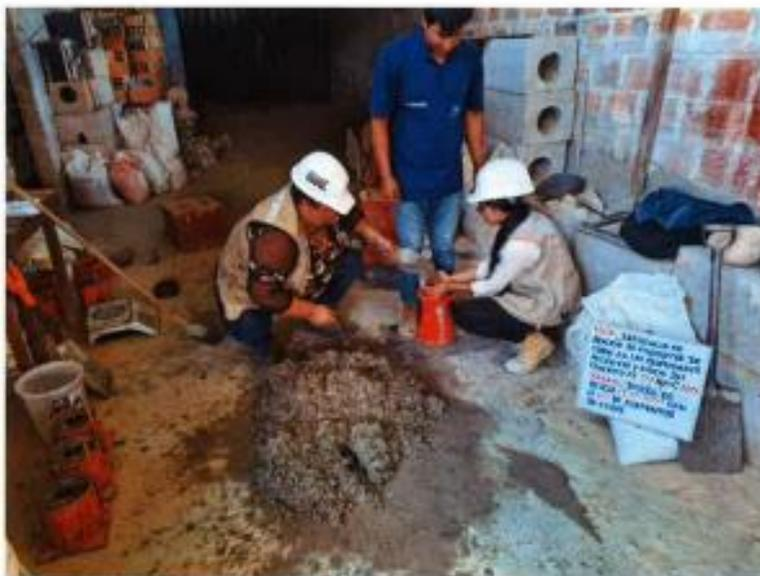
**SE OBSERVA, A LA TESISTA REALIZANDO PRUEBA DE ASENTAMIENTO O SLUMP**
