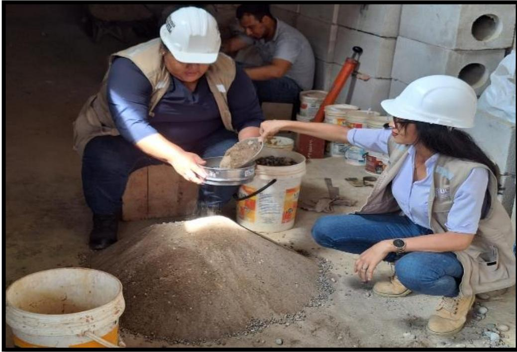
**Figura D:** Realizamos el ensayo de peso unitario, suelto de la piedra chancada.
