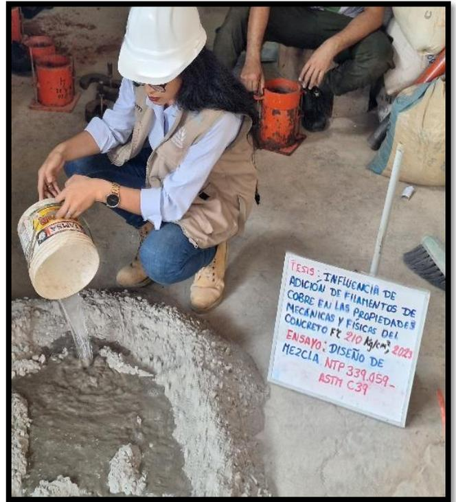
**Figura J:** Verificación del asentamiento del concreto de 3" a 4" y llenado de moldes de 15x30 cm, en 3 capas chuseando 25 veces en cada uno y golpeando con la comba de goma.
