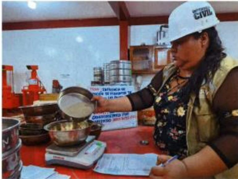
**SE OBSERVA AL TESISISTA, REALIZANDO LOS ENSAYOS EN EL LABORATORIO DE MECÁNICA DE SUELOS, CONCRETO Y ASFALTO – PESO UNITARIO SUELTO DEL AGREGADO GUESO**
