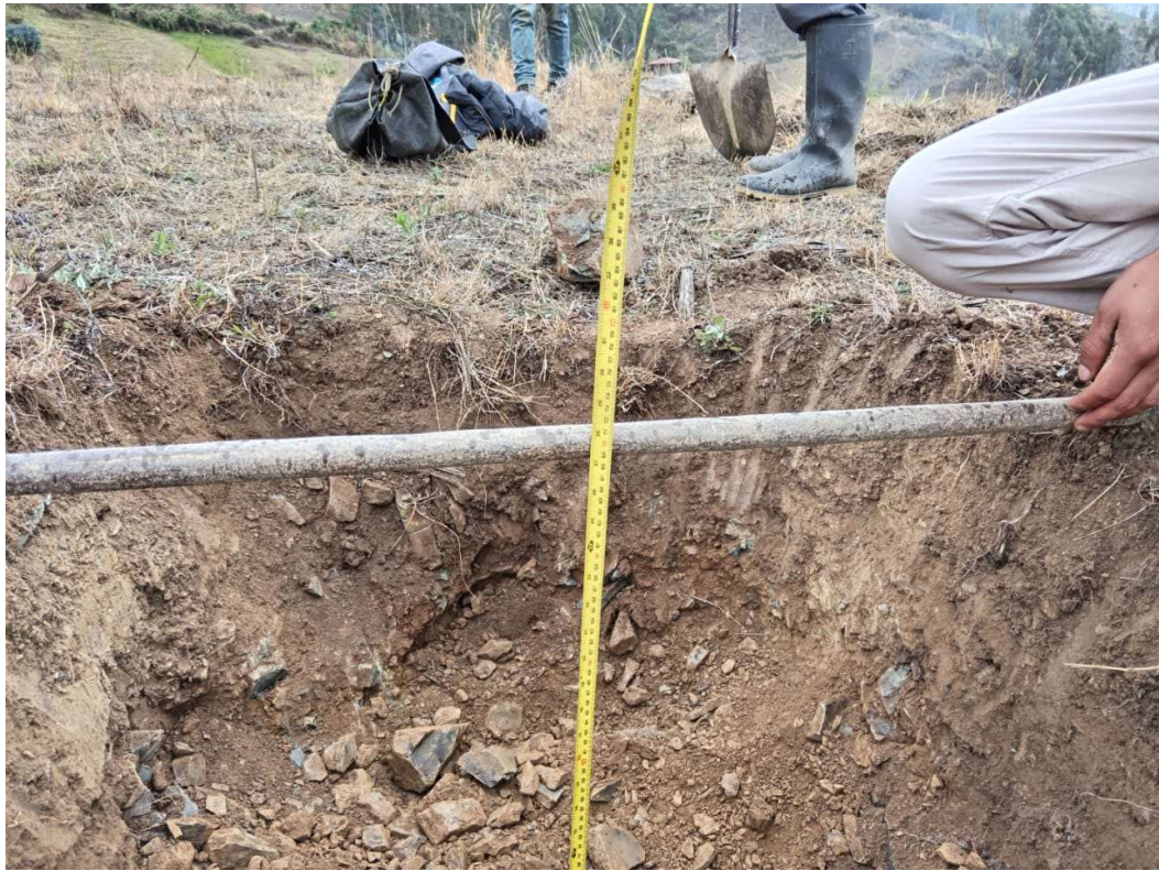
Foto N° 12: Se aprecia en la foto toma de medidas de profundidad de calicata.
