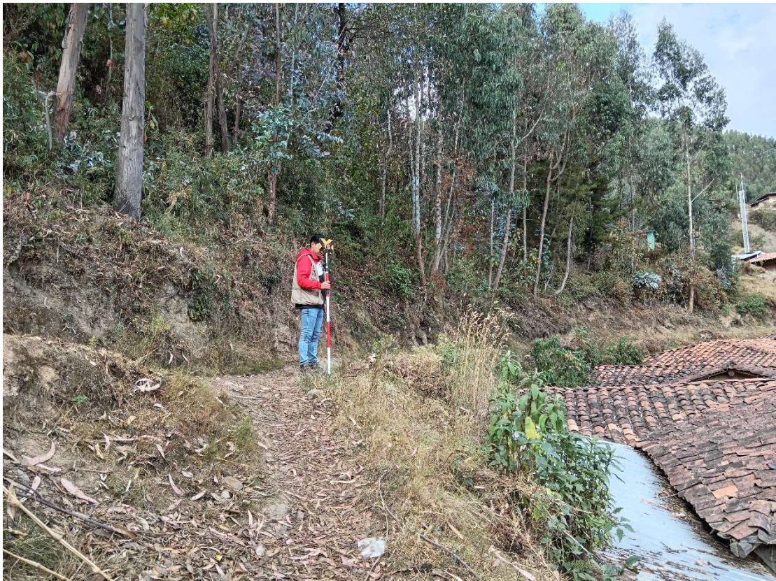
Foto N° 15: Se observa en la imagen el tesista prismando para el levantamiento topográfico.
