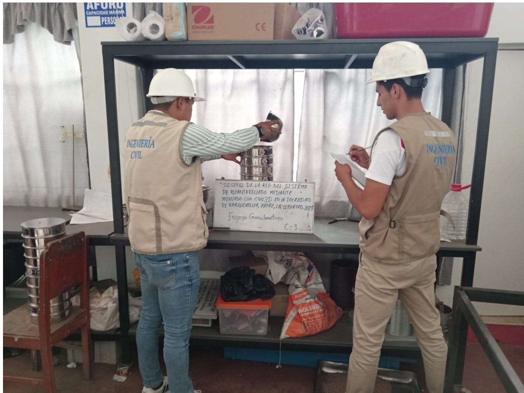
Fotos N° 01: Se aprecia a los tesisistas realizando el ensayo de granulometría en laboratorio de suelos.
