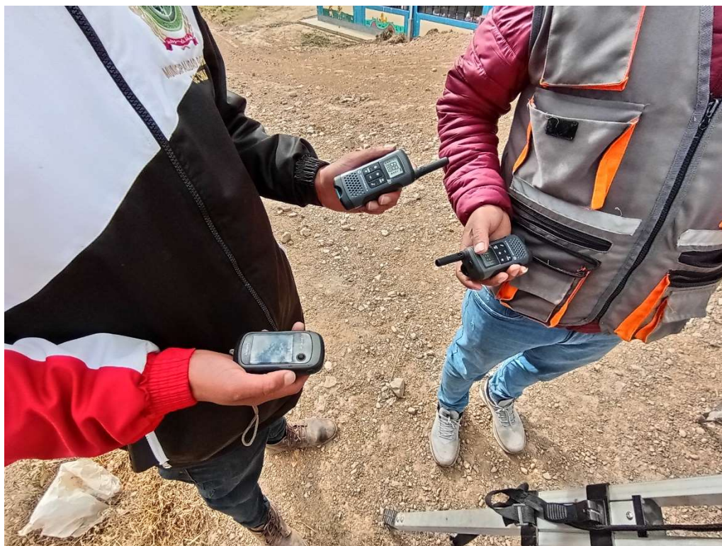
Foto N° 02: Como se observa en la figura, se utilizaron dos radios woki toki para mantener una buena comunicación el topógrafo con el ayudante (primero). Sumado a eso se utilizó un GPS para referencia del BM01 .
