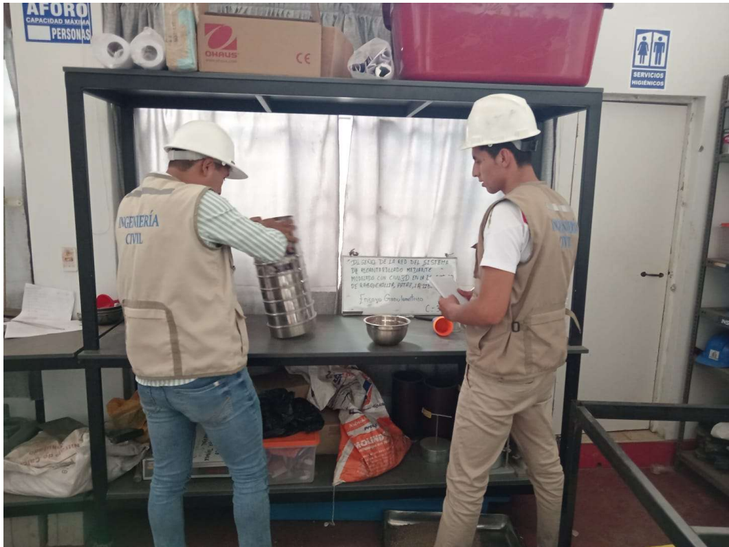
Foto N° 02: Como se observa en la figura, los testistas realizando el tamizado de las muestras.
