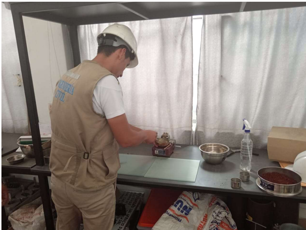
Foto N° 07: Se aprecia en la foto al tesista trabajando en el aparato de Casagrande.
