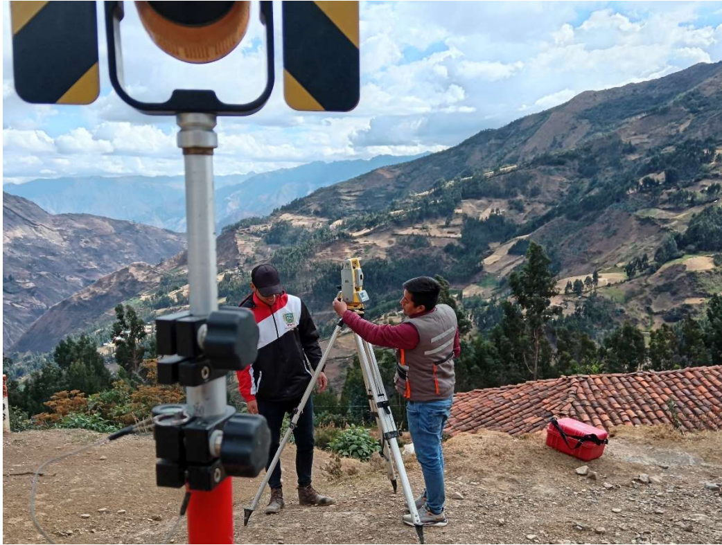
Foto N° 06: Se aprecia en la foto al topógrafo dando indicaciones al tesista como estacionar y nivelar a estación total.
