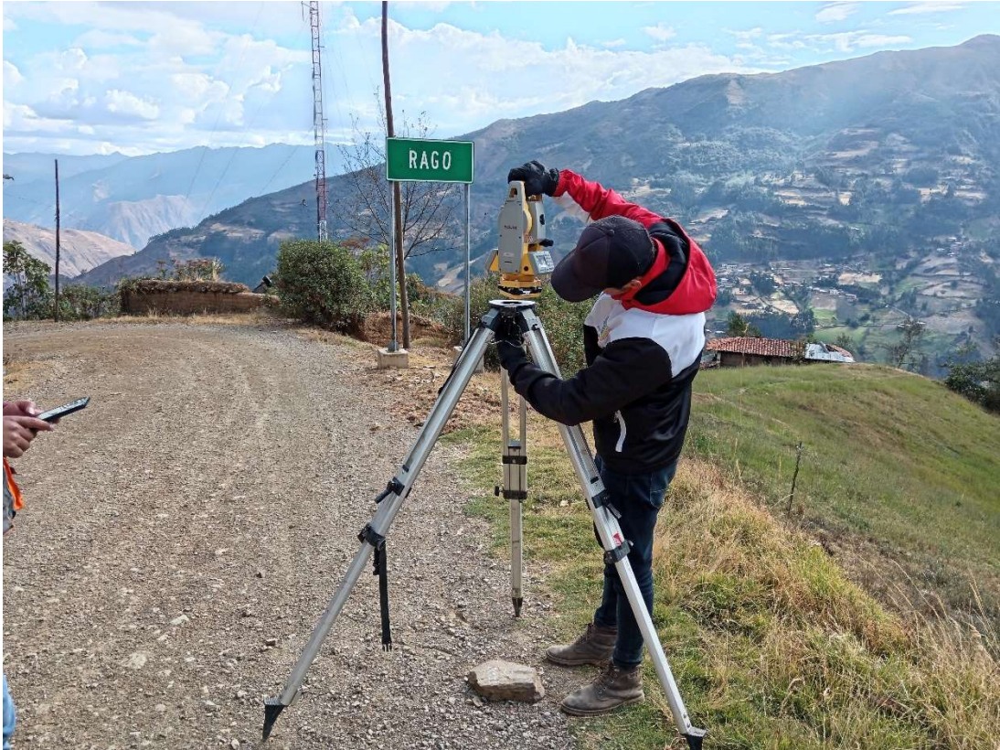
Foto N° 20: Se observa en la imagen al tesista estacionando el equipo topográfico.
