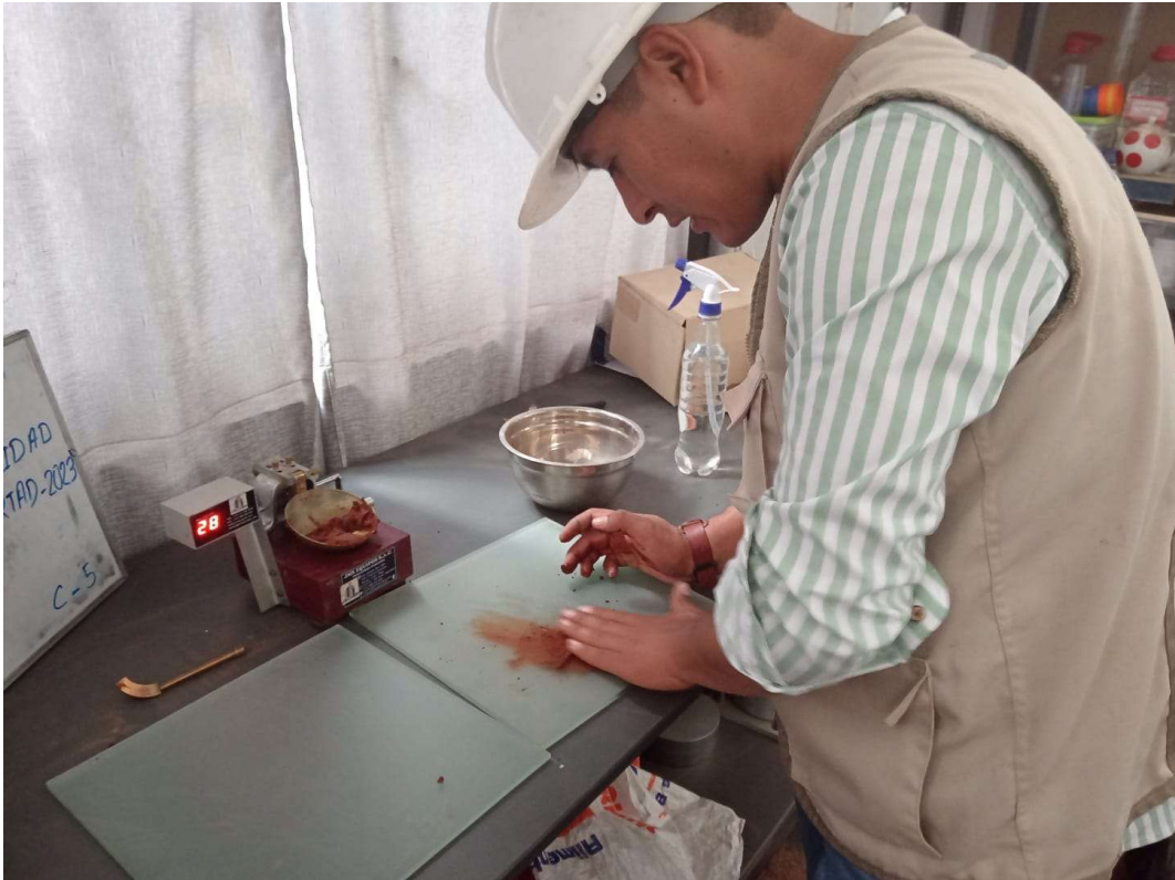
Foto N° 08: Se aprecia en la foto al testista realizando el ensayo de limite plástico.
