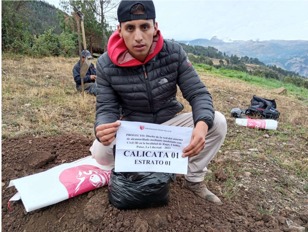
Foto N° 02: Como se observa en la figura, el tesista recogiendo el primer estrato a una profundidad de 0.50m
