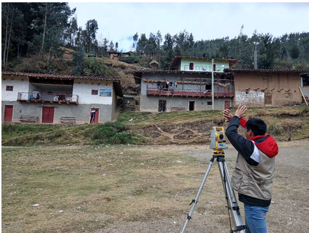
Foto N° 16: Se observa en la imagen a los tesistas tomando punto de referencia para el BM.
