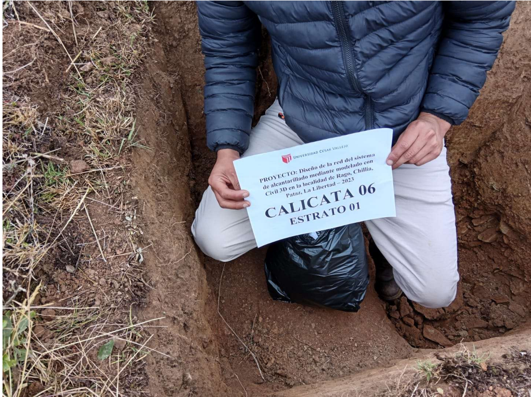
Foto N° 10: Se aprecia en la foto al tesista con la muestra del estrato 01 de la calicata 06.
