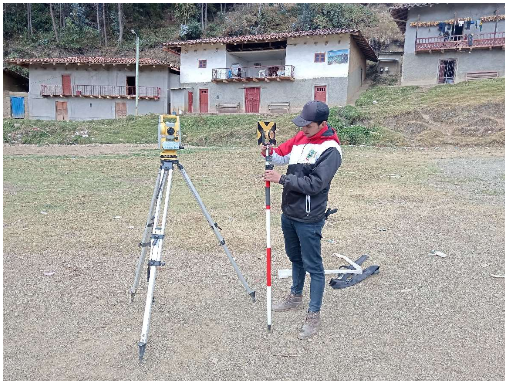
Foto N° 03: Como se observa en la figura, el tesista con la estación total y el prisma que se utilizó para el levantamiento.
