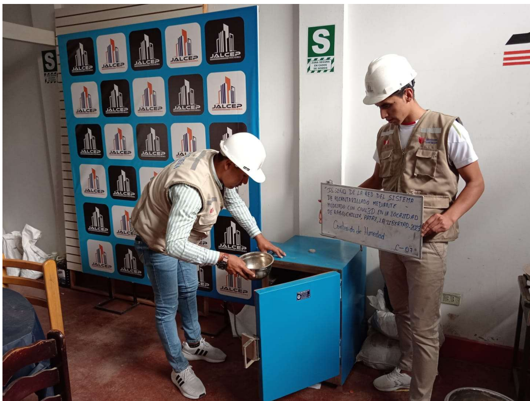
Foto N° 04: Se aprecia en la foto a los tesistas realizando el ensayo contenido de humedad de una de las calicatas.
