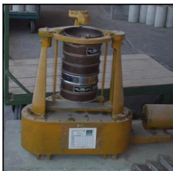
Figura 3. Análisis granulométrico fino
