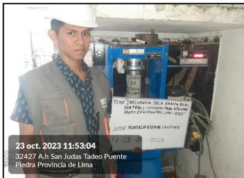
*Figura 31. Ensayo de resistencia a la compresión 28 días – 15% baritina*
