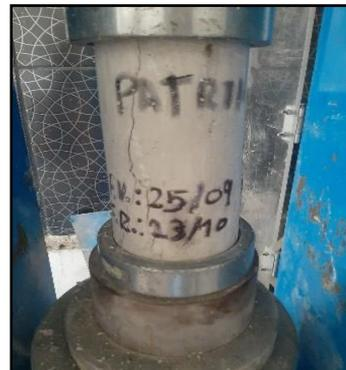
*Figura 32. Ensayo de resistencia a la compresión 28 días – patron baritina*
