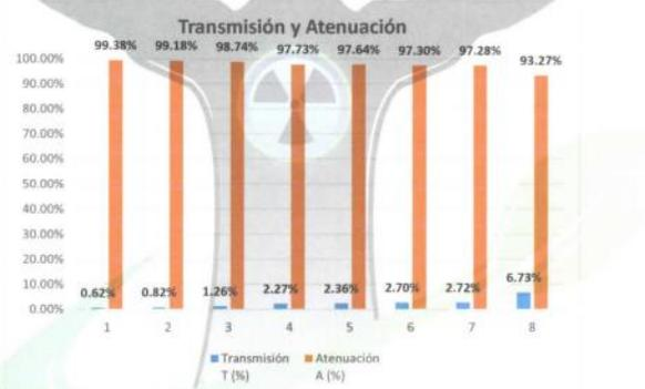
**Figura 1. – Transmisión y atenuación de las 8 placas**
