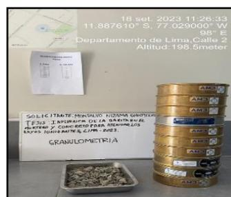
Figura 11. Granulometría de agregado grueso
