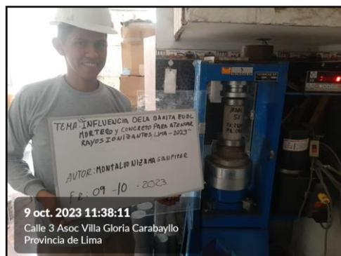
*Figura 20. Ensayo de resistencia a la compresión 14 días – 5% baritina*
