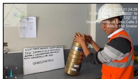
*Figura 8. Granulometría de agregado fino*
