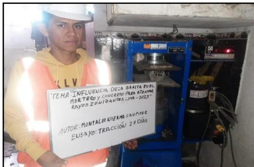
Figura 25. Ensayo de resistencia a traccion 28 días – 15% baritina
