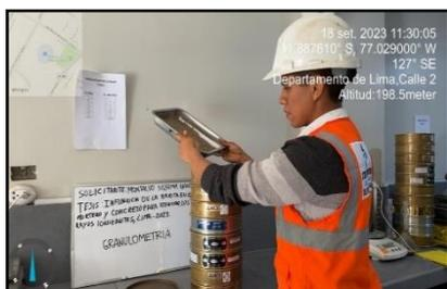
*Figura 7. Granulometría de agregado fino*
