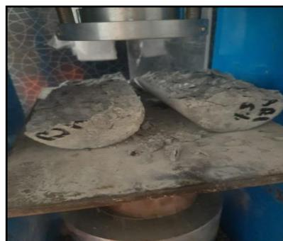
Figura 26. Ensayo de resistencia a traccion 28 días
