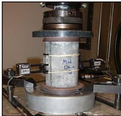
*Figura 4.* Ensayo de compresión
