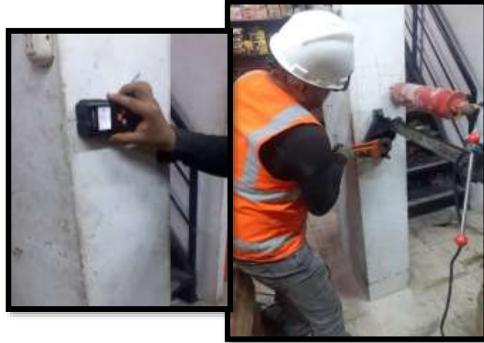
Figura 28. Proceso de extracción de los testigos diamantinos
