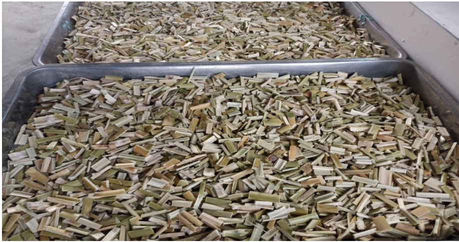
Fibras de carrizo para incorporar al barro
