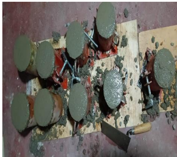
Figura 18. Briquetas con dosificación de concreto preparadas
