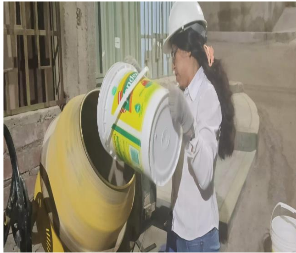
Figura 17. Elaboración de probetas de concreto
