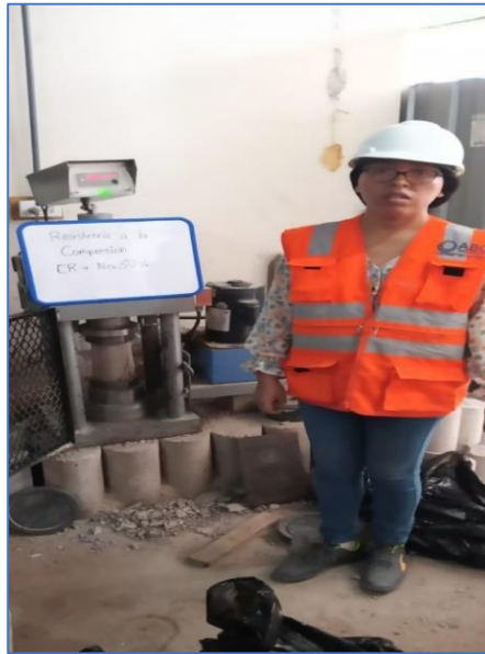
Figura 21. Rotura de probetas de concreto 28 días
