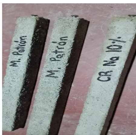
Figura 11. Muestras de barras de concreto
