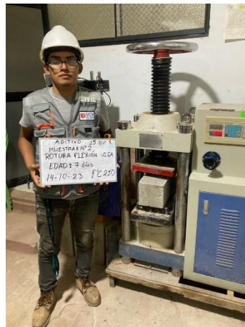
Figura 28: Rotura de probetas y vigas a los 7 días
