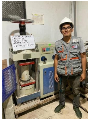
Figura 39: Rotura de probetas a los 14 días con el 15%-muestra 2
