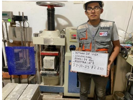
Figura 34: Rotura de probetas a los 14 días con el 10%-muestra 2
