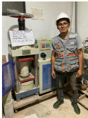
Figura 39: Rotura de probetas a los 14 días con el 15%-muestra 2
