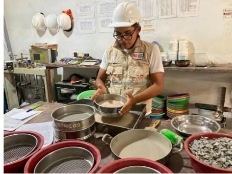
Figura 6: Peso de agregado fino para una probeta
