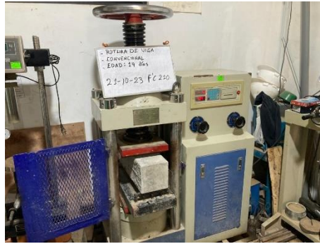
Figura 30: Rotura de vigas a los 14 días con el 5%
