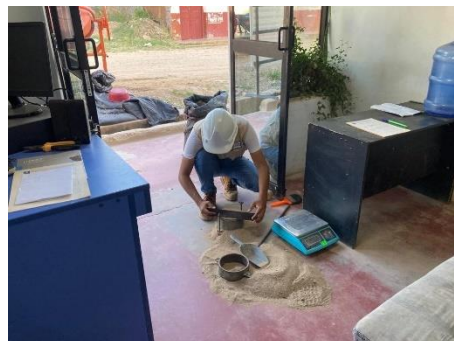
Figura 8: Enrasamiento de la probeta
