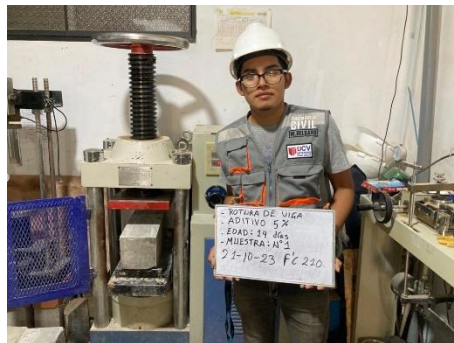
Figura 32: Rotura de vigas a los 14 días con el 10%-muestra 1
