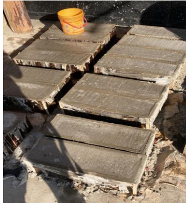
Figura 20: Fraguando vigas con adicionamiento de 0%. 5%, 10% y 15%
