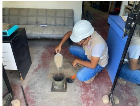
Figura 7: Primer agregado para la probeta convencional
