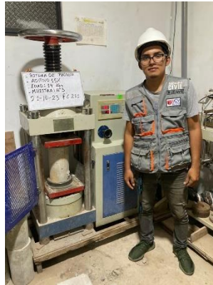
Figura 36: Rotura de probetas a los 14 días con el 5%-muestra 1
