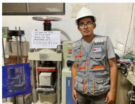
Figura 32: Rotura de vigas a los 14 días con el 10%-muestra 1
