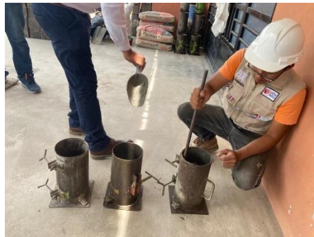
Figura 15: Chuseada 25 golpes por las 3 capas con aditivo 5%
