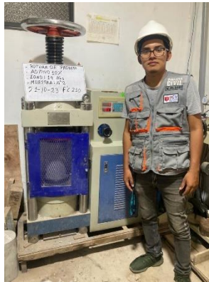
Figura 38: Rotura de probetas a los 14 días con el 15%-muestra 3
