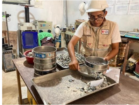
Figura 2: Peso específico de los agregados
