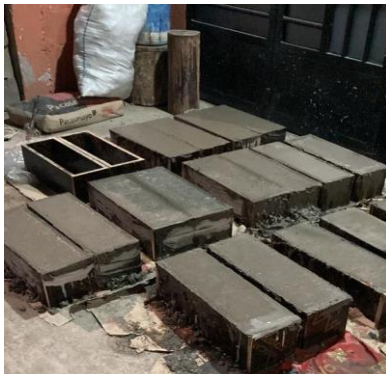
Figura 20: Fraguando vigas con adicionamiento de 0%. 5%, 10% y 15%
