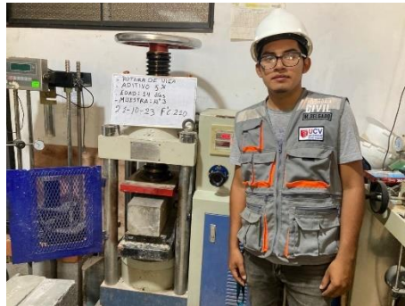
Figura 31: Rotura de vigas a los 14 días con el 5%-muestra 1
