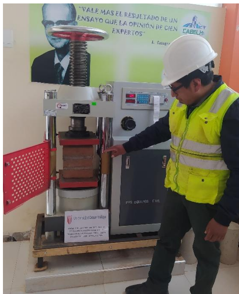
Figura 49. Prueba de resistencia a la compresión de la albañilería
