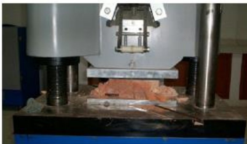
Figura 8. Prueba de compresión en ladrillos
