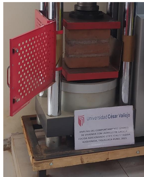
Figura 50. Pila para la prueba de resistencia a la compresión de la albañilería
