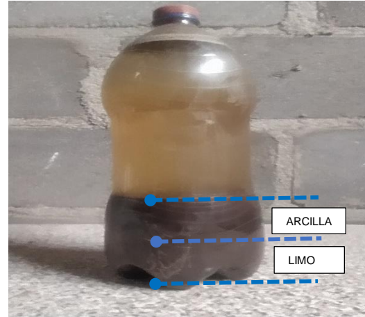
Figura 2: Prueba de la botella
