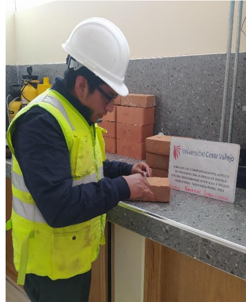
Figura 36. Prueba de variación dimensional
