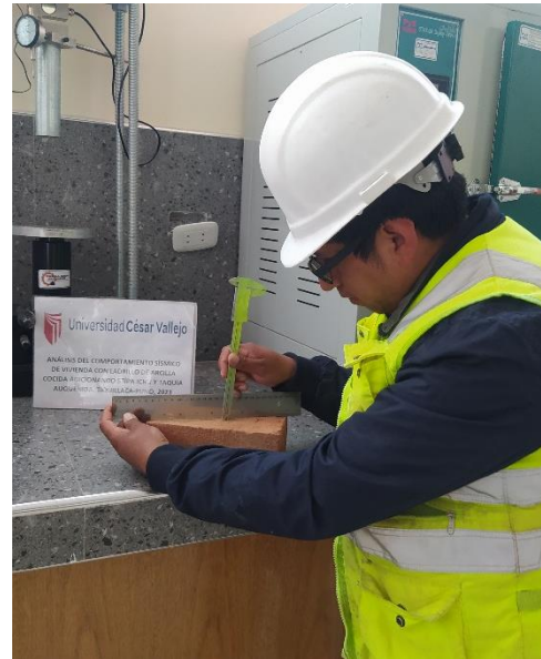
Figura 41. Tomando dimensiones del alabeo
