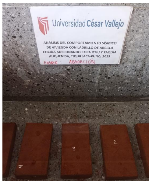
Figura 43. Ladrillos para prueba de absorción
