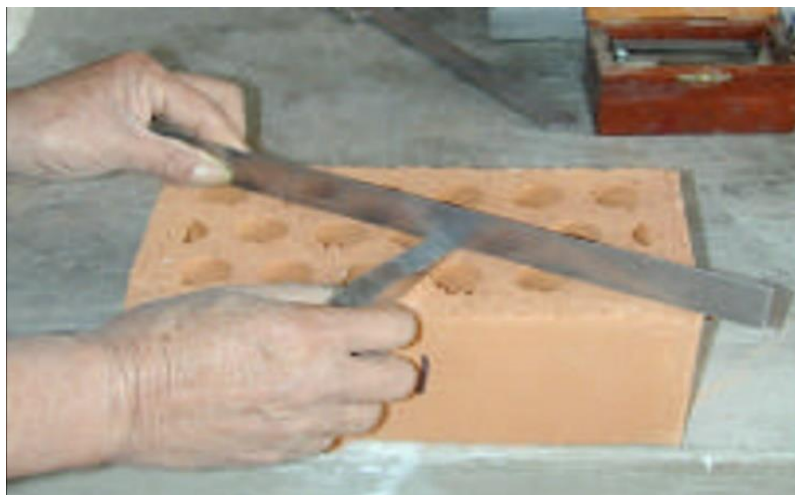
Figura 6. Prueba de alabeo del ladrillo
