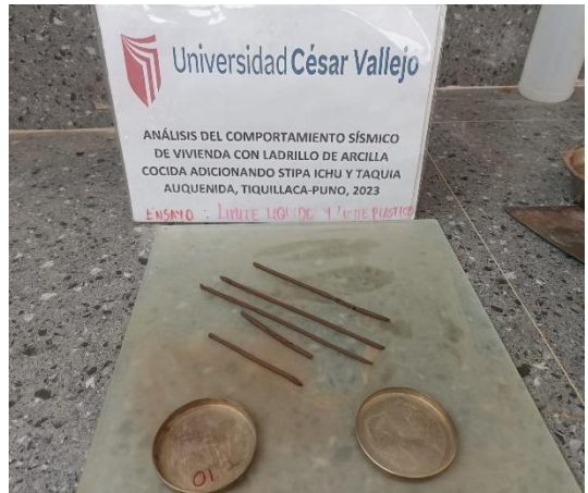
Figura 10: Prueba limite plástico
