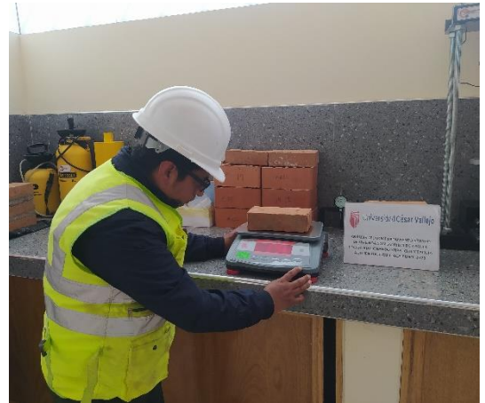
Figura 32: Pesado del ladrillo
