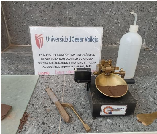
Figura 9: Prueba limite liquido
