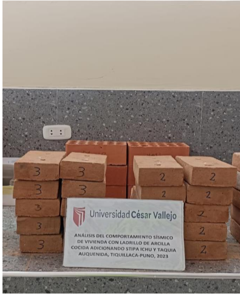
Figura 35. Ladrillos para prueba de variación dimensional
