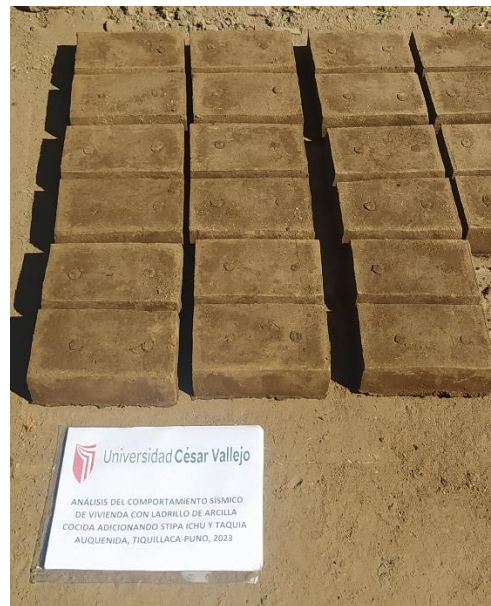
Figura 27. Moldeado del ladrillo
