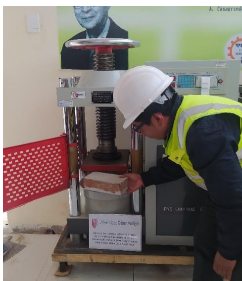
Figura 46. Ladrillos para prueba de resistencia a la compresión
