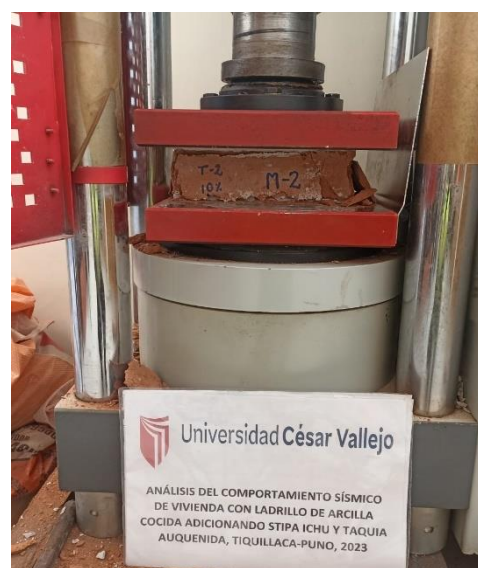
Figura 47. Prueba de resistencia a la compresión
