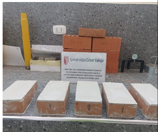
Figura 28: Refrentado del ladrillo
