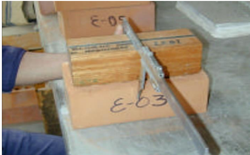
Figura 5. Prueba de variación dimensional del ladrillo
