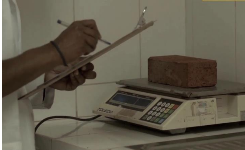
Figura 7. Prueba de absorción del ladrillo
