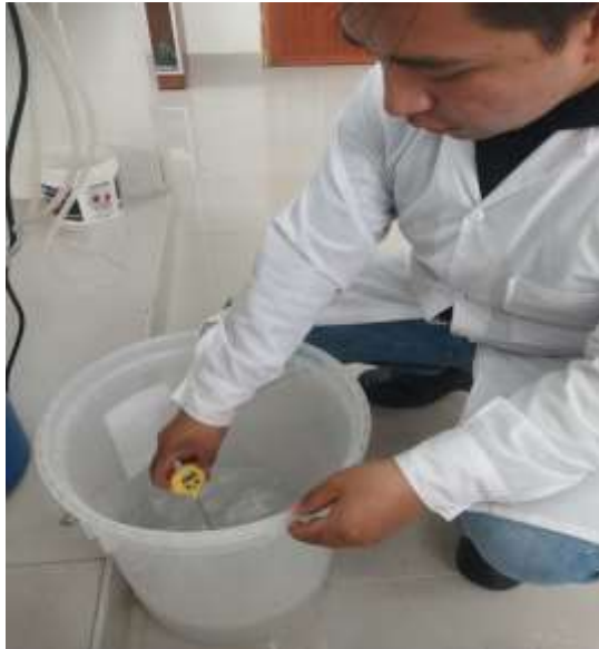
Medición de la temperatura antes del tratamiento
