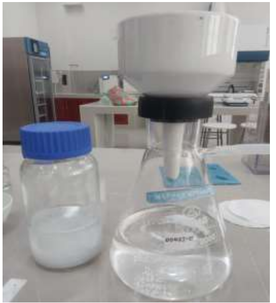
Filtración al vacío de agua tratada
