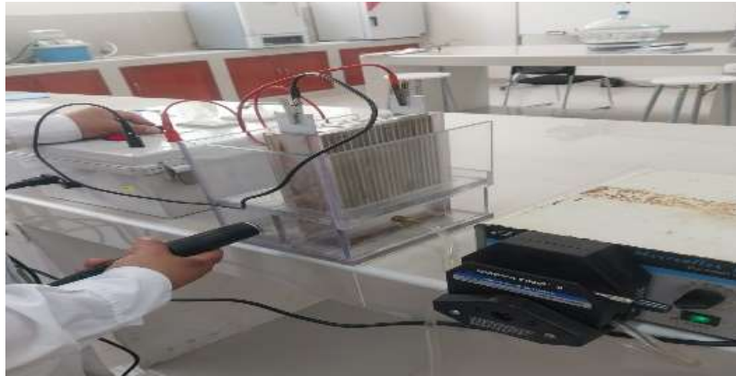
Figura 08. Llenado de la Celda de EC con caudal de 6 ml/s
