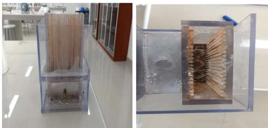
Figura 10. Distancia de 1cm entre cada placa
