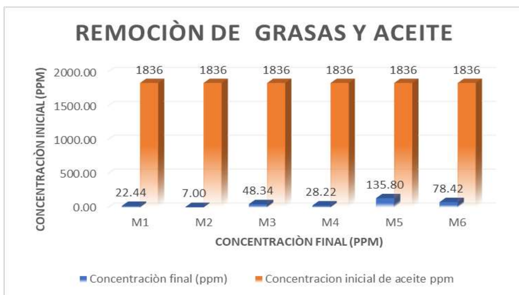
Figura 22. Comparación de la concentración inicial y concentración final de Aceites y Grasas.
