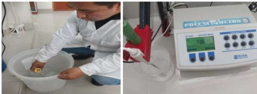
Figura 06. Medición de temperatura 19 °C y pH 7
