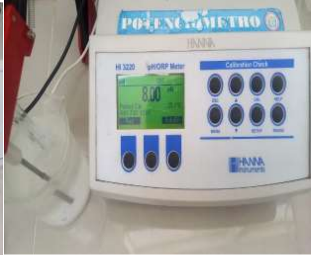
Medición del pH7 y pH8
