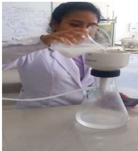
Figura 16. Filtrado del agua tratada
