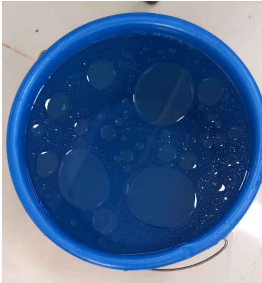
Contaminación del efluente con aceite
