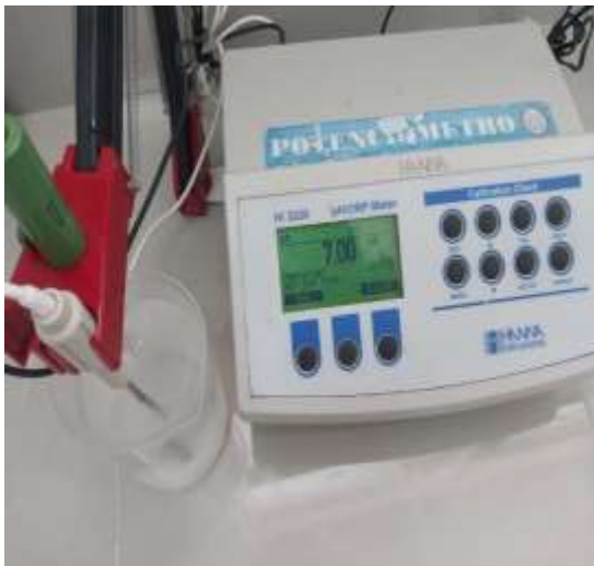
Medición del pH7 y pH8
