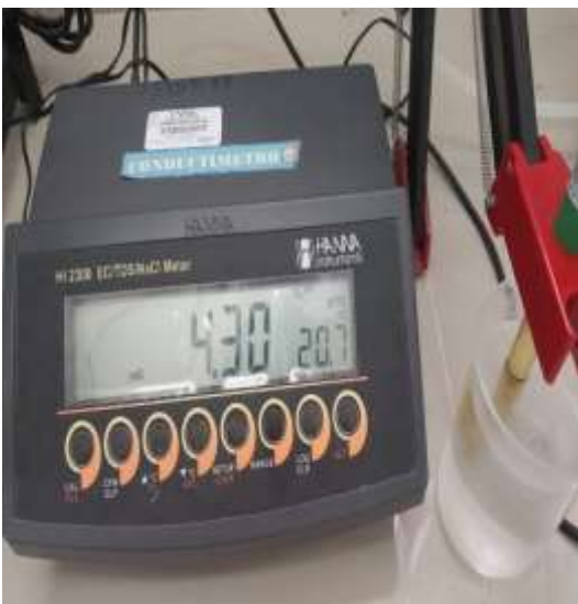
Medición de la conductividad post tratamiento
