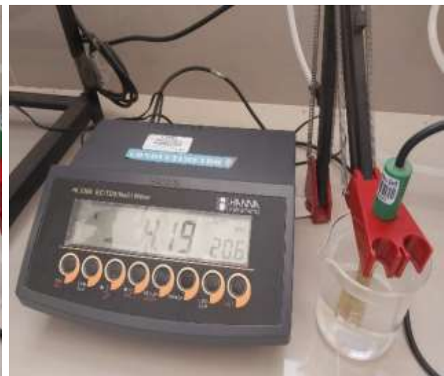
Medición de la conductividad post tratamiento
