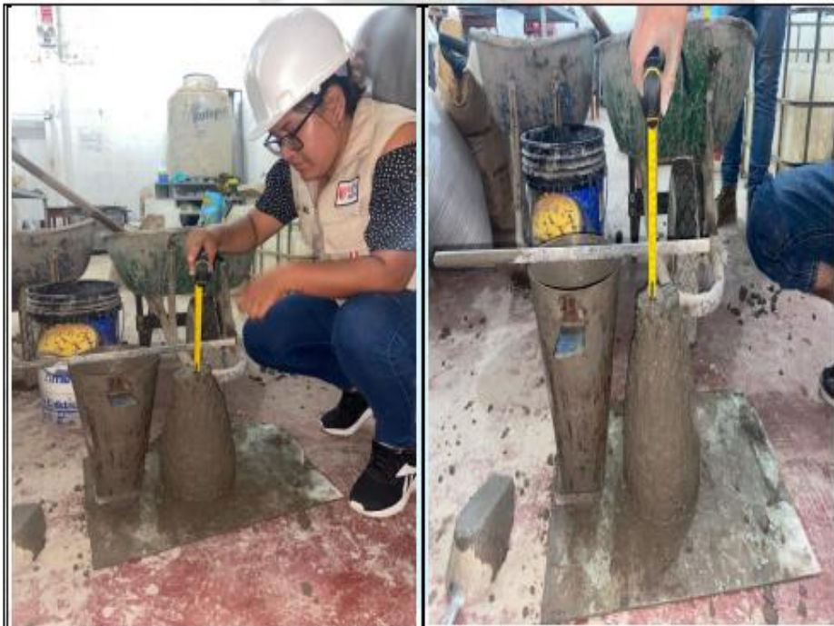
Fotos nº 11-12: En las imágenes podemos observar al personal realizando la prueba de asentamiento para los diseños de Mezclas.
