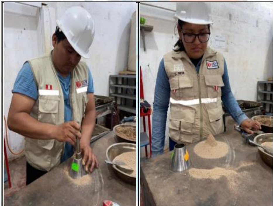
Fotos nº 15-16: En las imágenes podemos observar al personal realizando la prueba de cono de absorción para peso específico
