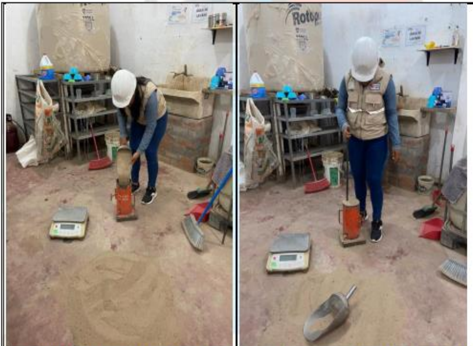
Fotos nº 07-08: En las imágenes podemos observar realización del ensayo de peso unitario de la arena zarandeada.
