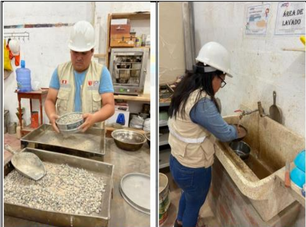
Fotos nº 01-02: En las imágenes se puede apreciar el ensayo de análisis granulométricos y el lavado de la arena zarandeada para ser utilizada en la mezcla de concreto.
