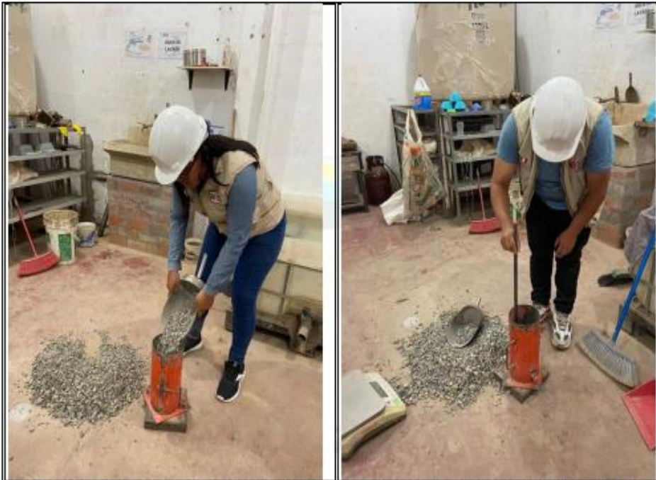
Fotos nº 05-06: En las imágenes podemos observar realización del ensayo de peso unitario de la grava chancada.
