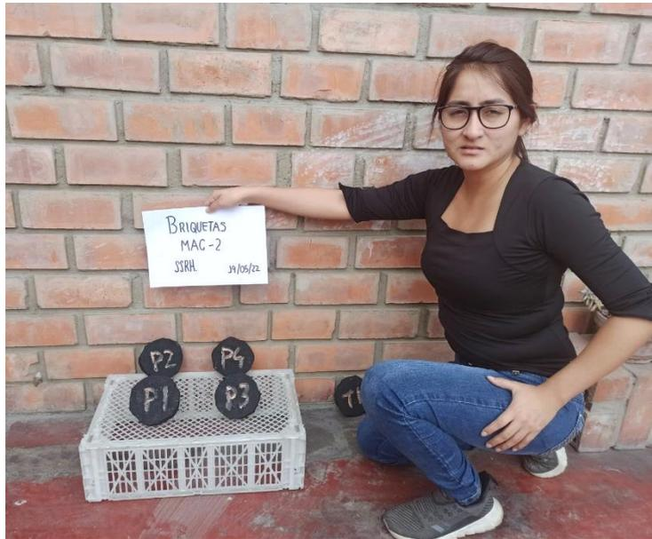
**Briquetas de mezcla asfáltica en caliente**
