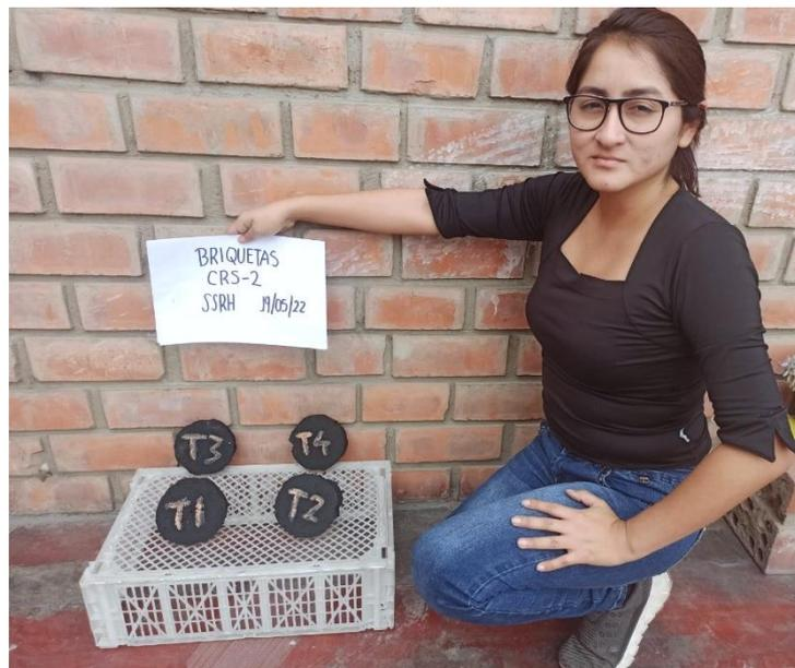
**Briquetas de emulsión asfáltica de rotura rápida**
