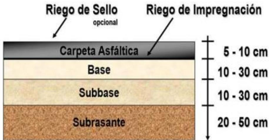
**Figura 45.** Corte transversal de pavimento flexible o asfáltico
