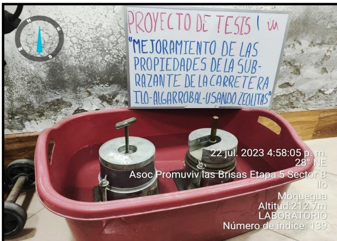
**Figura 39.** Moldes de CBR con incorporación de dosificaciones de zeolita.
