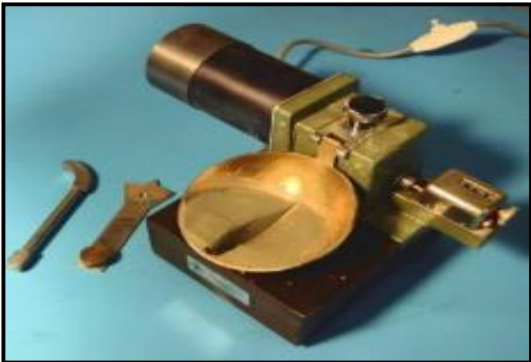
**Figura 3.** Ensayo de límite líquido - suelo con ranura de dos milímetros.
