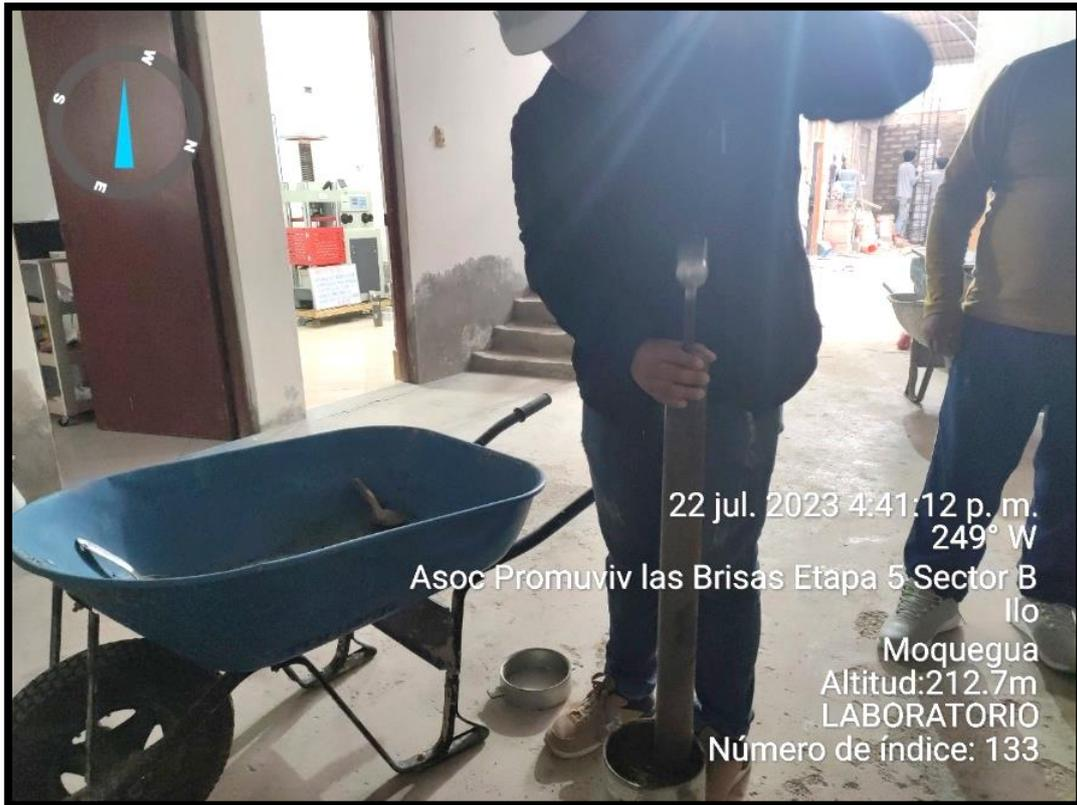
**Figura 27.** Proceso de compactación - Proctor Modificado.
