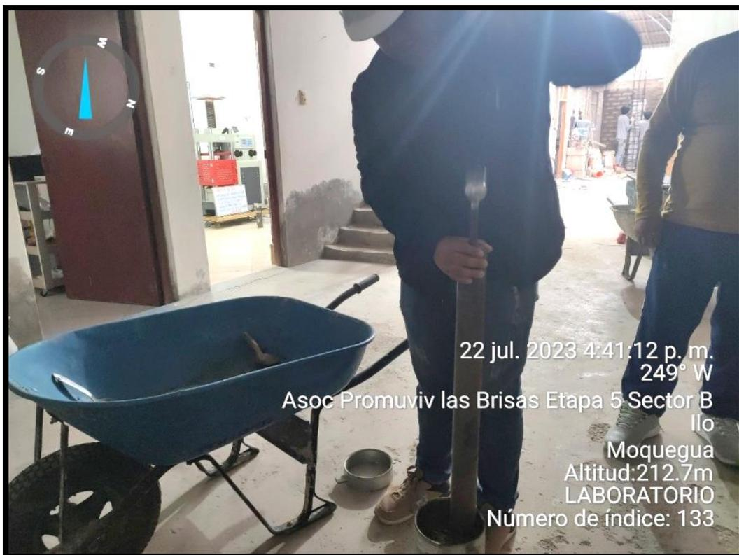
**Figura 18.** Ensayo de Proctor modificado realizados en el laboratorio.
