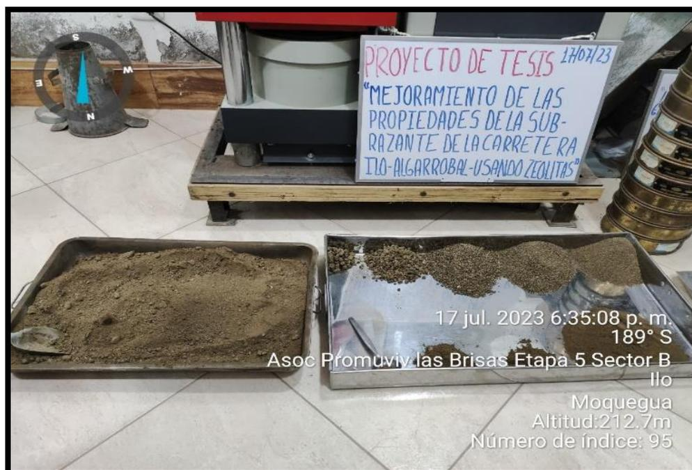
**Figura 22.** Ensayo de análisis granulométrico.
