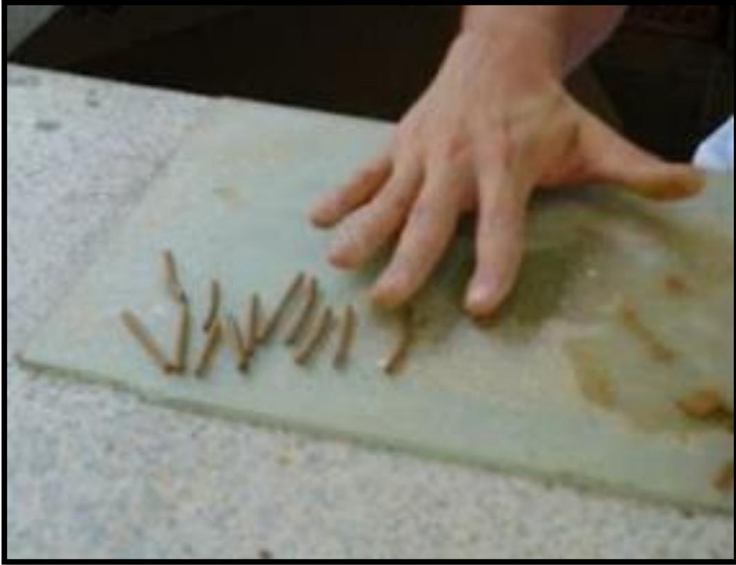
**Figura 4.** Cilindros de tres milímetros de diámetro, ensayo de límite de plástico.
