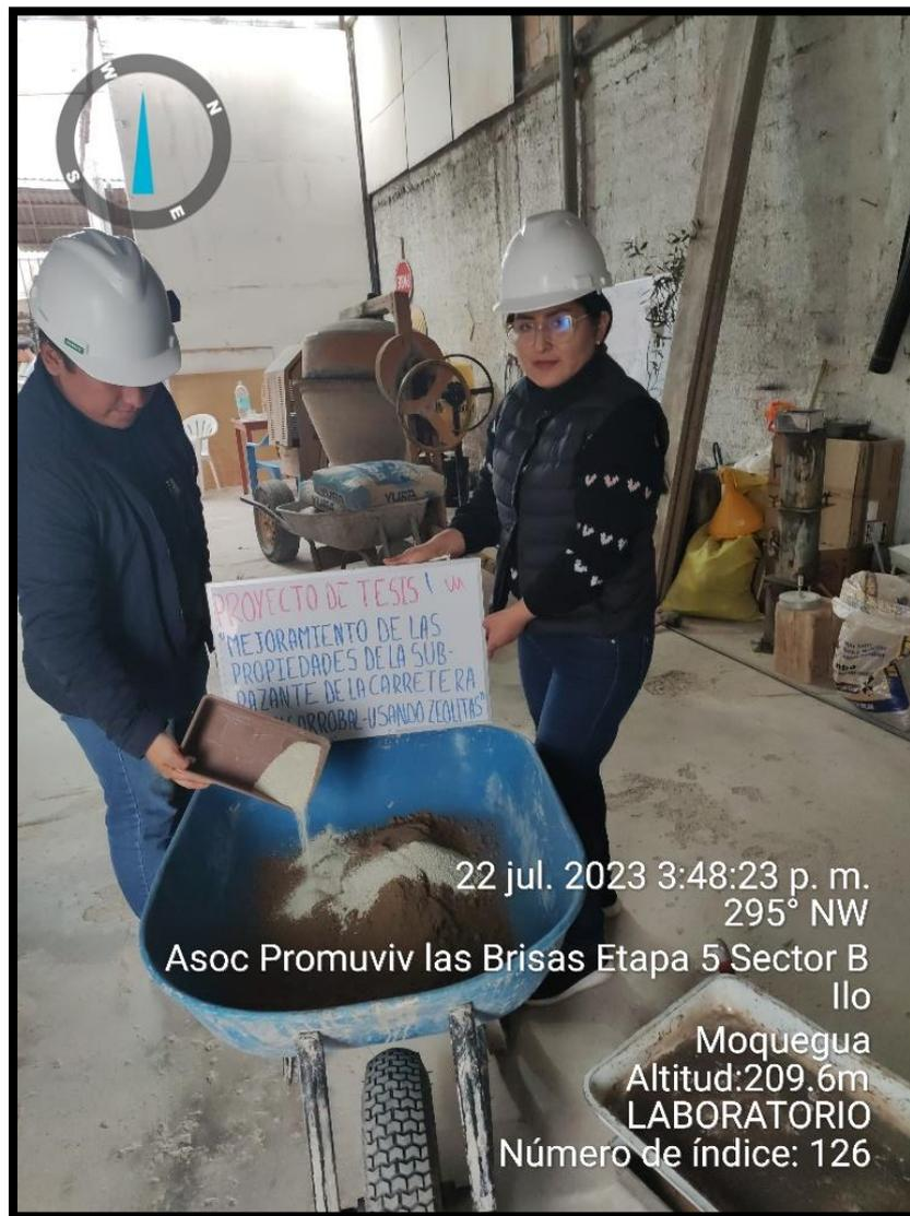
**Figura 26.** Ensayo de Proctor modificado con la dosificación de zeolitas.
