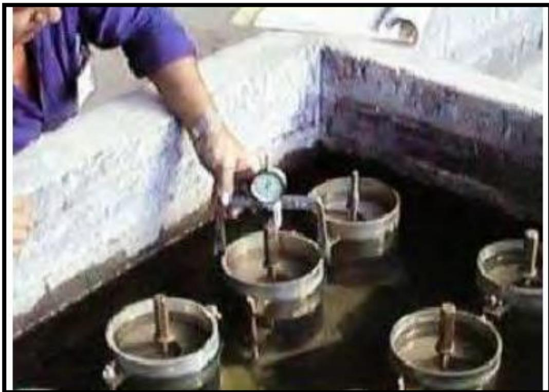
**Figura 5.** Muestras de suelo en condición de inmersión para el CBR
