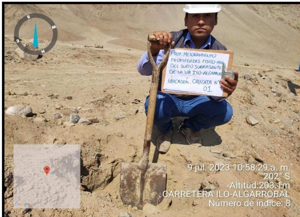
**Figura 10.** Toma de muestra del suelo (Cálicata N°01) Km 1+760
