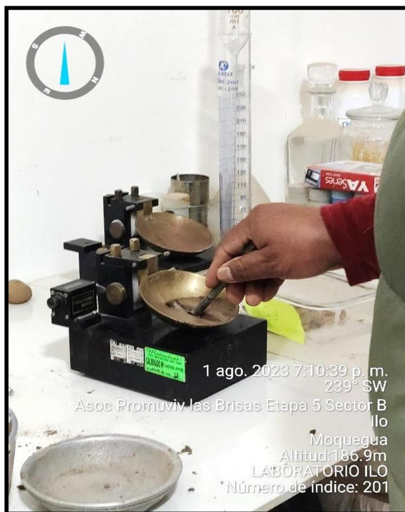
**Figura 17.** Ensayos de Límites de consistencia realizados en el laboratorio.
