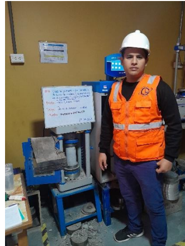
Figura 24. Ensayo resistencia a la compresión P+0.9%FN.
