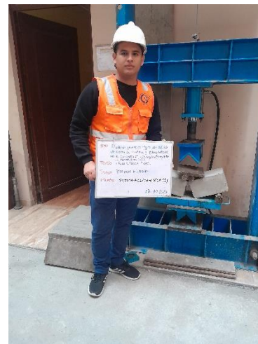
Figura 27. Ensayo resistencia a la flexión P+0.9%FN+6.5%CM.
