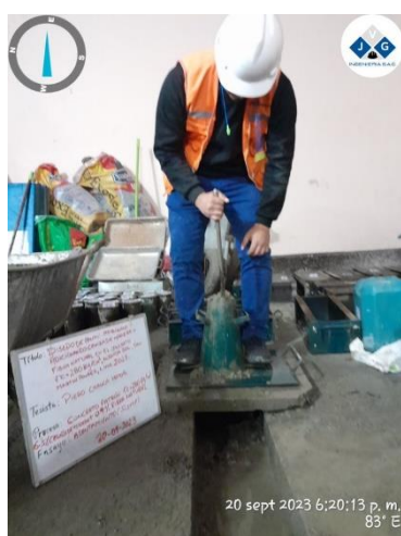
Figura 20. Prueba de Slump.
