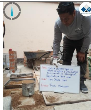
Figura 12: Ensayo de proctor modificado.
