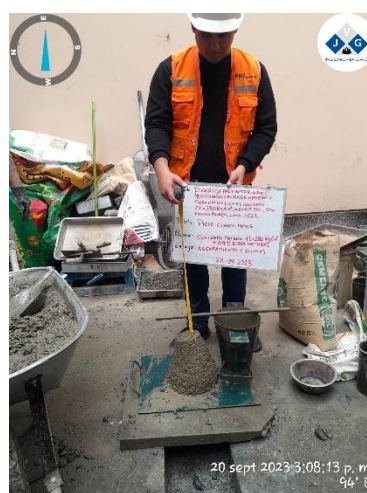
Figura 21. Toma de medida de asentamiento.
