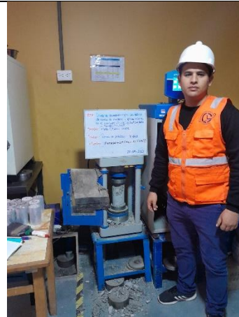
Figura 14: Ensayo de resistencia a la compresión a los 7 días.
