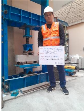
Figura 19: Ensayo de resistencia a la flexión a los 28 días.
