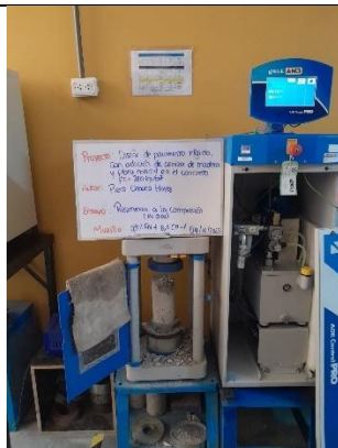
Figura 17: Ensayo de resistencia a la compresión a los 14 días.
