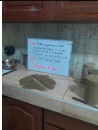
Figura 13: Ensayo de proctor modificado.
