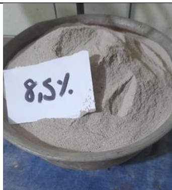
Figura 11: Pesado de la ceniza de madera (dosificación 8.5%).
