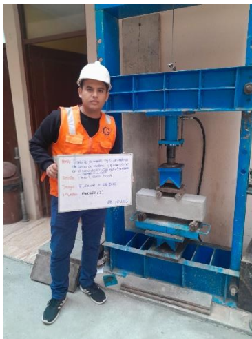
Figura 26. Ensayo resistencia a la flexión muestra patrón.
