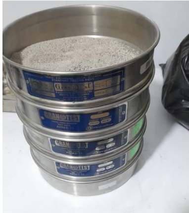
Figura 07: Análisis granulométrico de la ceniza mediante el tamizado.
