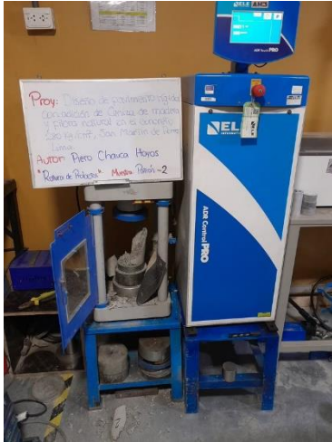
Figura 23. Prueba de resistencia a la compresión muestra patrón.
