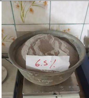
Figura 09: Pesado de la ceniza de madera (dosificación 6.5%).
