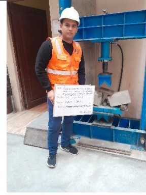
Figura 20: Ensayo de resistencia a la flexión a los 28 días.
