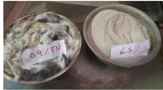
Figura 08: Muestreo de la dosificación de la ceniza de madera y fibra natural
