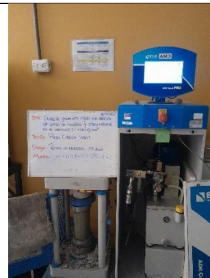
Figura 18: Ensayo de resistencia a la compresión a los 28 días.
