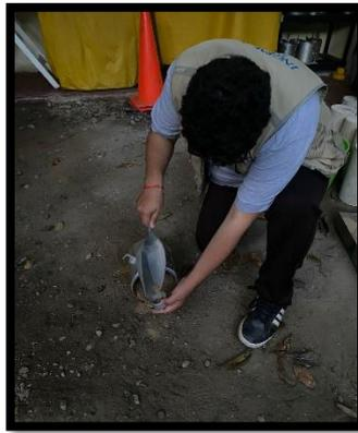
**FOTO 21:** Ensayo de Proctor modificado, se toma una pequeña muestra después de ser compactada para determinar el OCH.
