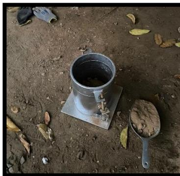
**FOTO 19:** Ensayo de Proctor modificado, se pasa a rellenar el molde cilíndrico de 2.320cm<sup>3</sup> con la muestra que ha pasado por el tamiz 3/4".
