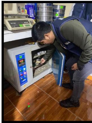
**FOTO 9:** Para el contenido de humedad, después de haber cuarteado nuestra muestra, se lleva al horno por 16 horas.
