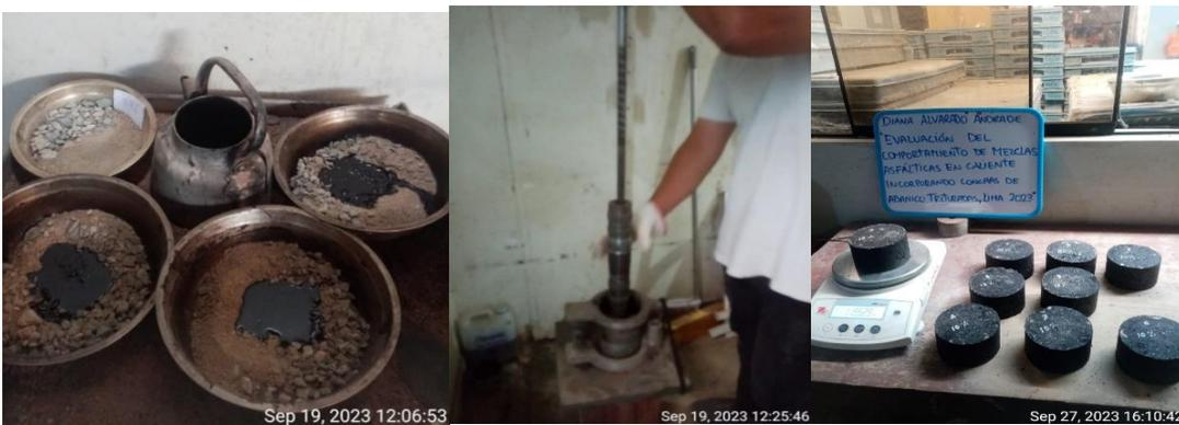
**Fig#39.** Combinación con el %CA óptimo y compactación de Briquetas con CAT
