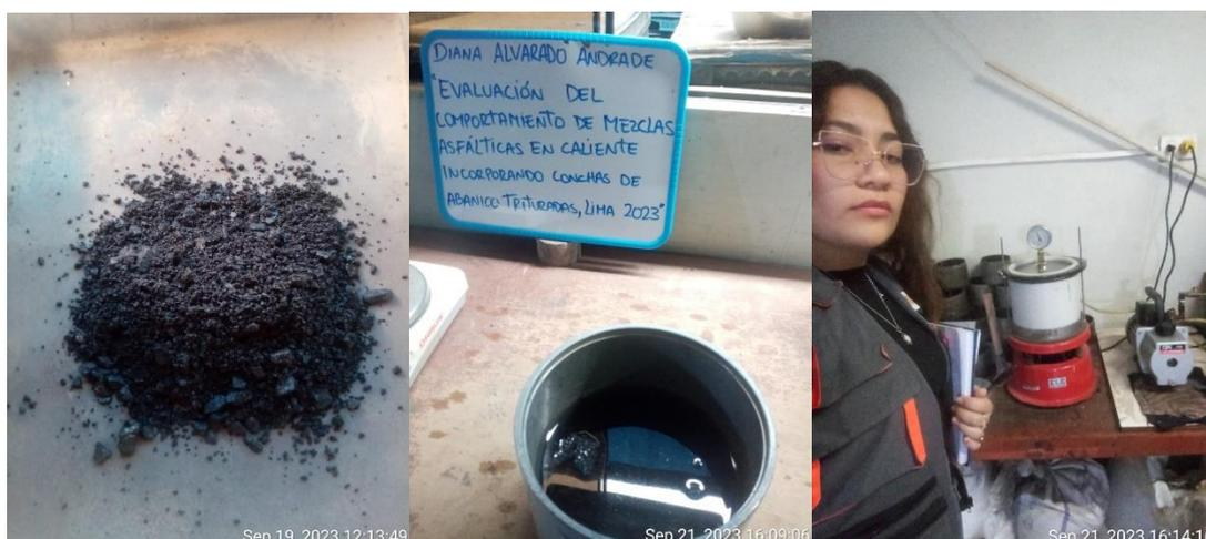
**Fig#27.** Mezcla sin compactar para ensayo Rice
