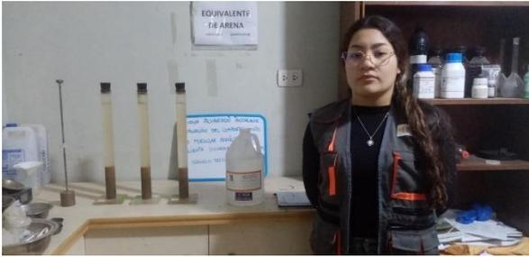
**Fig#15.** Ensayo Equivalente de Arena del AF
