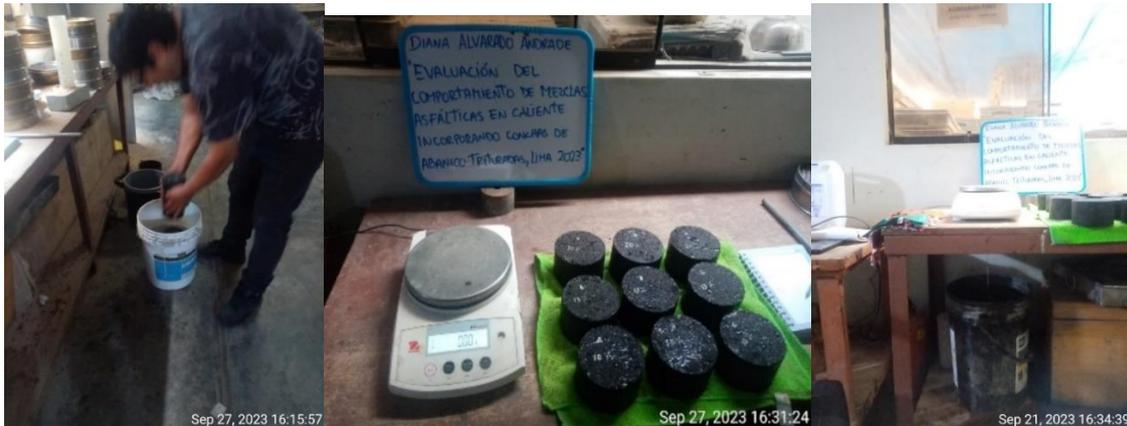
**Fig#40.** Pesos de las Briquetas Compactadas con CAT
