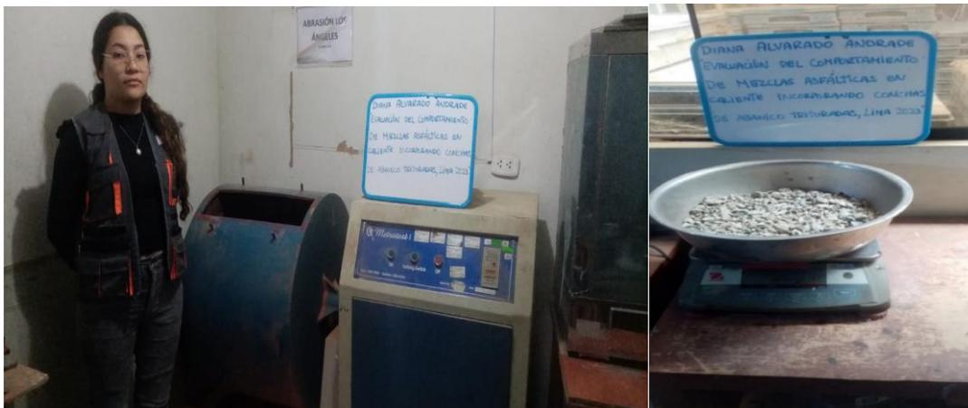
**Fig#7.** Ensayo Abrasión los Ángeles del AG
