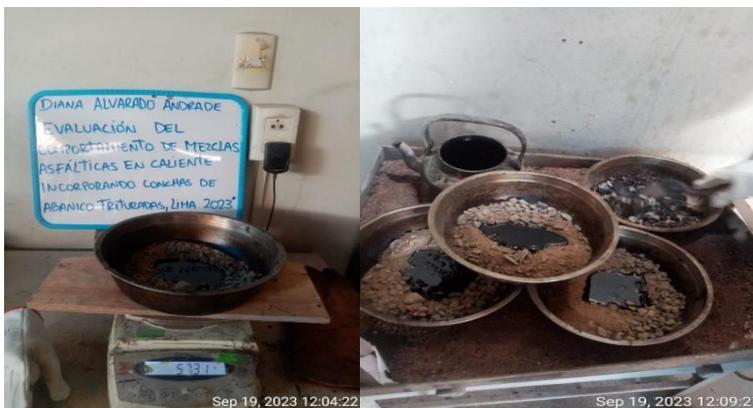
**Fig#23.** Combinación de agregados con %Asfalto
