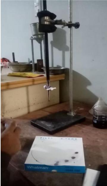
**Fig#19.** Ensayo Azul de Metileno del AF
