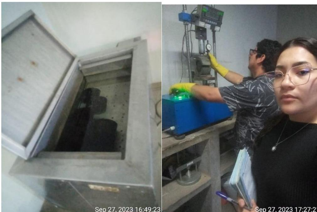
**Fig#41.** Ensayo en Prensa Marshall
