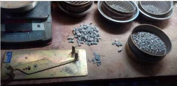
**Fig#11.** Ensayo Partículas Chatas y Alargadas del AG
