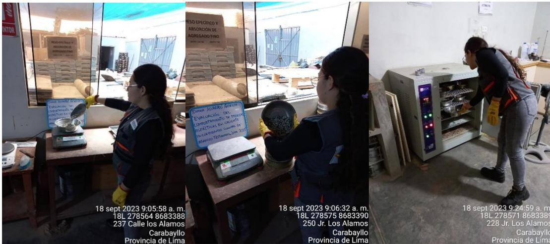
**Fig#6.** Ensayo Gravedad Específica y Absorción del AG
