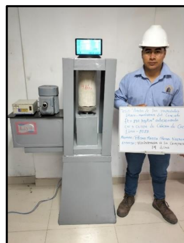
Figura 38. Ensayo a compresión a los 14 días
