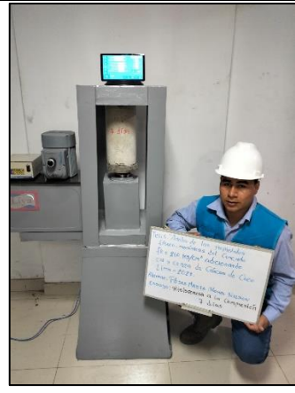
Foto 16. Ruptura de probetas a compresión a los 7 días
