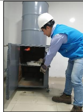
Foto 08. Introducción de la cáscara de coco al horno
