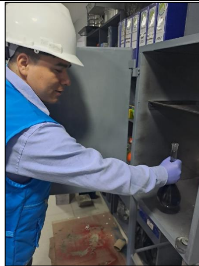
Foto 10. Introducción de la fiola con ceniza de cáscara de coco al horno
