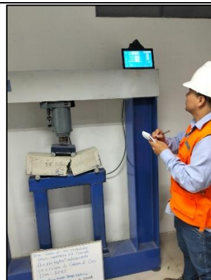
Foto 18. Ruptura de vigueta a los 28 días de curado
