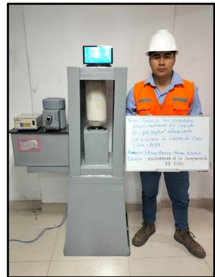
Figura 41. Ensayo a compresión a los 28 días
