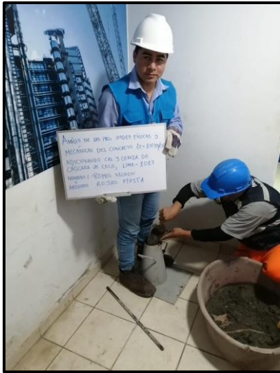
Figura 25. Llenado del cono de Abrams
