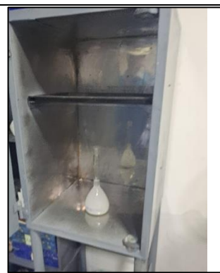
Foto 12. Introducción de la fiola con la cal al horno
