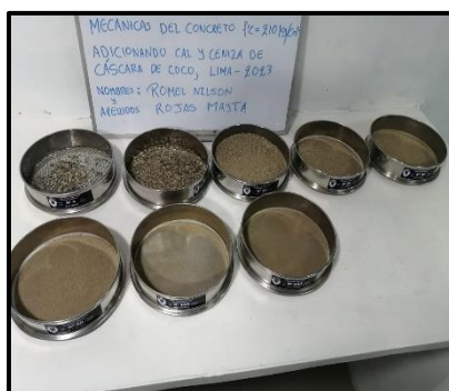
Figura 11. Tamizado del agregado fino
