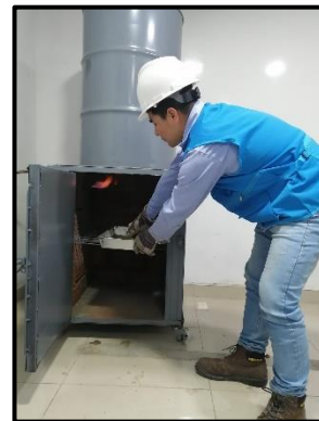
Figura 6. Calcinación de cáscara de coco
