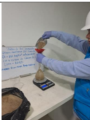
Foto 11. Peso específico del agregado fino
