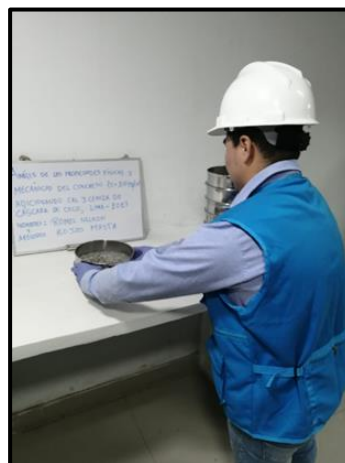
Figura 15. Tamizado de agregado grueso
