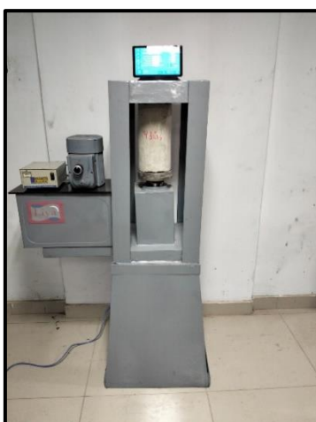
Figura 37. Preparación para el ensayo a compresión
