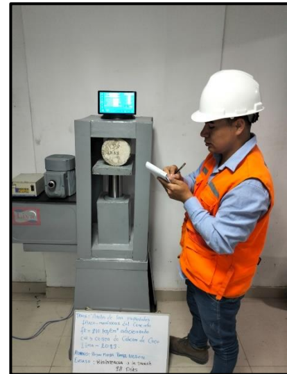
Figura 44. Ensayo a tracción a los 28 días
