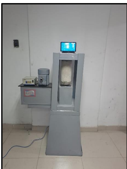
Figura 34. Preparación para el ensayo a compresión
