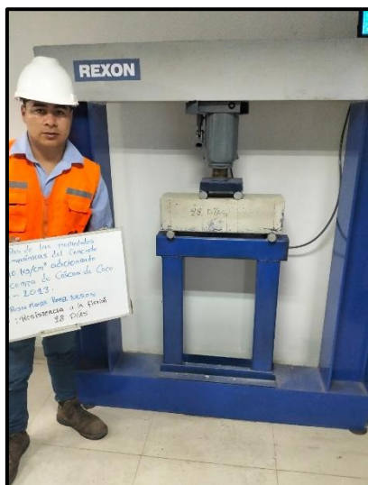
Figura 46. Preparación para el ensayo a flexión
