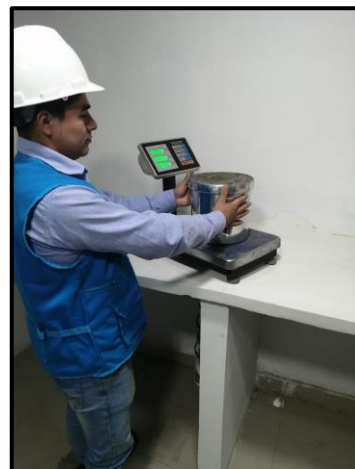
Figura 29. Peso del recipiente más el concreto fresco
