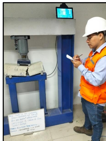
Figura 47. Ensayo a flexión a los 28 días
