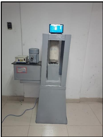
Figura 40. Preparación para el ensayo a compresión
