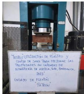
Figura 5. Máquina a flexión para ladrillos
