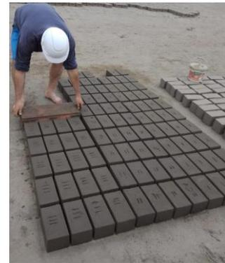
Figura 34. Unidades de albañilería elaboradas y secado a cielo abierto
