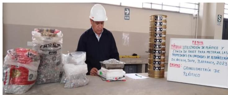
Figura 15. Pesado del plástico para el tamizado
