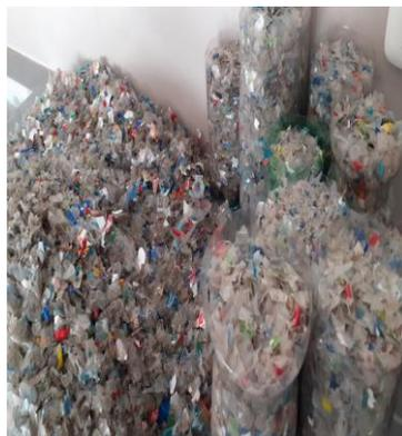
Figura 13. Secado del plástico y retirado de los etiquetados
