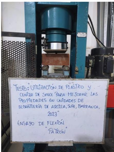
Figura 42. Ensayo a flexión
