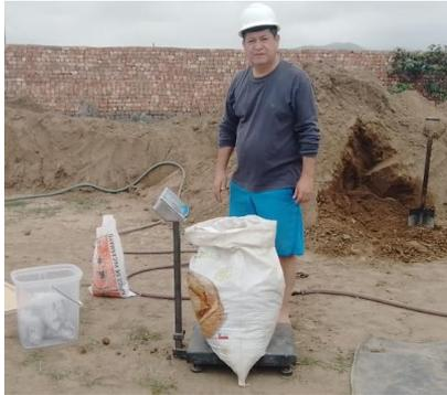
*Figura 27.* Pesado del suelo con presencia de arcilla
