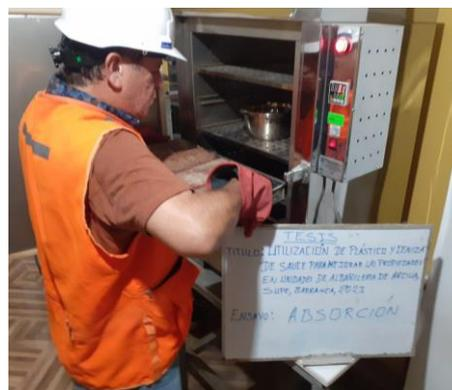
Figura 46. Posicionamiento de los ladrillos en el horno
