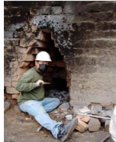
*Figura 18. Retiro de ceniza de sauce del interior del horno*
