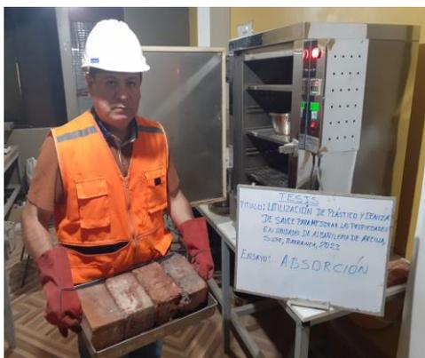
Figura 45. Secado de las cuatro muestras de ladrillo
