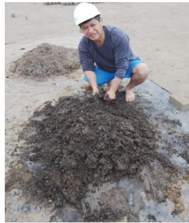
*Figura 30.* Mezclado del suelo, agua, plástico y ceniza de sauce
