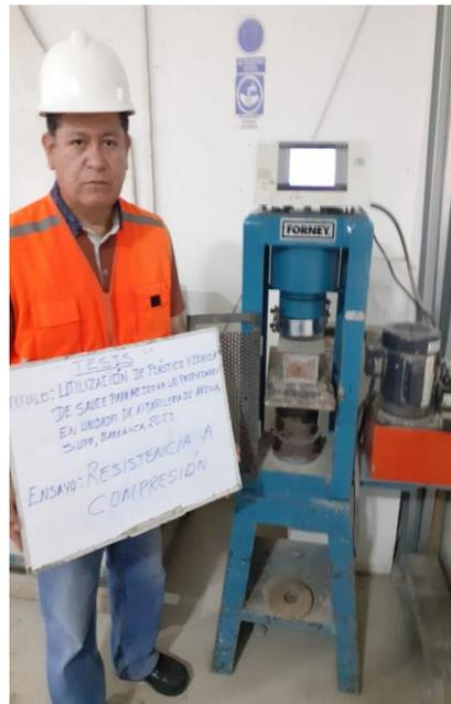
*Figura 39.* Posicionamiento del espécimen tipo II en la máquina compresión hidráulica *Figura 40.* Medición a la resistencia a
