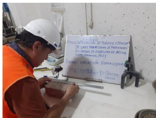
Figura 49. Dimensionamiento de la muestra de tipo IV
