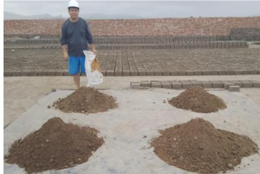
*Figura 28.* Pesado del suelo para el patrón y muestras
