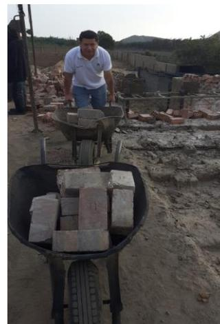
Figura 36. Ladrillos cocidos retirados del horno
