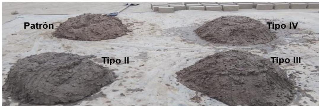
Figura 31. Mezcla preparada Patrón, Tipo II, Tipo III y Tipo IV
