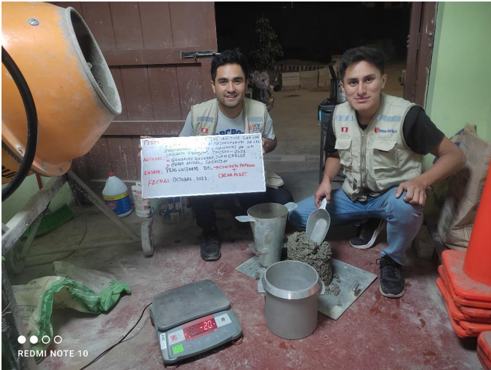
Figura 22 Fabricación de probetas cilíndricas 10 cm x 20 cm
