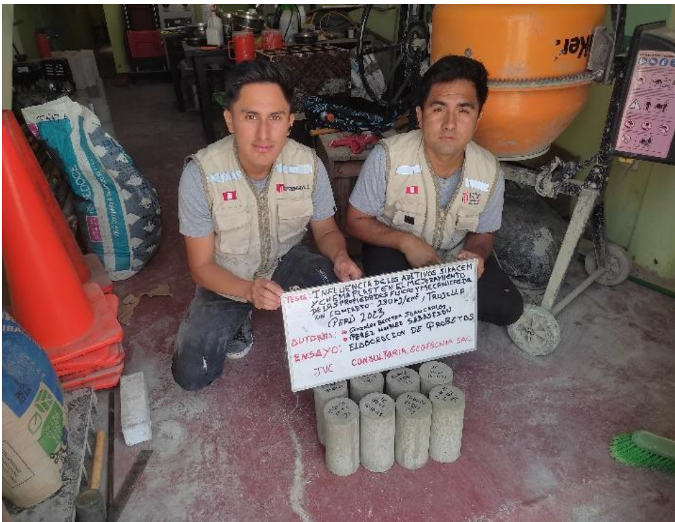
Figura 22 Fabricación de probetas cilíndricas 10 cm x 20 cm
