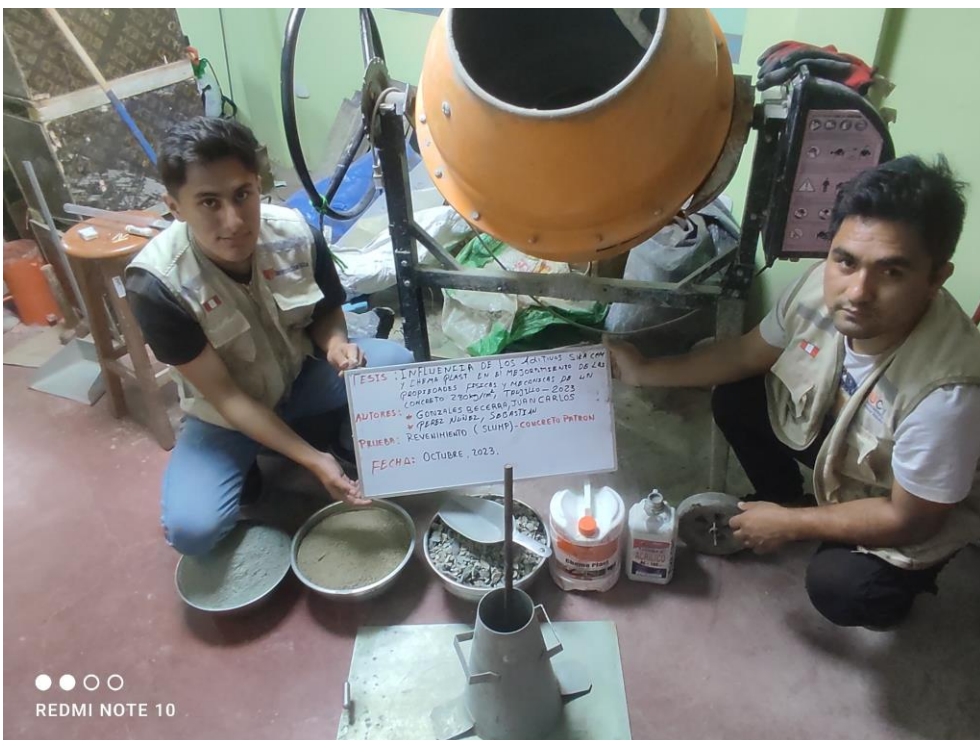
Figura 14 Prueba de cono de Abrams para establecer la consistencia SLUMP
