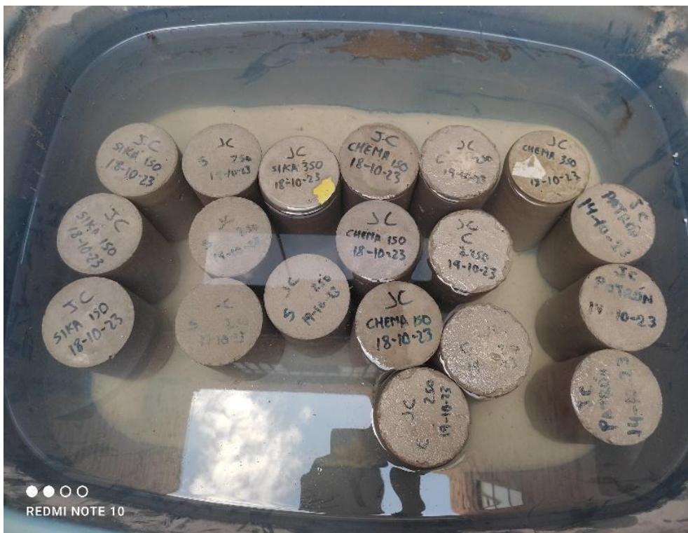
Figura 26 El curado de las probetas durante 7, 14 y 28 días
