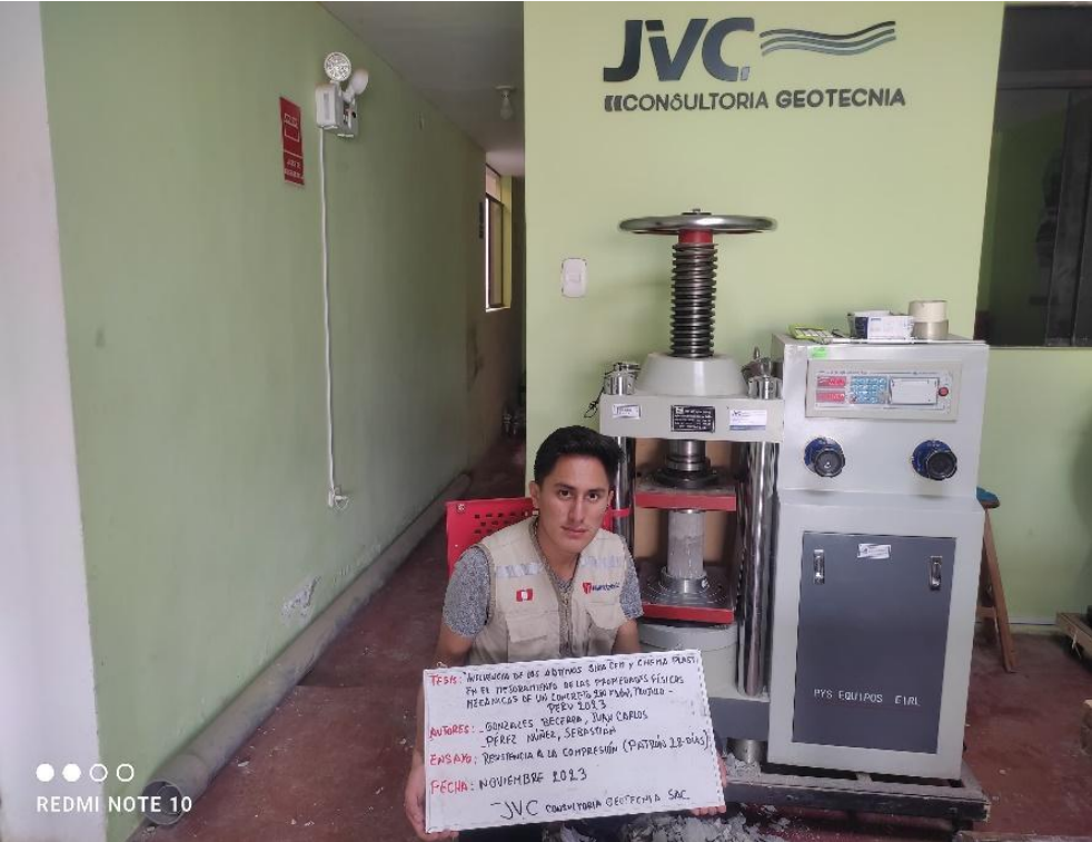
Figura 29 Resistencia a compresión de concreto patrón + Chema Plast durante 7, 14 y 28 días
