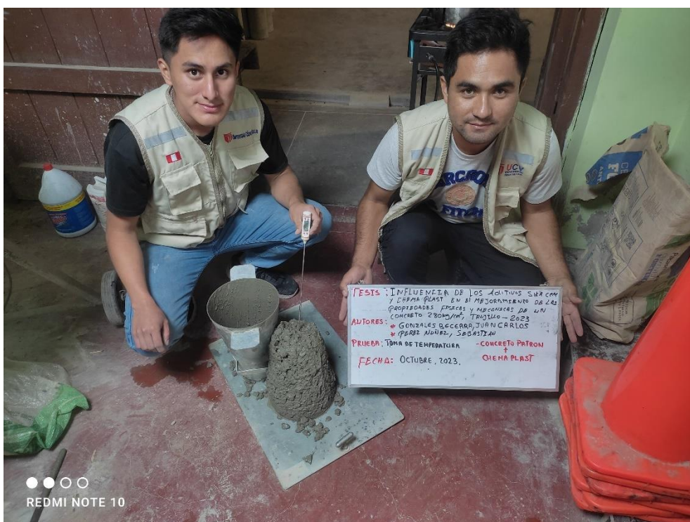
Figura 18 Ensayo de temperatura de concreto incorporado con aditivo Chema Plast
