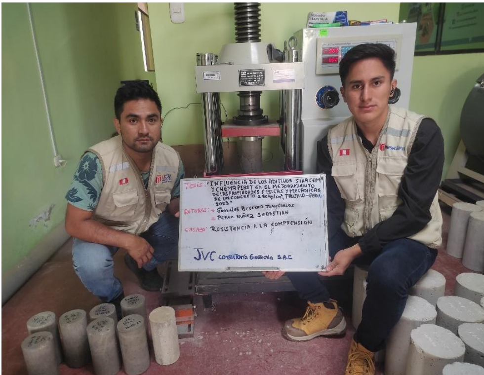
Figura 27 Resistencia a compresión de concreto patrón evaluada durante 7,14 y 28 días
