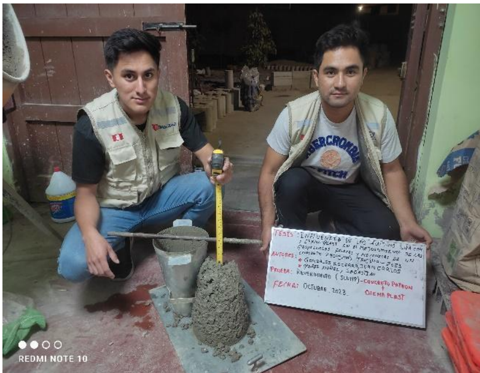
Figura 16 Prueba de SLUMP con aditivo Chema Plast
