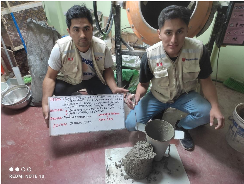
Figura 18 Ensayo de temperatura de concreto incorporado con aditivo Chema Plast
