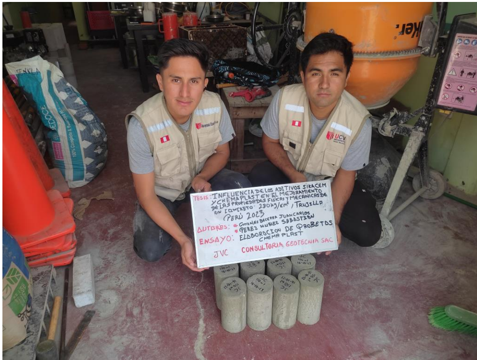
Figura 26 El curado de las probetas durante 7, 14 y 28 días
