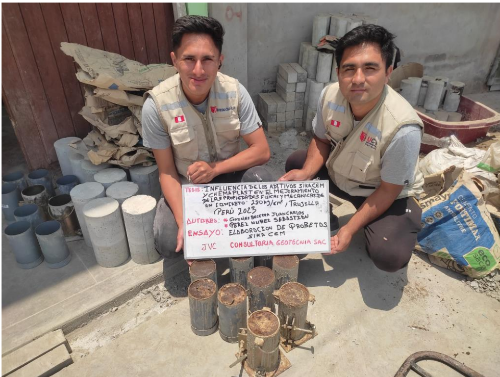
Figura 24 Elaboración de probetas de concreto patrón + Sika Cem durante 7, 14 y 28 días
