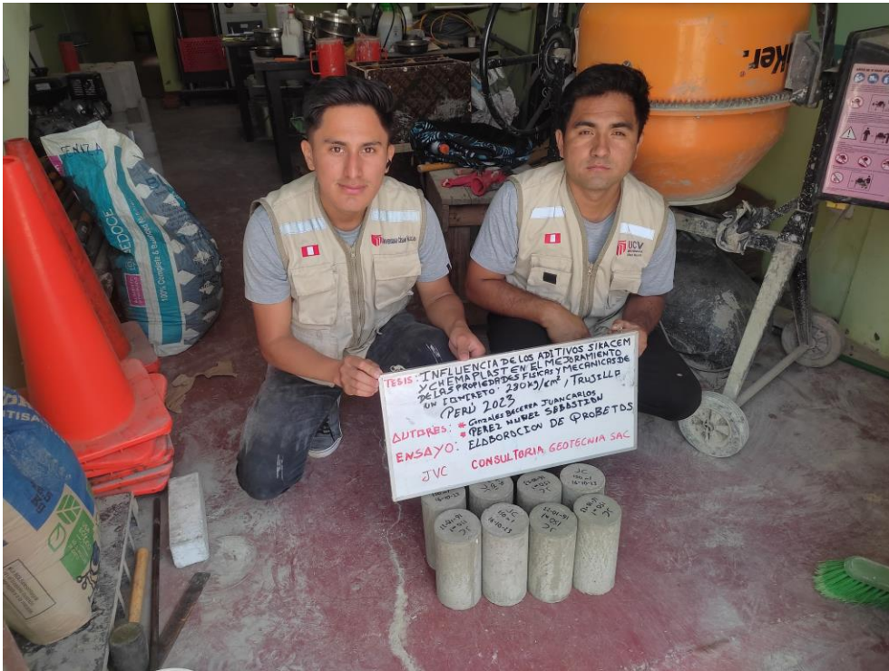
Figura 24 Elaboración de probetas de concreto patrón + Sika Cem durante 7, 14 y 28 días
