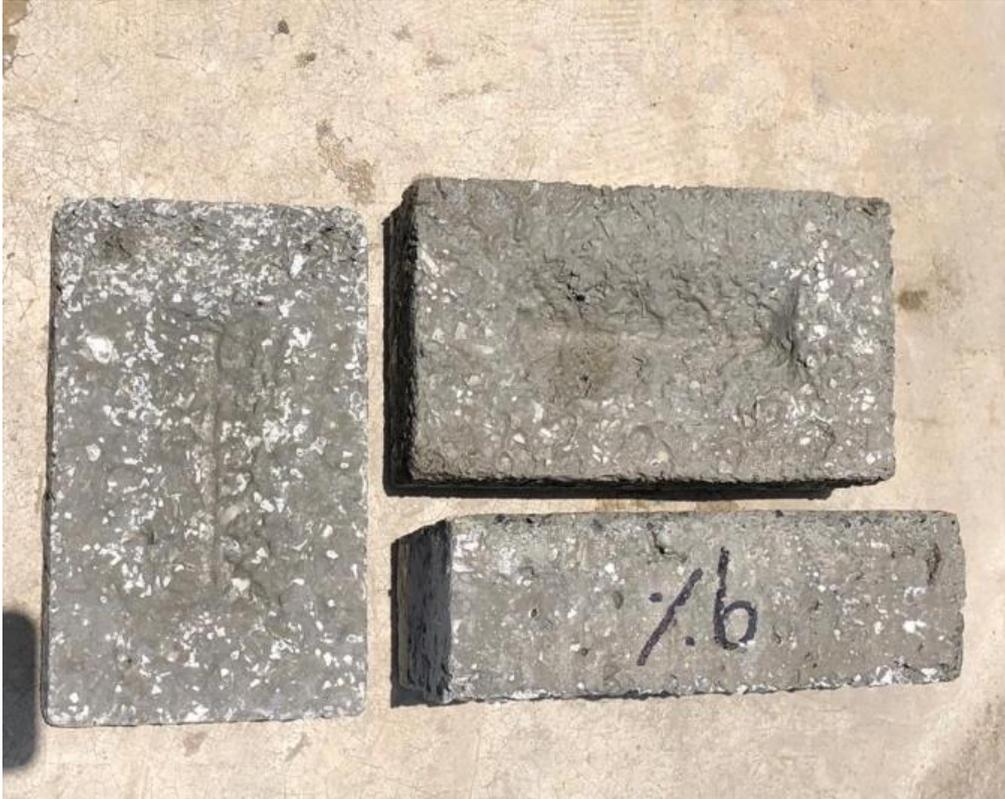
**Imagen 10: Secado de ladrillo con adición del 12 % de plástico PET y vidrio molido**
