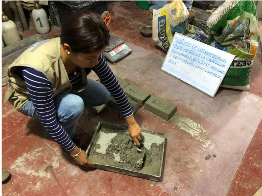
**Imagen 4:** Ladrillos con adición del 12% de plástico PET y vidrio molido
