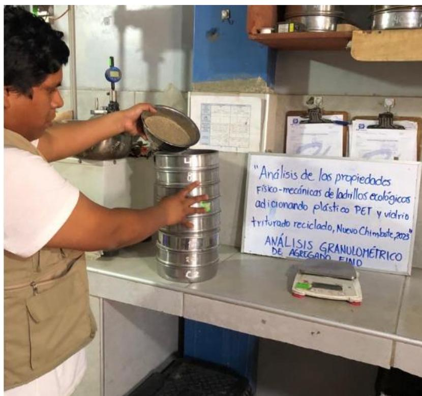
**Imagen 13: Análisis granulométrico de agregado grueso**
