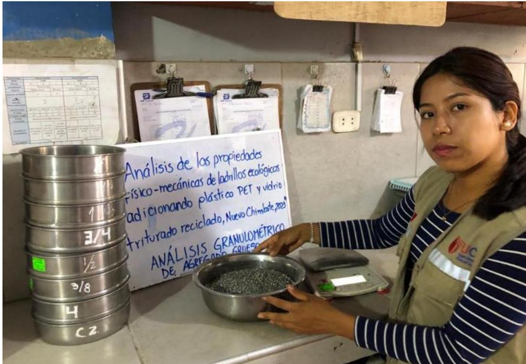
**Imagen 14: Ensayo de peso unitario y vacío de agregado grueso**
