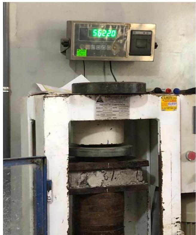
**Imagen 9: Ladrillo con adición del 9 % de plástico PET y vidrio molido**
