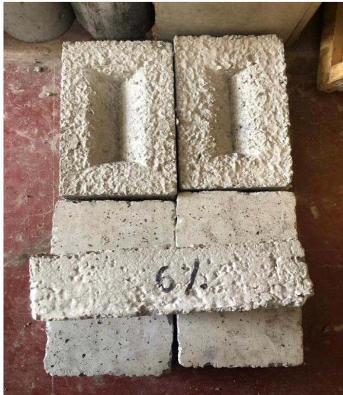
Imagen 7: Rotura de ladrillo patrón  $f'_c=175 \text{ kg/cm}^2$  a los 28 días
