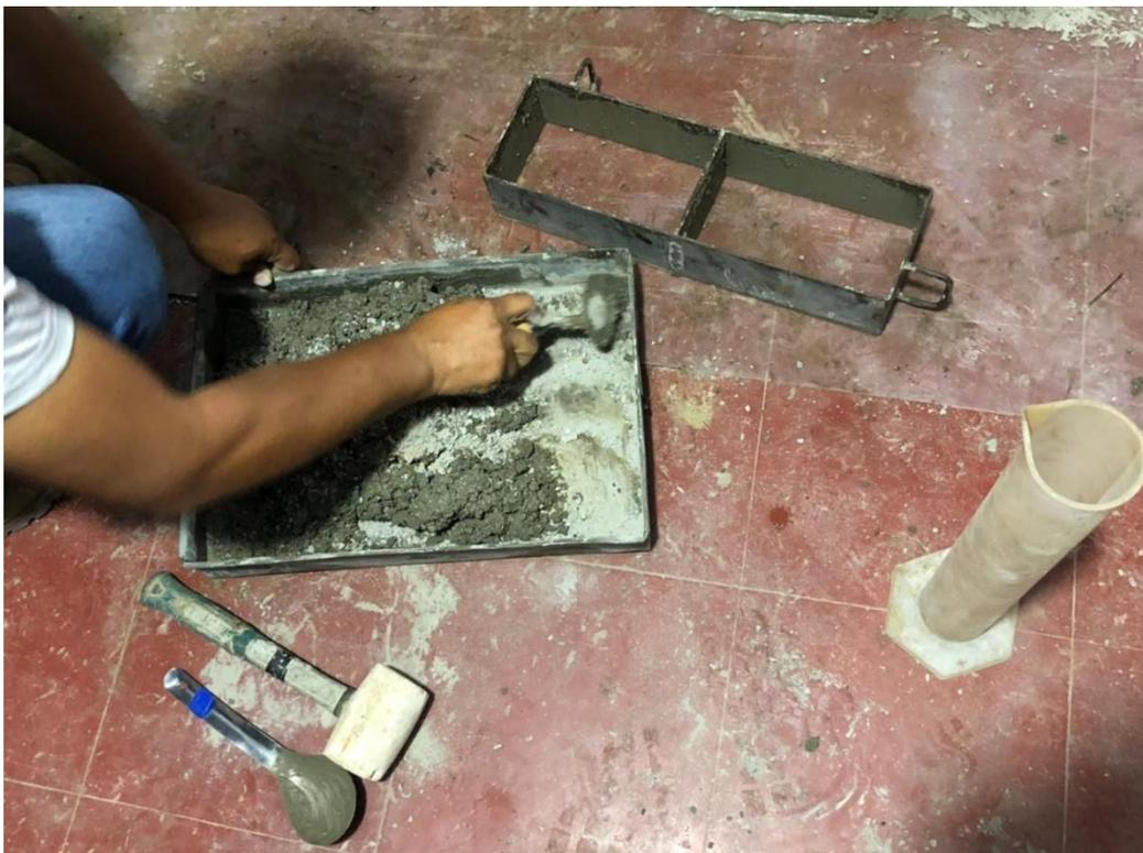
**Imagen 3:** Estudiante moldeando ladrillos en el laboratorio.
