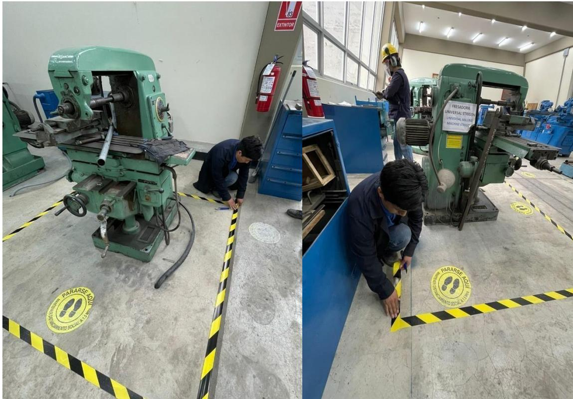
Figura 46. Enmarcación con cintas de seguridad
