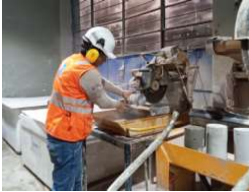
Corte de las probetas
