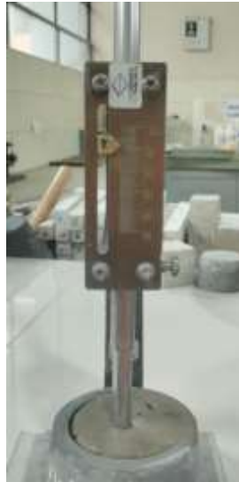
Medición de la penetración de la aguja de Vicat
