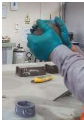
Proceso de elaboración del espécimen para el ensayo de tiempo de fraguado
