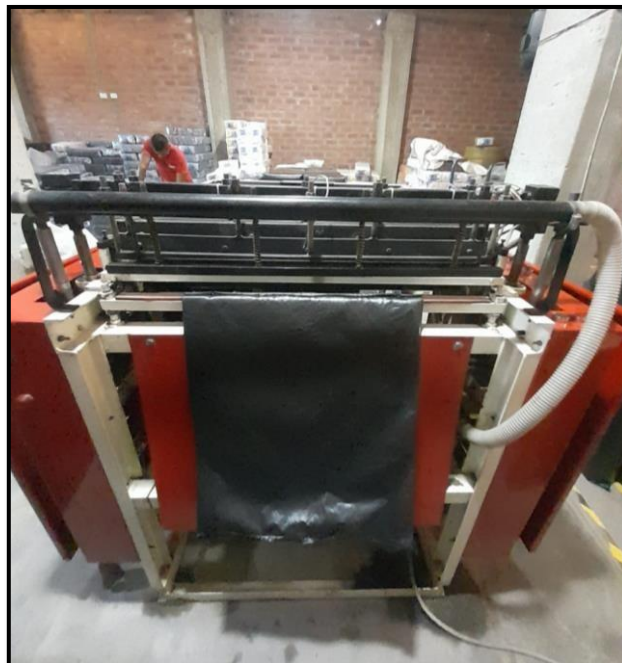
Figura 14. Máquina de sello fondo para la medida de 20 x 30 (Tubería de aire mal posicionada)
