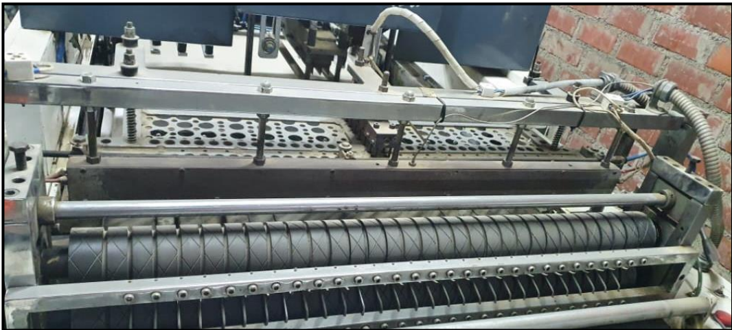
Figura 19. Cuchillas desgastadas y cables maltratados por la temperatura
