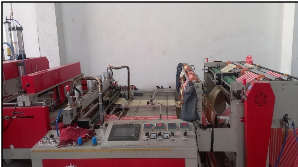
Figura 16. Máquina de sello lateral con troquel incorporado (Cables expuestos y Jebes desgastados)
