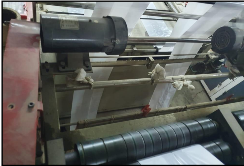
Figura 20. Rodillos desgastados y provocación de ruidos
