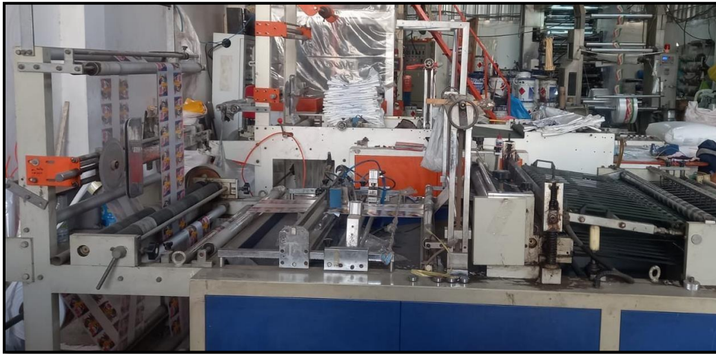
Figura 15. Máquina de sello lateral de envases plásticos (Falta de Engrasado)
