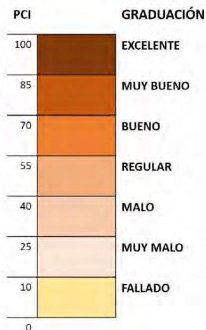
Figura 14. Rango de condiciones del pavimento.
