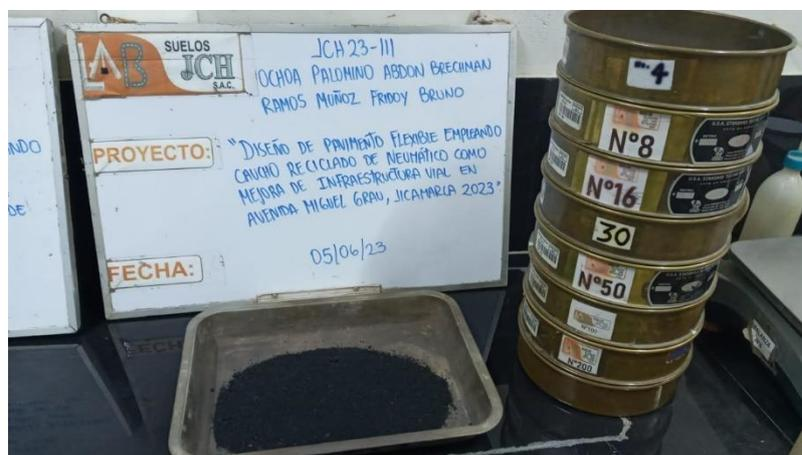
Figura 25. Granulometría del polvo de caucho.
