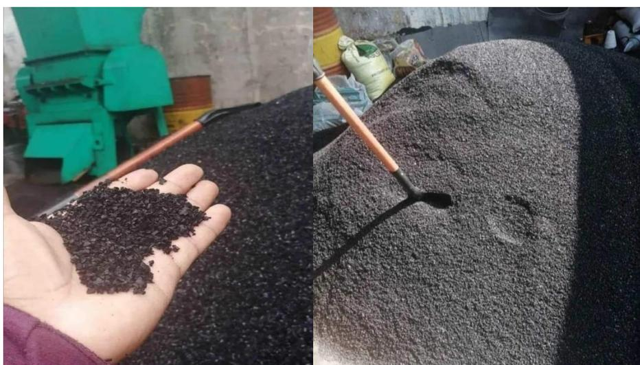
Figura 22. Obtención del polvo de caucho.
