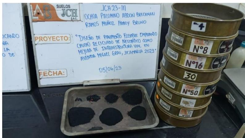
Figura 26. Granulometría del polvo de caucho.
