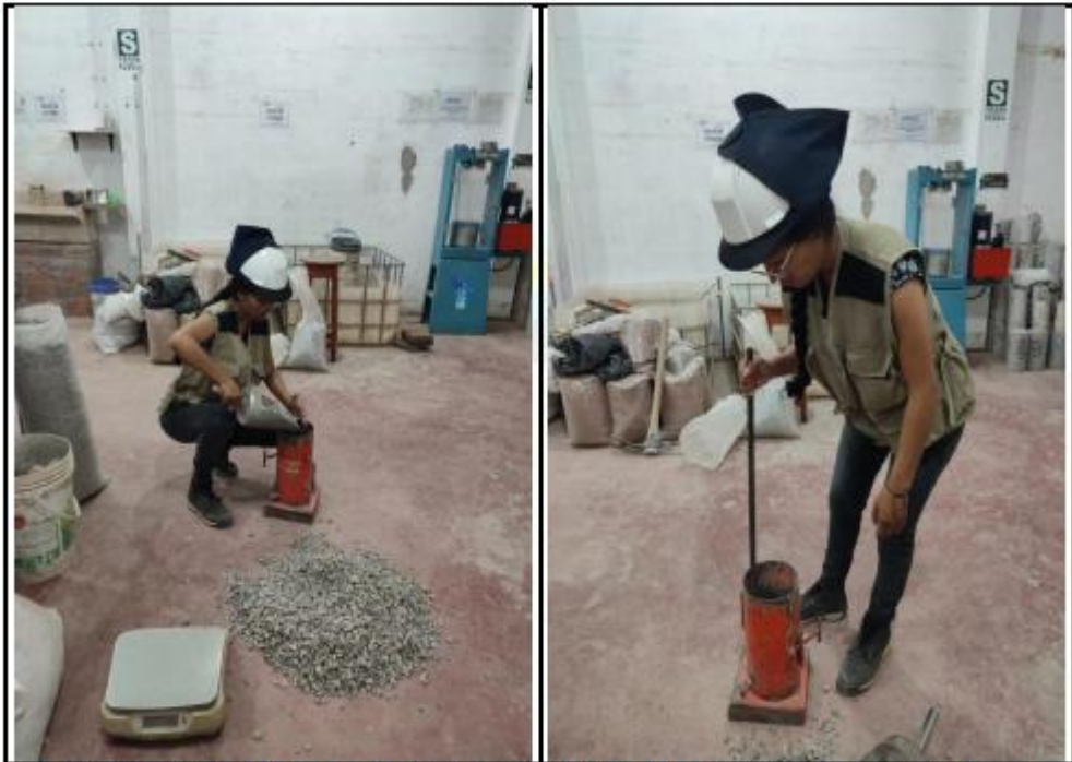
Fotos nº 13-14: En las imágenes podemos observar realización del ensayo de peso unitario de la grava.
