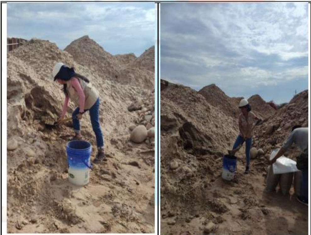
Fotos nº 03-04: En las imágenes se puede apreciar el muestreo de la arena zarandeada.
