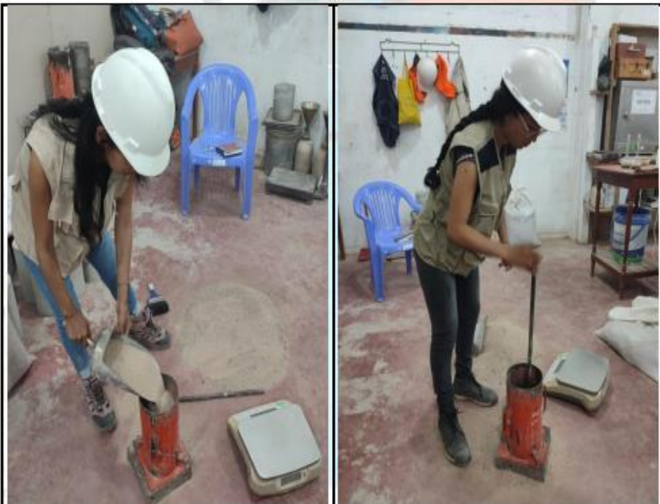
Fotos n° 11-12: En las imágenes podemos observar realización del ensayo de peso unitario de la arena zarandeada.
