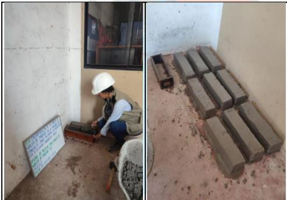
Fotos nº 23-24: En las imágenes podemos observar el moldeo de los bloques de concreto.
