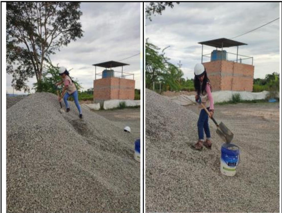
Fotos nº 01-02: En las imágenes se puede apreciar el muestreo de la grava chancada.
