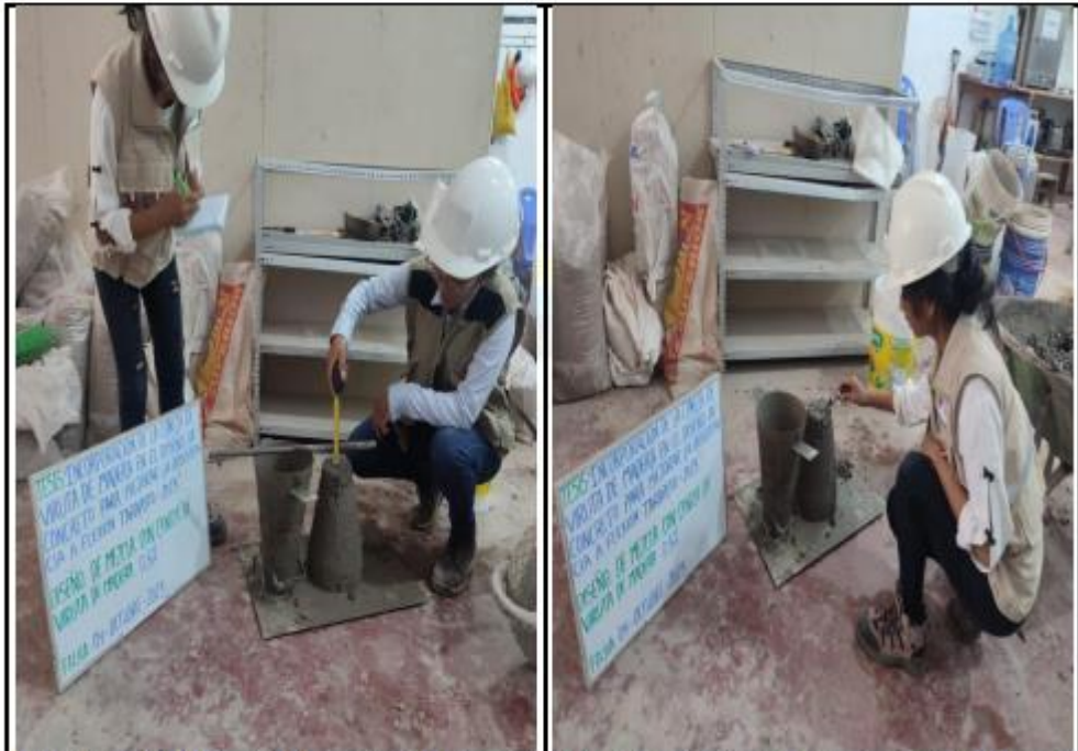
Fotos nº 21-22: En las imágenes podemos observar al personal realizando la prueba de asentamiento para los diseños de Mezclas.
