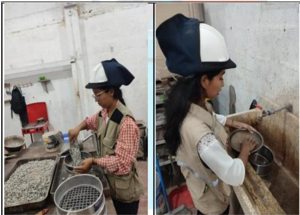
Fotos nº 07-08: En las imágenes se puede apreciar el ensayo de análisis granulométricos y lavado de agregado fino.
