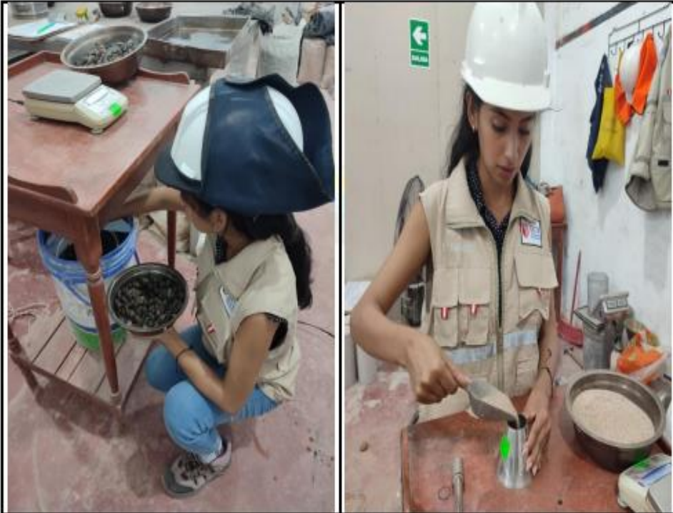
Fotos n° 09-10: En las imágenes podemos observar el ensayo de gravedad específica de los agregados.
