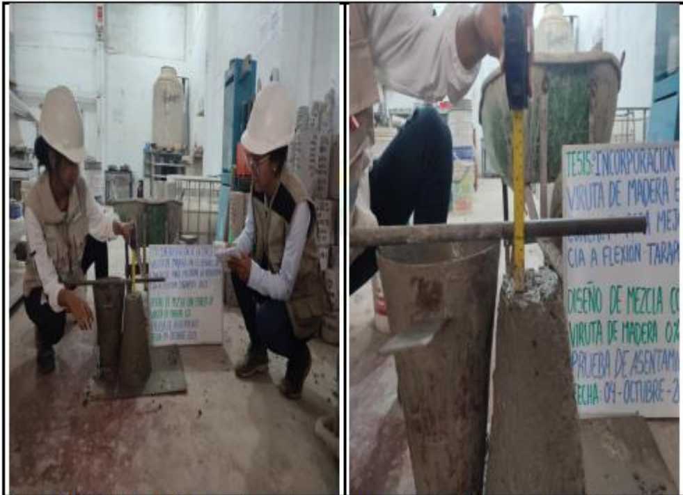
Fotos nº 17-18: En las imágenes podemos observar al personal realizando la prueba de asentamiento para los diseños de Mezclas.
