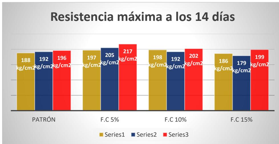
Figura 17. Resistencia a la compresión a los 14 días
