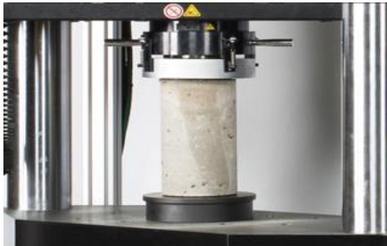
Figura 4: Ensayo de la Resistencia a la compresión.
