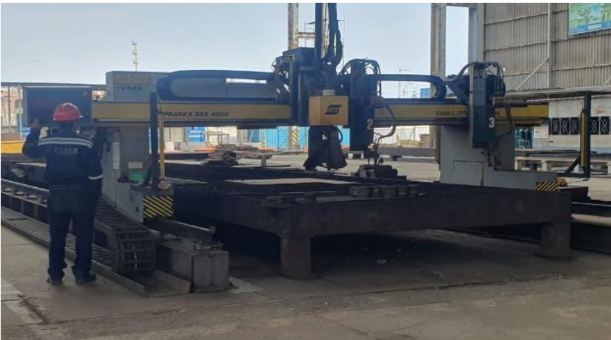
Figura 8. Evaluación en campo de corte de planchas metálicas del área de habilitado
