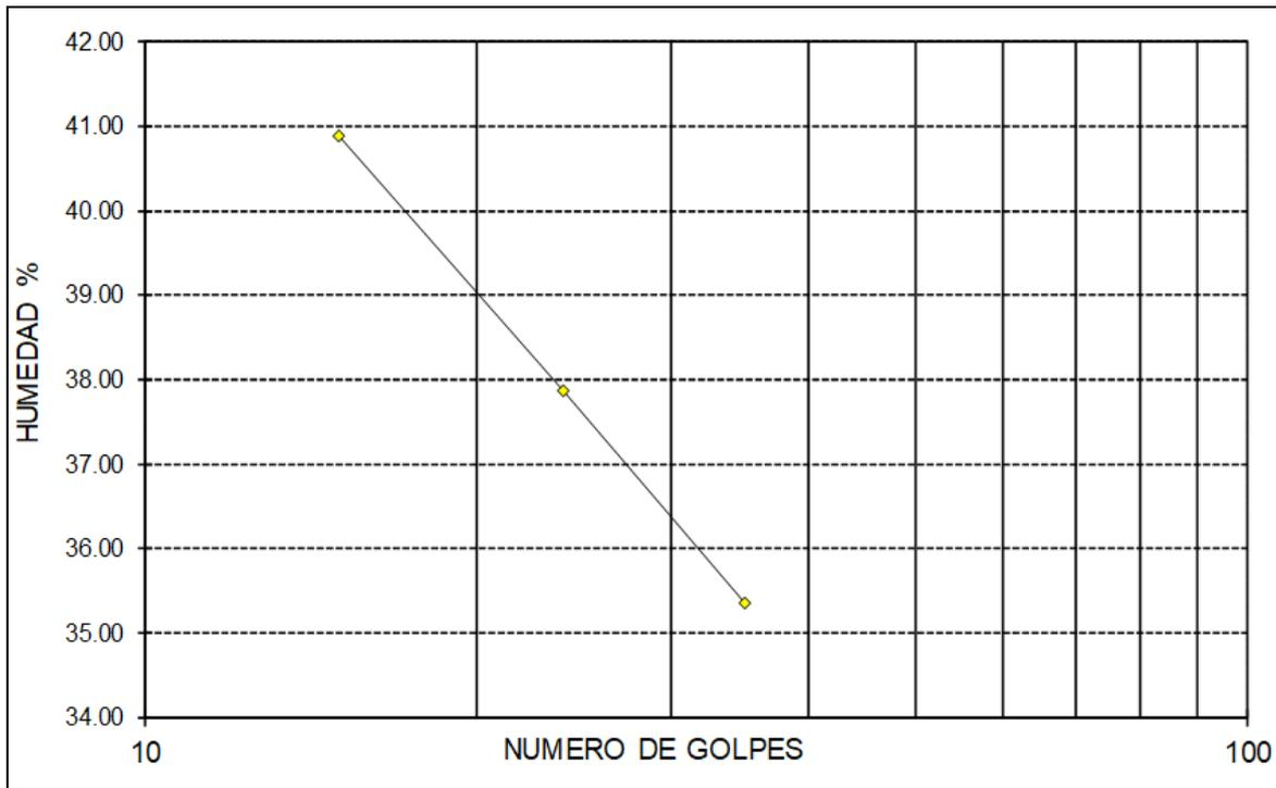
**Figura 7.** Límite de Atterberg muestra C – 02 (subrasante modelo) – Desvío del Caserío Cumbicus, distrito de Pacaipampa, Ayabaca. Fuente: E.M.S.
