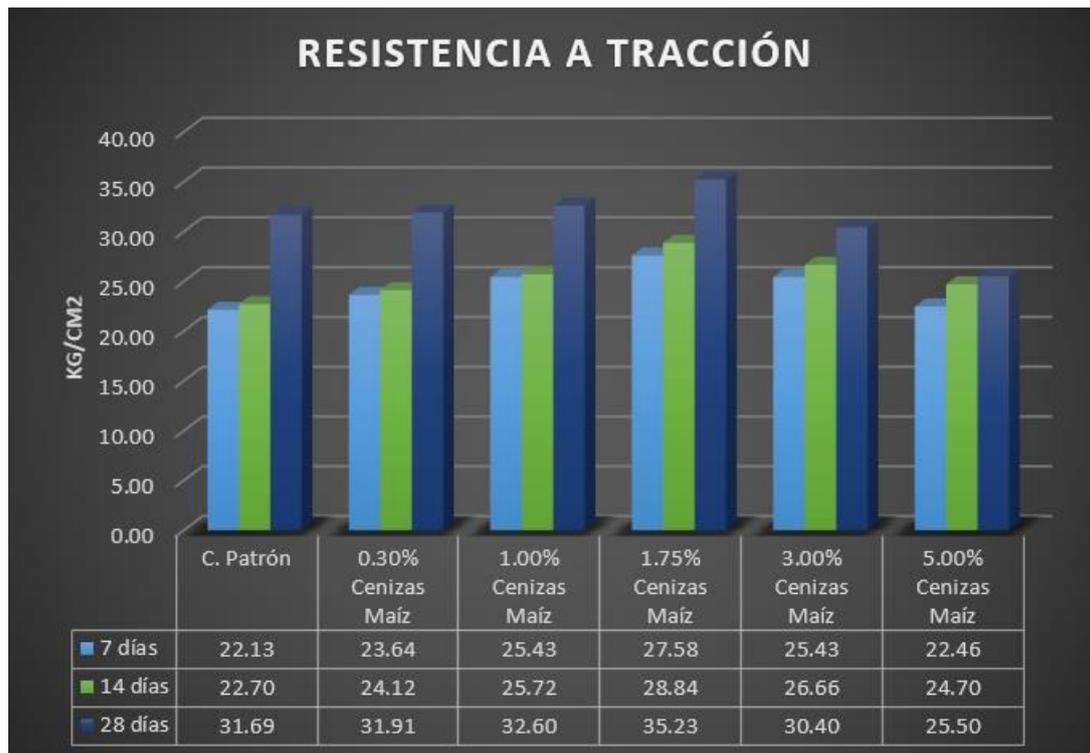
Figura 40. Resumen de resultados, resistencia a tracción de concreto patrón y con adición de cenizas en 7, 14 y 28 días
