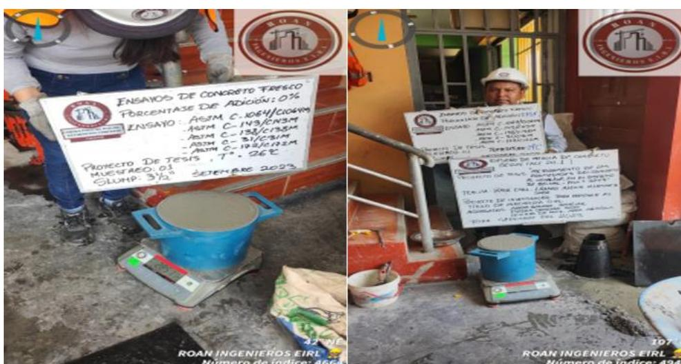
Figura 29. Peso Unitario de concreto; muestra patrón y con adición de cenizas
