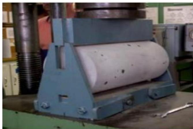
Figura 5. Muestra para hallar Resistencia a tracción.
