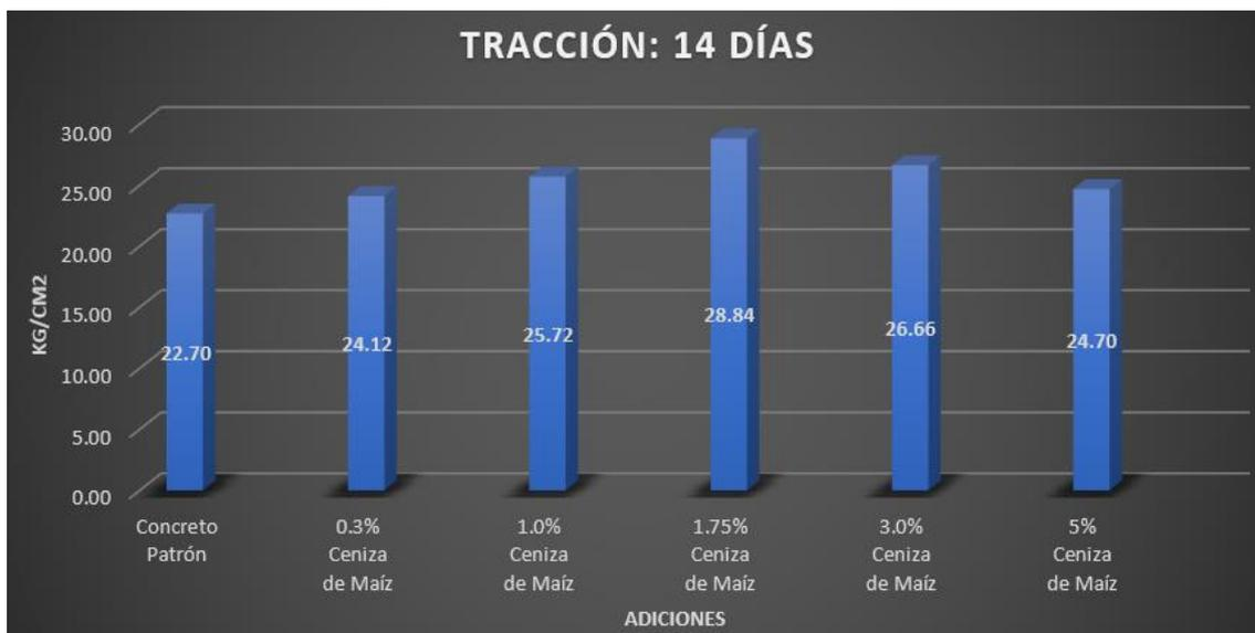
Figura 38. Resultados, resistencia a tracción de muestra patrón y con adición de cenizas en 14 días
