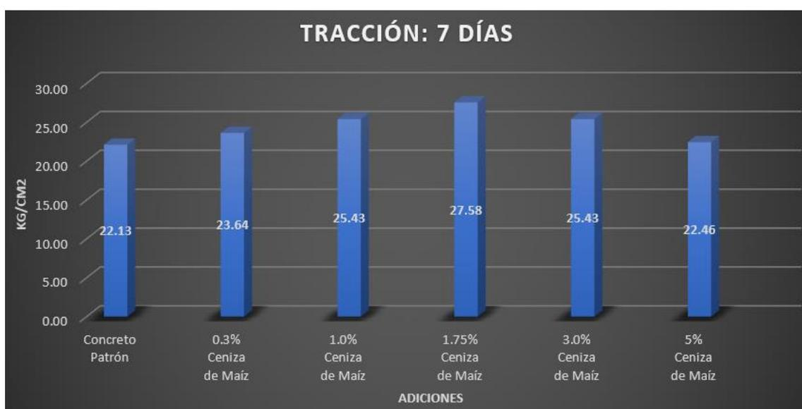
**Figura 37.** Resultados, resistencia a compresión de muestra patrón y con adición de cenizas en 7 días
