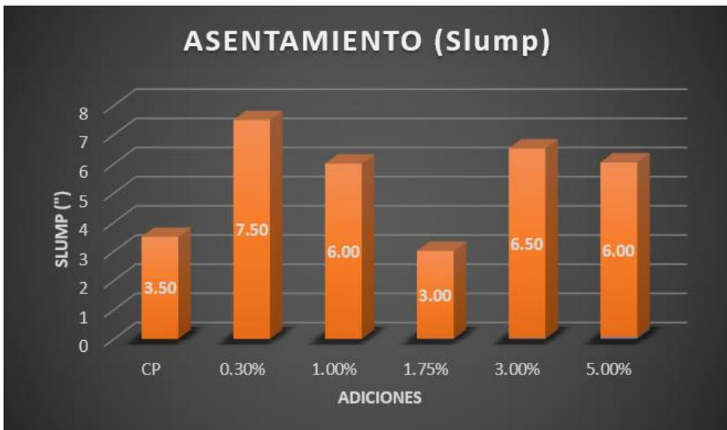
Figura 32. Resultados de asentamiento (slump) de concreto; muestra patrón y con adición de cenizas
