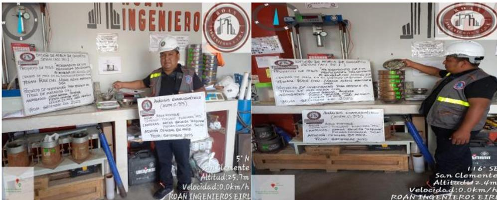
Figura 20. Tamices de granulometría para agregado grueso
