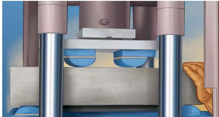
Figura 6. Muestra para la Resistencia a flexión.
