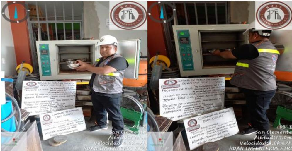
Figura 22. Secado de muestras para obtener CH, agregados de ambas canteras.
