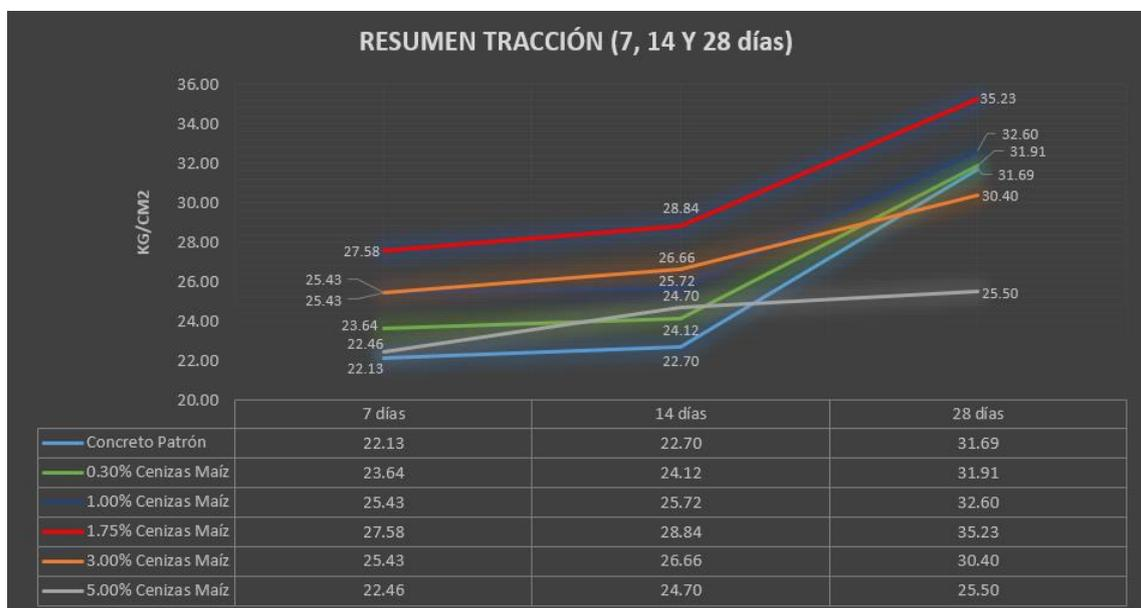
*Figura 43.* Influencia de las cenizas de maíz en su resistencia a la tracción de muestra patrón y con adición de cenizas en 7, 14 y 28 días
