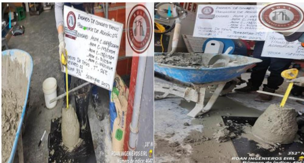
Figura 31. Asentamiento (slump) de concreto; muestra patrón y con adición de cenizas
