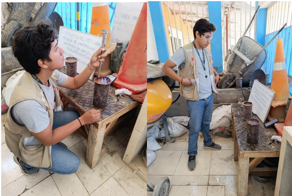
FOTO 30: ENSAYO DE IMPERMEABILIDAD DEL DISEÑO CON EL 5 Y 7% DE PET – 28 DÍAS
