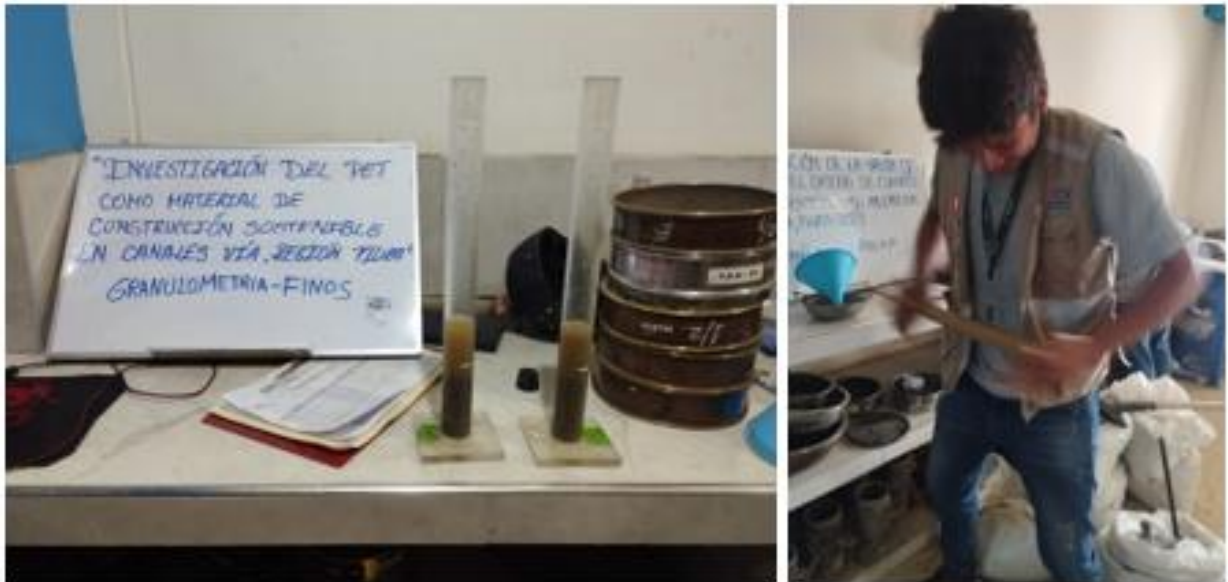
FOTO 8: ENSAYO DE EQUIVALENTE DE FINOS
