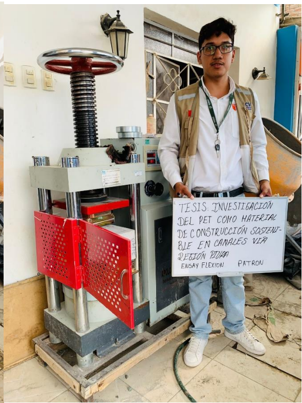
FOTO 31: ENSAYO DE FLEXIÓN DISEÑO PATRON, CON 3, 5 Y 7% DE PET
