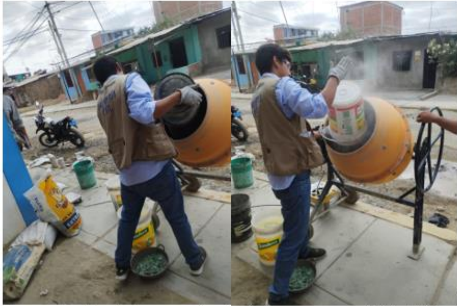
FOTO 14: MEZCLA DE AGREGADOS DISEÑO DE CONCRETO CON 3% DE PET
