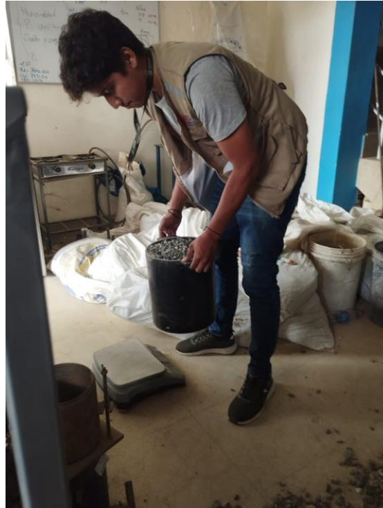
FOTO 9: PESO DE LAS PROPORCIONES DE AGREGADOS.
