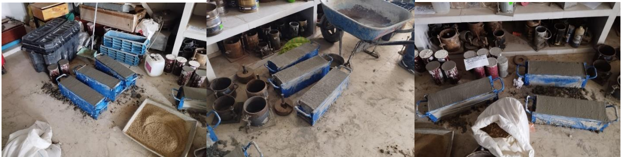
FOTO 17: ELABORACION DE VIGAS PARA ENSAYO DE FLEXIÓN
