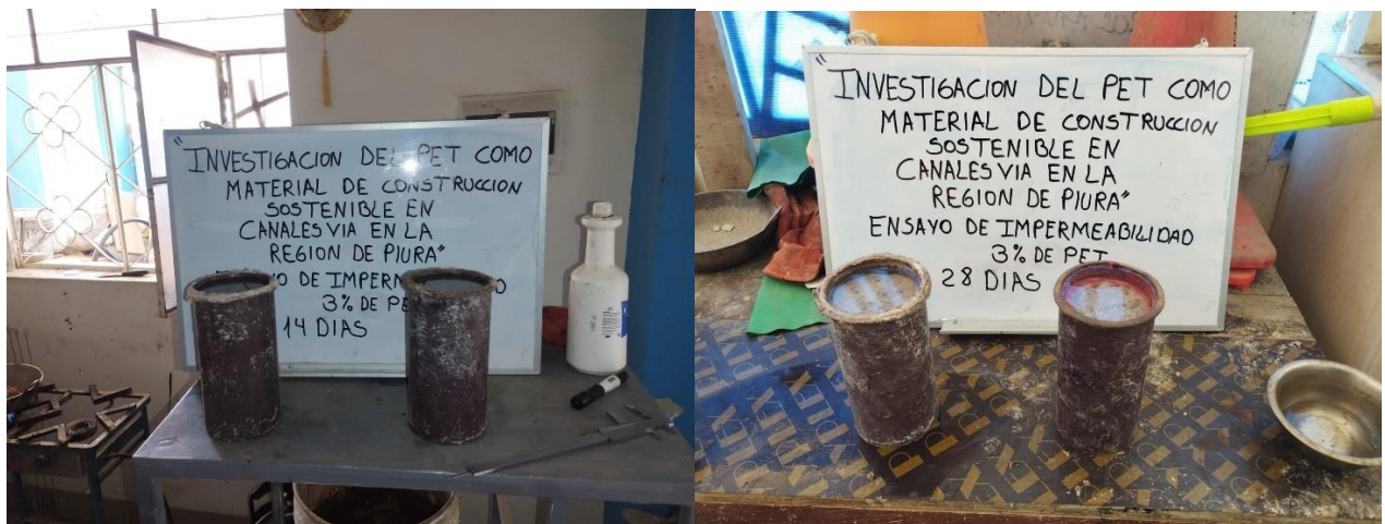
FOTO 28: ENSAYO DE IMPERMEABILIDAD DEL DISEÑO CON EL 3% DE PET – 14 Y 28 DÍAS
