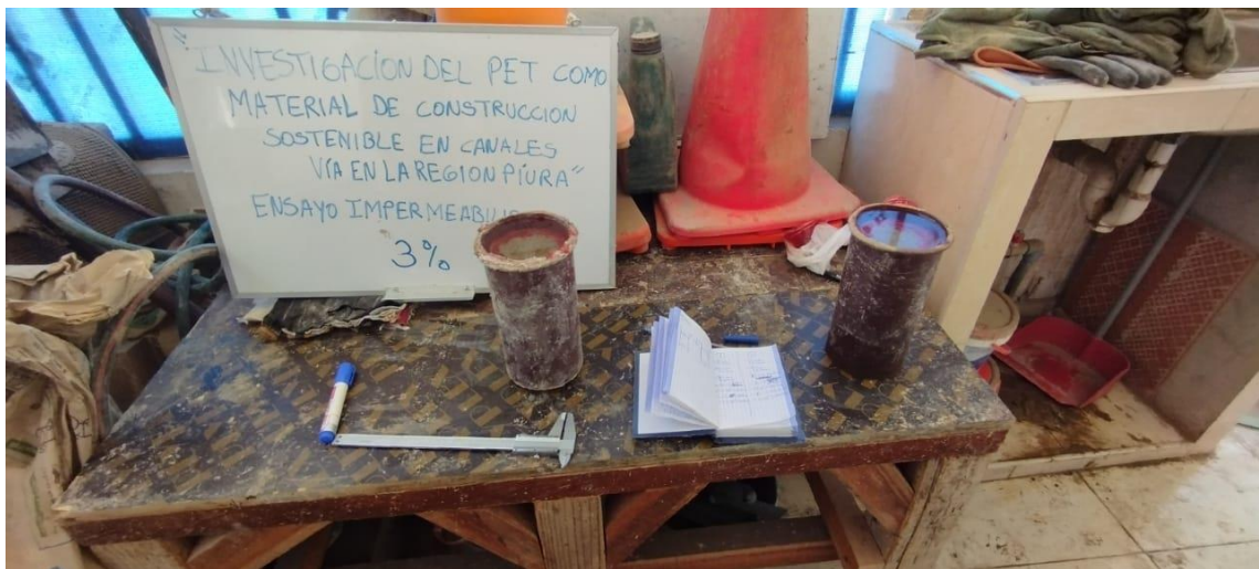
FOTO 23: ENSAYO DE IMPERMEABILIDAD DEL DISEÑO CON EL 3% DE PET - 7 DÍAS
