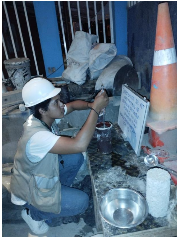
FOTO 26: ENSAYO DE IMPERMEABILIDAD DEL DISEÑO PATRON - 7 DÍAS.
