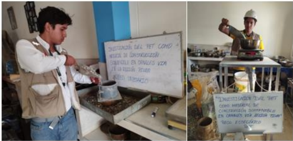
FOTO 6: ENSAYO DE PESO ESPECÍFICO DE AGREGADOS FINOS Y GRUESOS.
