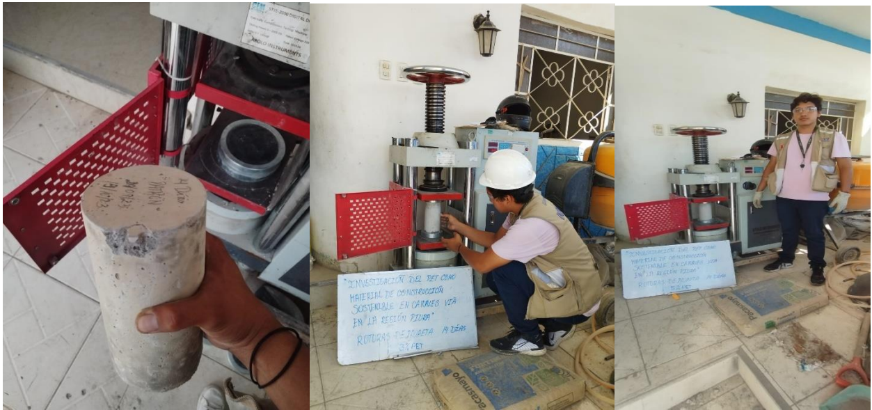
FOTO 22: ROTURA DE PROBETAS DEL DISEÑO PATRON, CON EL 3, 5 Y 7% DE PET
