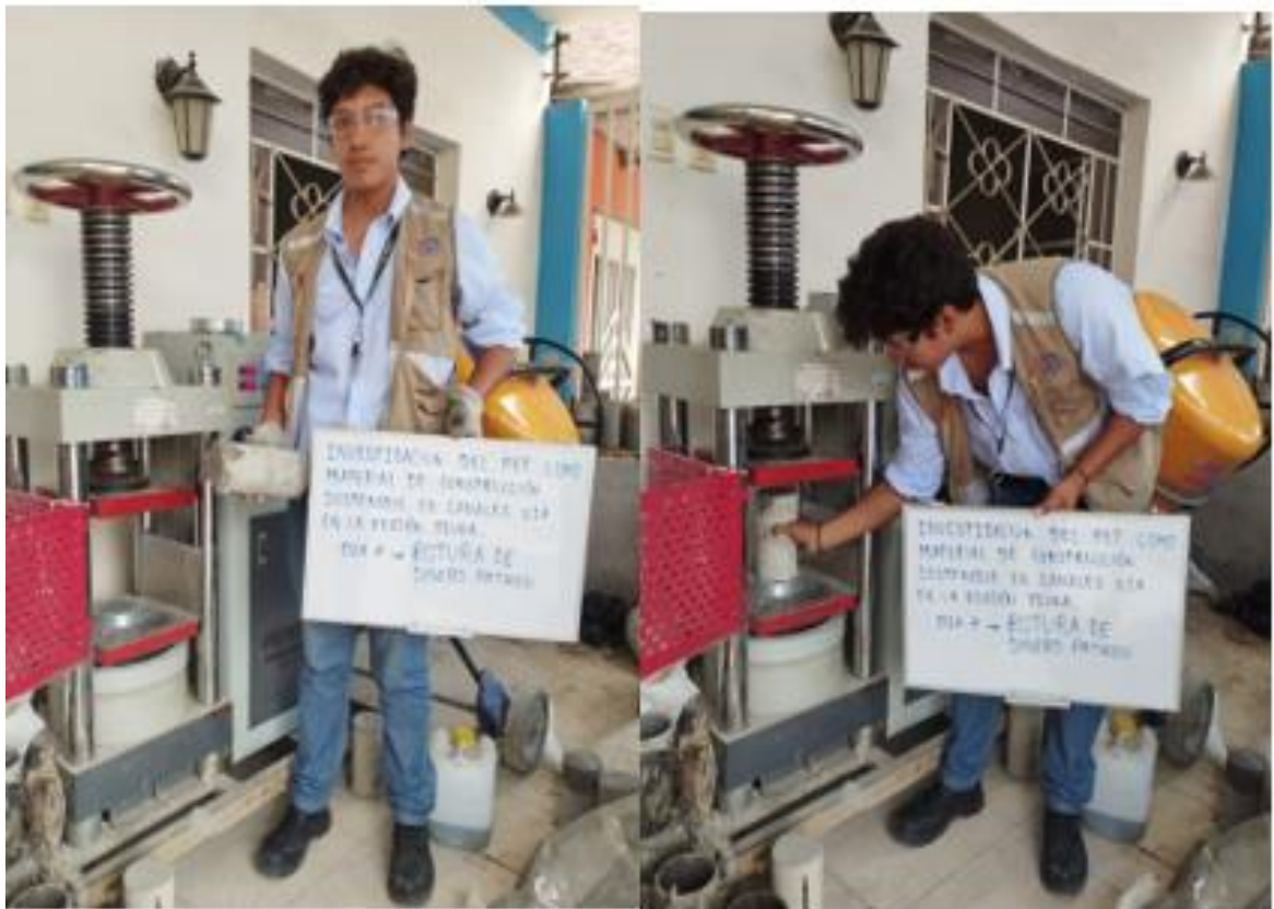
FOTO 19: ROTURA DE PROBETAS DEL DISEÑO PATRÓN 7
