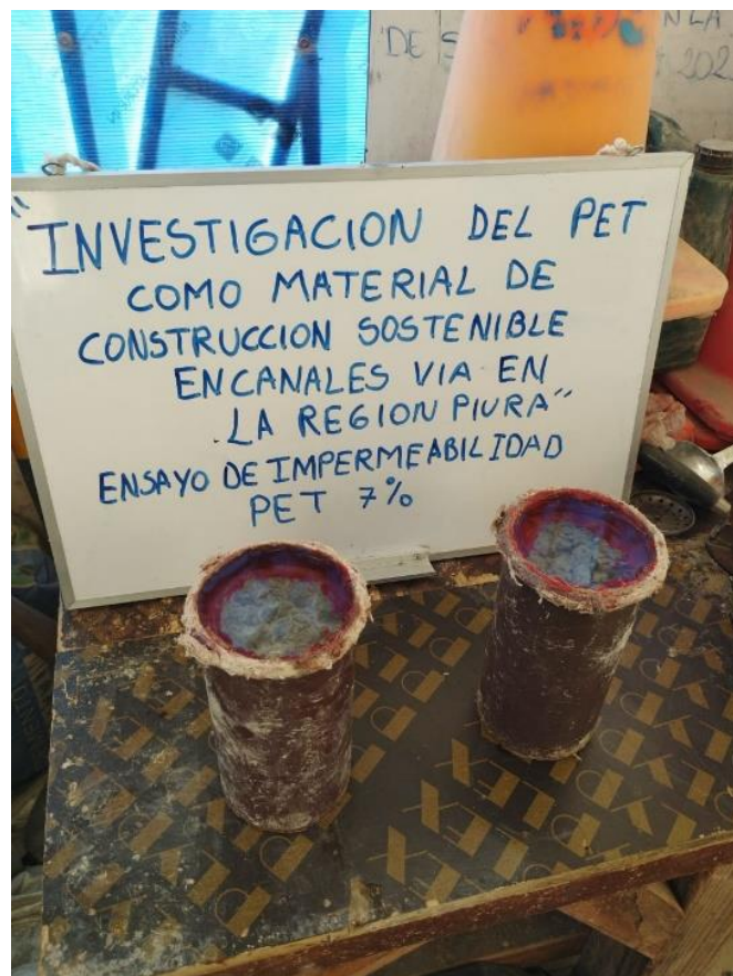
FOTO 25: ENSAYO DE IMPERMEABILIDAD DEL DISEÑO CON EL 7% DE PET - 7 DÍAS.
