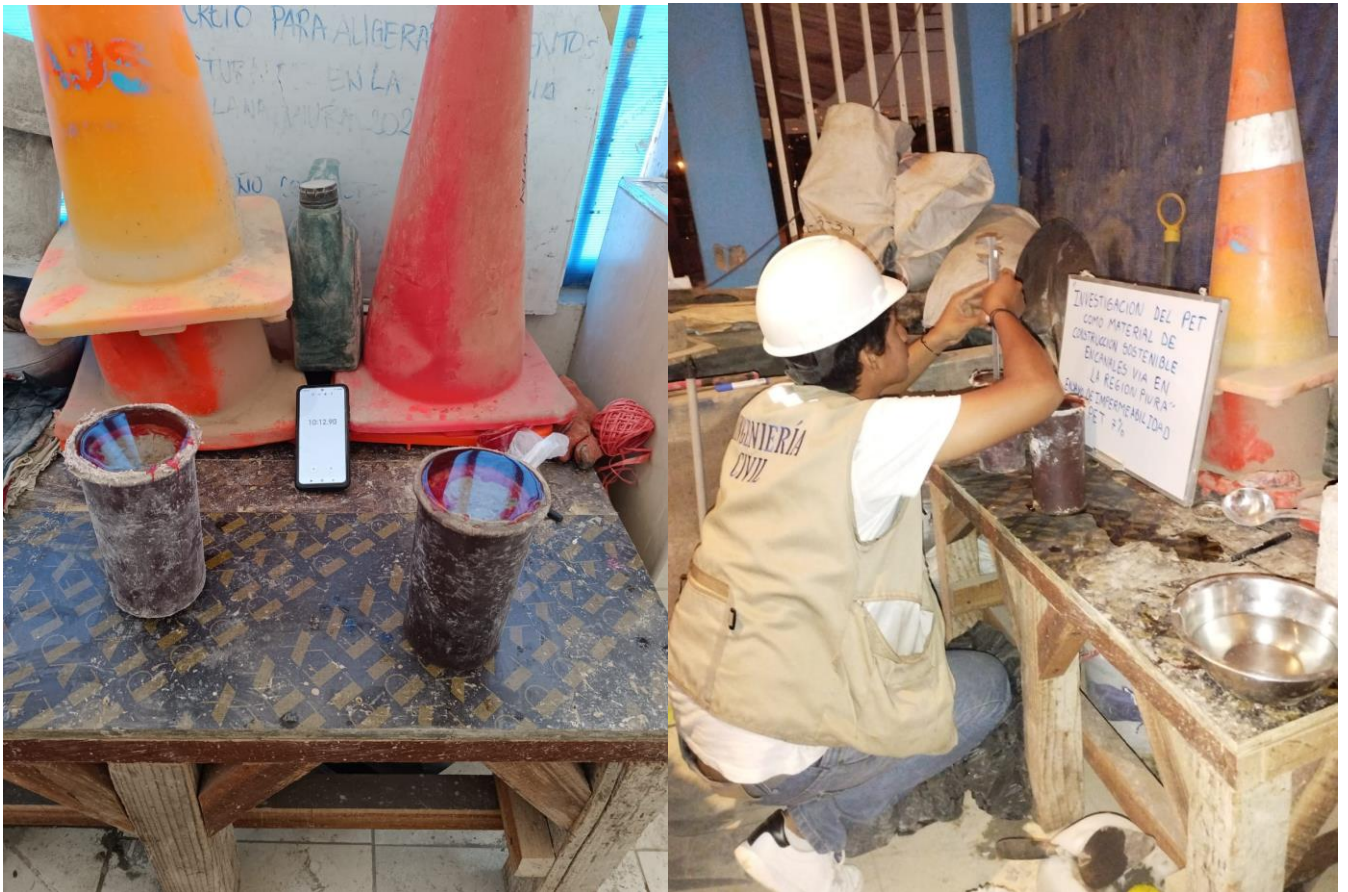
FOTO 27: ENSAYO DE IMPERMEABILIDAD DEL DISEÑO PATRON - 14 Y 28 DÍAS.
