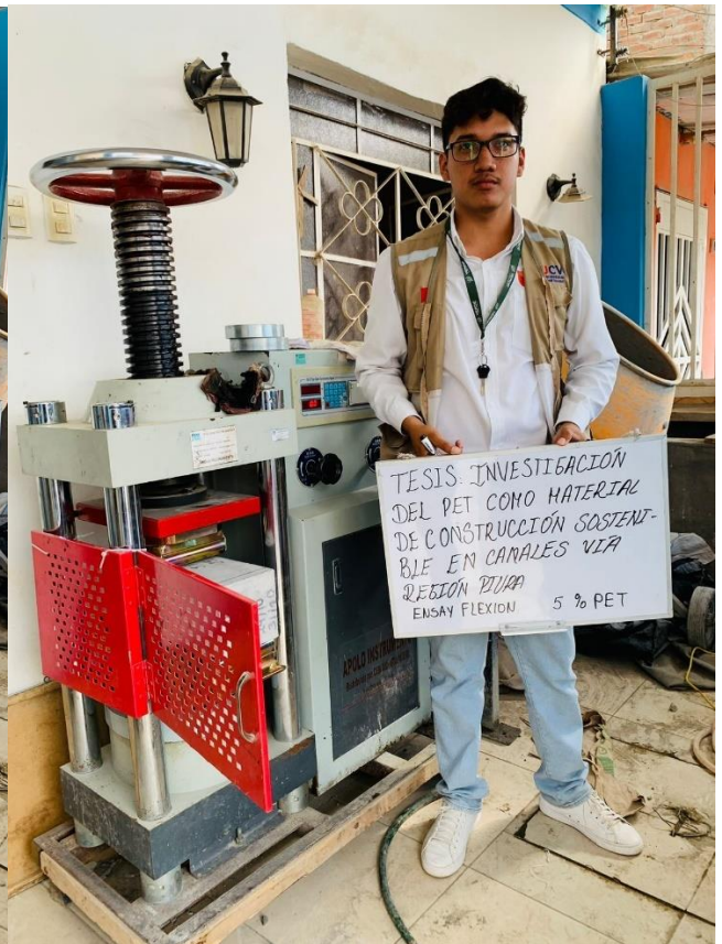
FOTO 32: ENSAYO DE FLEXIÓN DISEÑO PATRON, CON 3, 5 Y 7% DE PET
