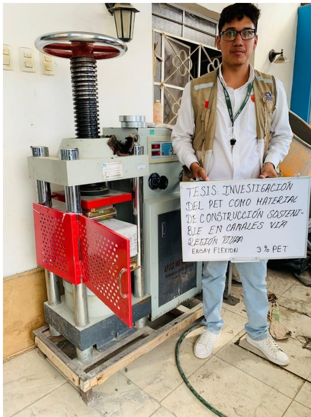
FOTO 32: ENSAYO DE FLEXIÓN DISEÑO PATRON, CON 3, 5 Y 7% DE PET
