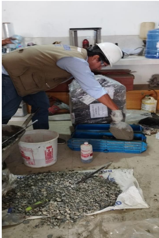
FOTO 16: ELABORACION DE VIGAS PARA ENSAYO DE FLEXIÓN
