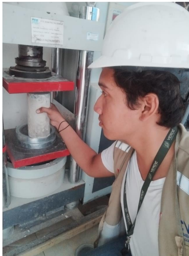
FOTO 21: ROTURA DE PROBETAS DEL DISEÑO CON EL 5% DE PET
