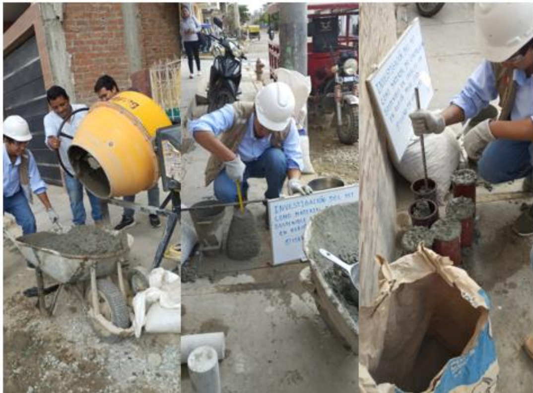
FOTO 15: MEZCLA DE AGREGADOS DISEÑO DE CONCRETO CON 3% DE PET
