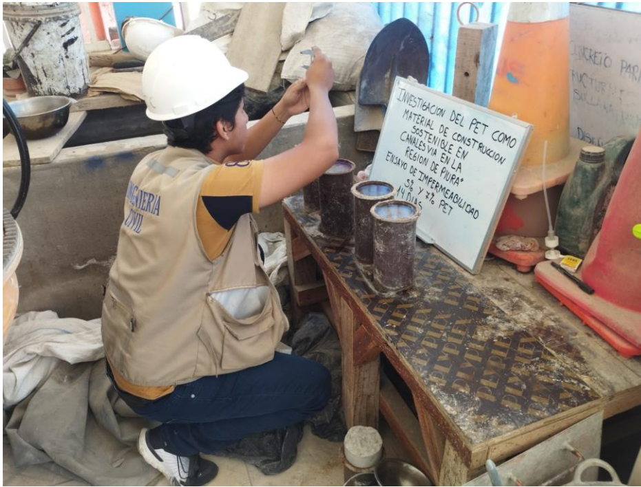
Foto 29: ENSAYO DE IMPERMEABILIDAD DEL DISEÑO CON EL 5 Y 7% DE PET – 14 DÍAS
