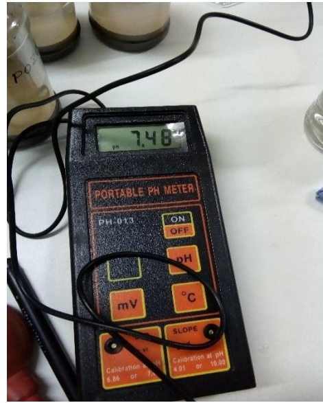
FIGURA N°48: Medición de parámetros físicos (pH, temperatura)
