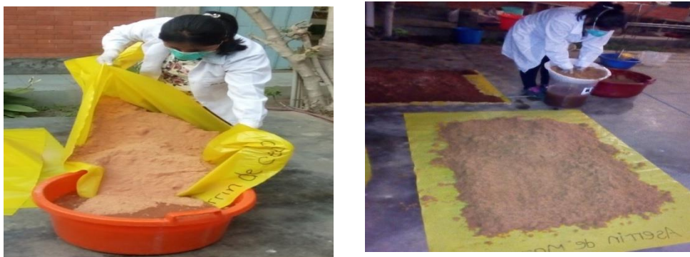
FIGURA N°6: Lavado y secado del aserrín
