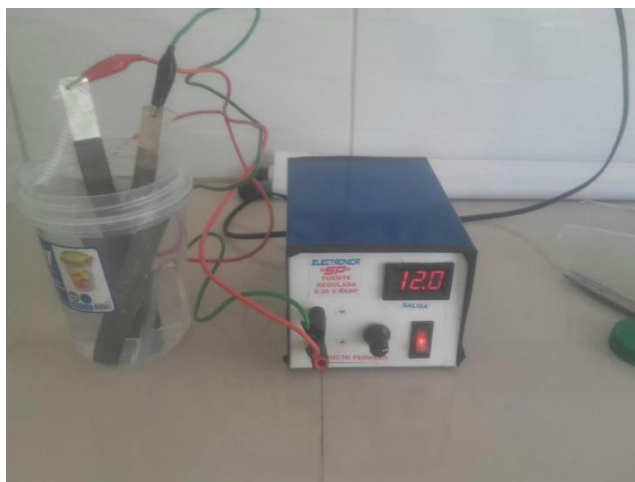
FIGURA N°7: Obtención de la plata coloidal
