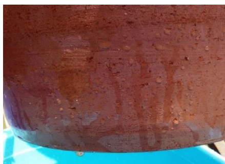
FIGURA N°10: Formación de poros en el filtro
