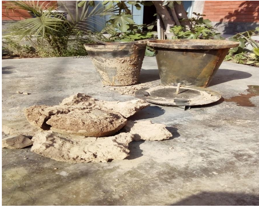
FIGURA N°36: Ruptura de filtros hechos en moldes de acero
