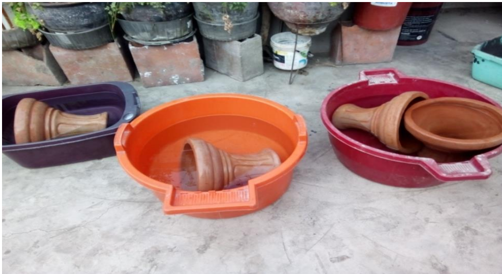
FIGURA N°37: Prueba de resistencia bajo agua de los filtros
