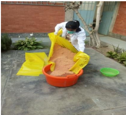
FIGURA N°22: Lavado del aserrín
