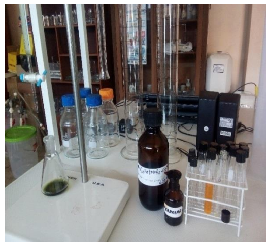
FIGURA N°45: Procedimiento para determinación de DQO
