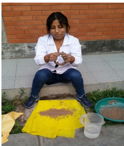
FIGURA N°32: Prueba de elasticidad de la arcilla
