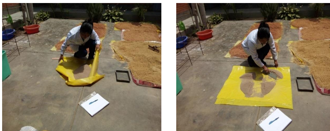
FIGURA N°30: Homogenización de arcilla para análisis de cadmio
