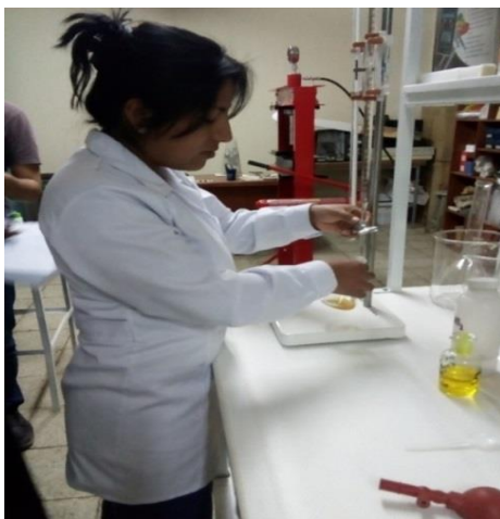
FIGURA N°45: Procedimiento para determinación de DQO
