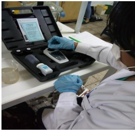
FIGURA N°51: Procedimientos para determinación de turbidez en el agua
