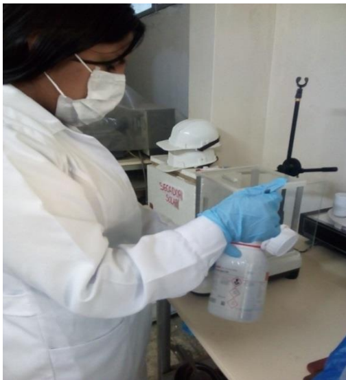
FIGURA N°49: Preparación de medios de cultivo para examen microbiológico
