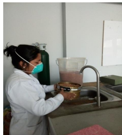
FIGURA N°27: Tamizado con malla #325
