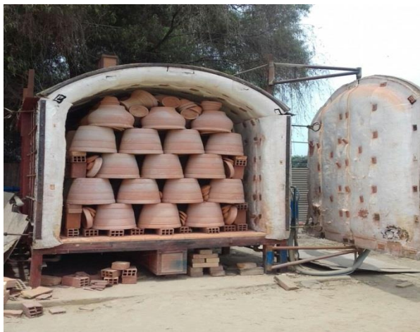
FIGURA N°44: Horno para secar los filtros
