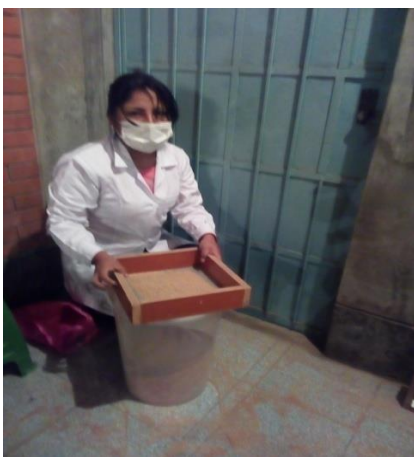
FIGURA N°26: Tamizado con malla # 400
