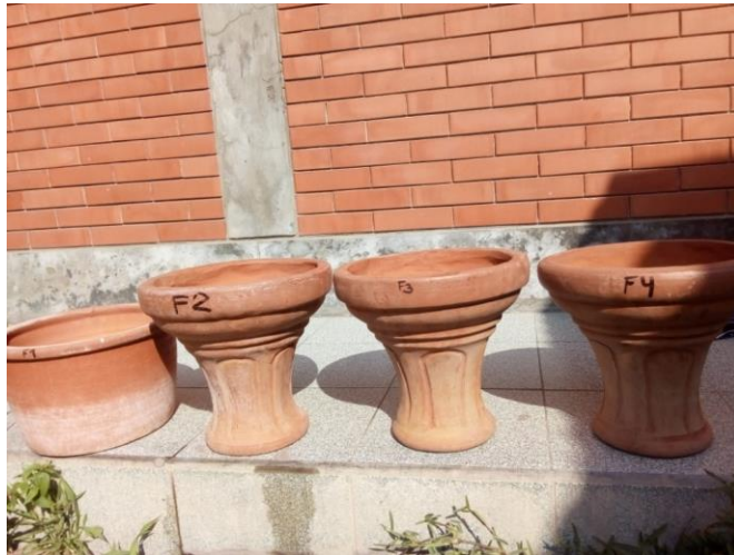
FIGURA N°40: Secado natural de filtros a temperatura ambiente
