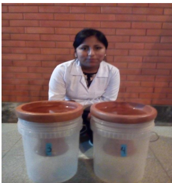
FIGURA N°39: Prueba de flujo de filtración de filtros
