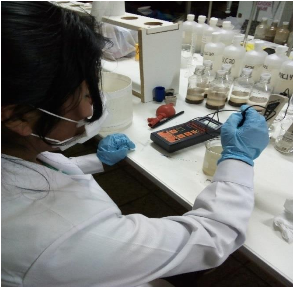
FIGURA N°48: Medición de parámetros físicos (pH, temperatura)
