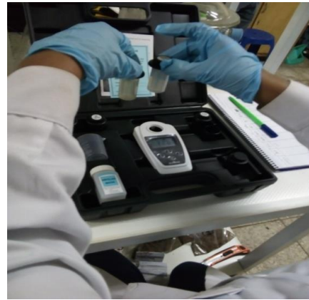
FIGURA N°51: Procedimientos para determinación de turbidez en el agua
