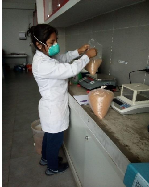
FIGURA N°28: Pesaje del aserrín
