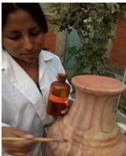
FIGURA N°38: Aplicación de plata coloidal al filtro
