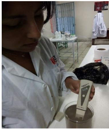
FIGURA N°43: Medición de solidos totales disueltos en plata coloidal
