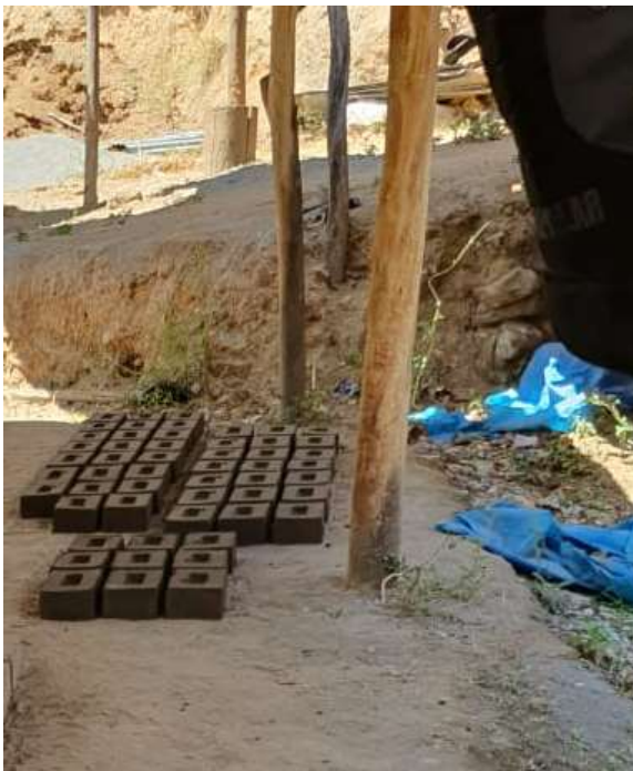
Figura 9: Ladrillo en su secado - primera parte
