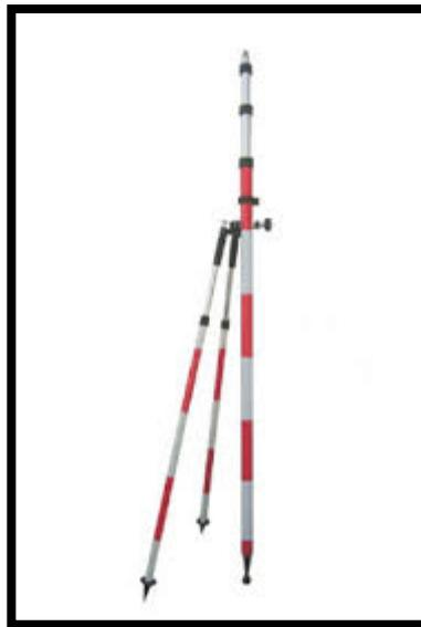
Los Jalones son utilizados para marcar puntos fijos durante el levantamiento topográfico, también dibujar y marcar puntos específicos del suelo y son instrumentos de gran ayuda para la estación total.
