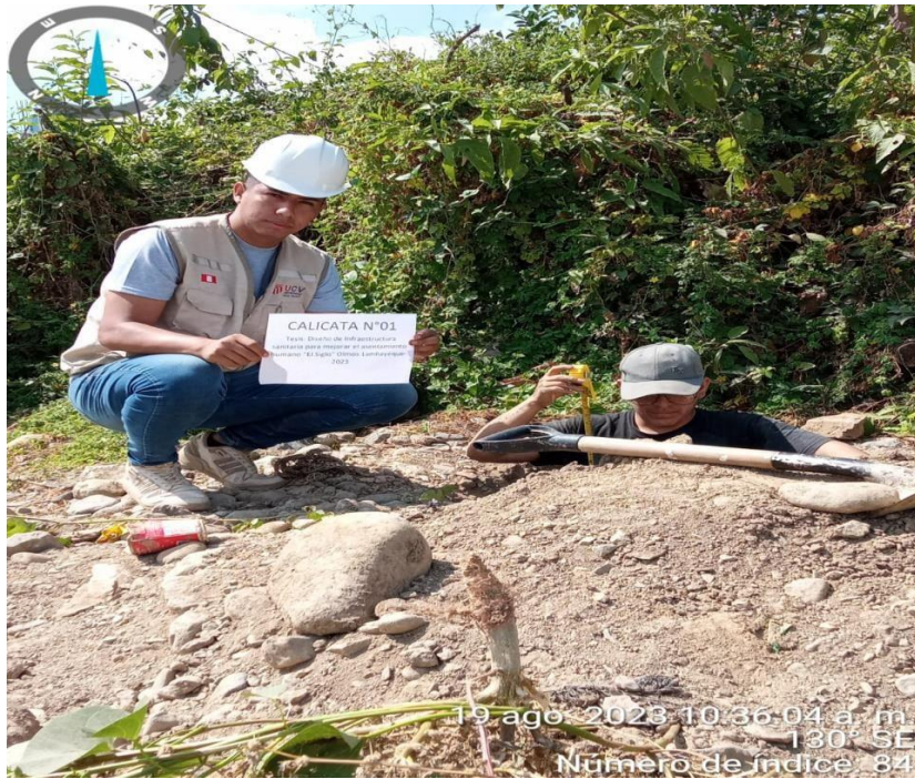
Figura 9. El Siglo: Calicata N°1, por excavación manual, 2023. Fuente: elaboración propia.
