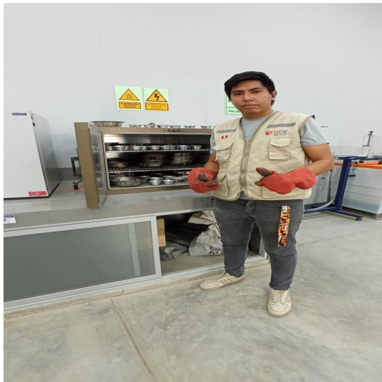
Figura 48. Ingresando al horno las taras del ensayo de límites Fuente: elaboración propia.
