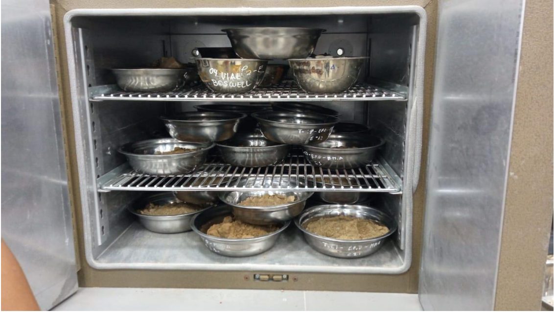
Figura 43. Dejando en el horno las muestras 24 hrs para el ensayo de contenido de humedad. Fuente: elaboración propia.
