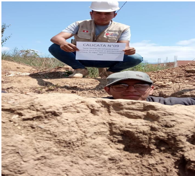
Figura 16. El Siglo: Calicata N°9, por excavación manual, 2023 Fuente: elaboración propia.
