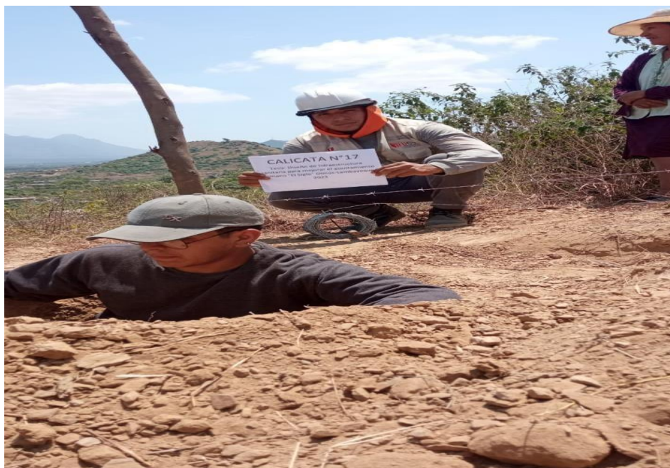
Figura 21. El Siglo: Calicata N°17, por excavación manual, 2023. Fuente: elaboración propia.
