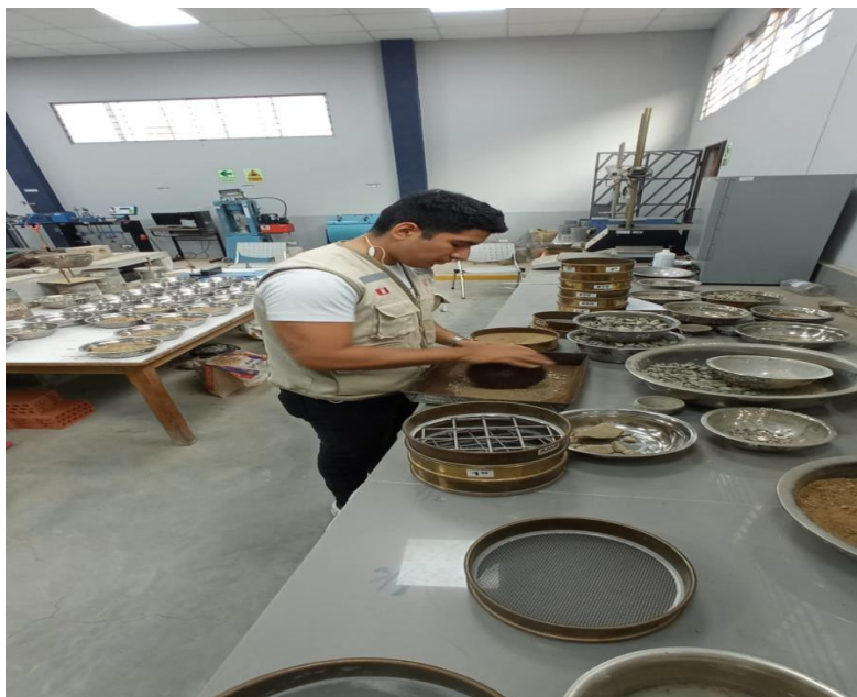
Figura 46. Chancando la piedra para el ensayo de límites. Fuente: elaboración propia.
