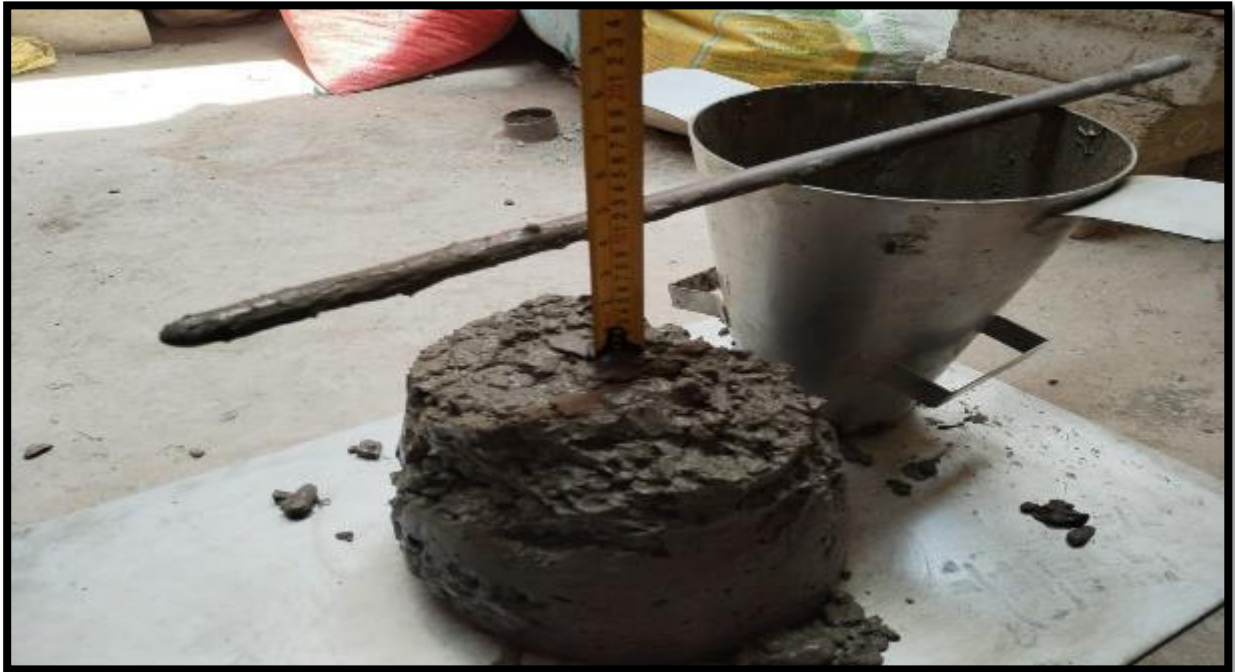
Foto 11. Medición del asentamiento de la mezcla de concreto control.
