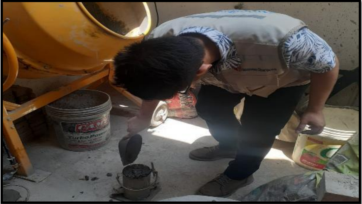
Foto 15. Tesista Villarroel Cieza Marlon compactando con la varilla lisa 25 con golpes en la probeta cilíndrica para el concreto con adición de AM.
