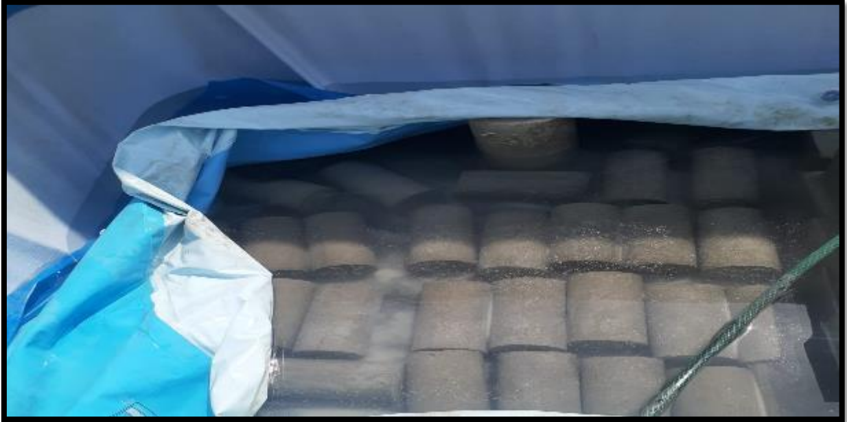
Foto 37. Probetas de concreto sumergidas en agua para su curado a los 7, 14 y 28 días.
