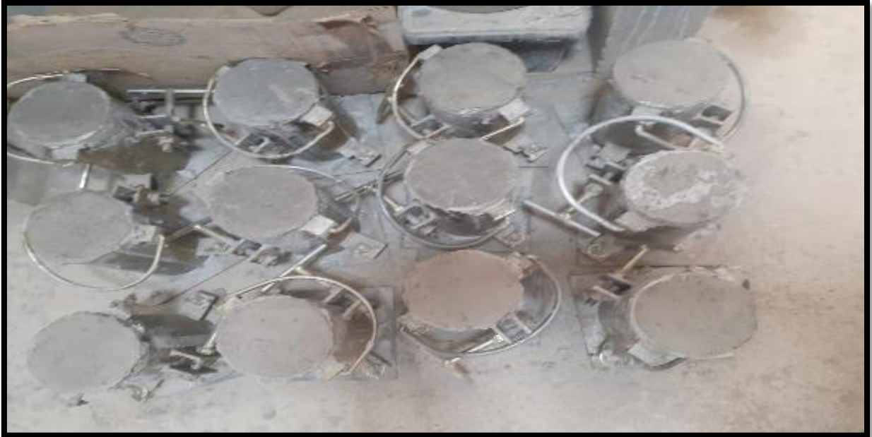
Foto 29. Secado de las probetas cilíndricas después de 24 horas.
