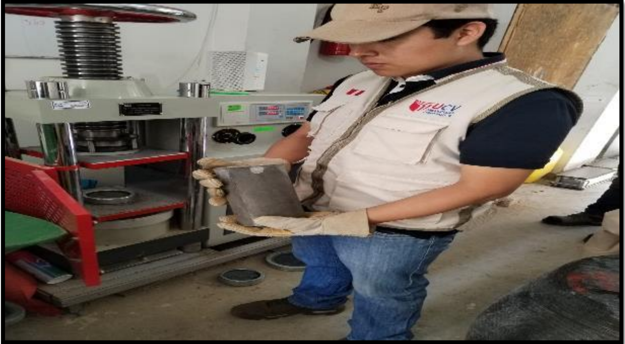
Foto 43. Tesista Quiliche Álvarez Gesvin Julio con el bloque de concreto con adición de AM listo para ser sometido a cargas a los 14 días.
