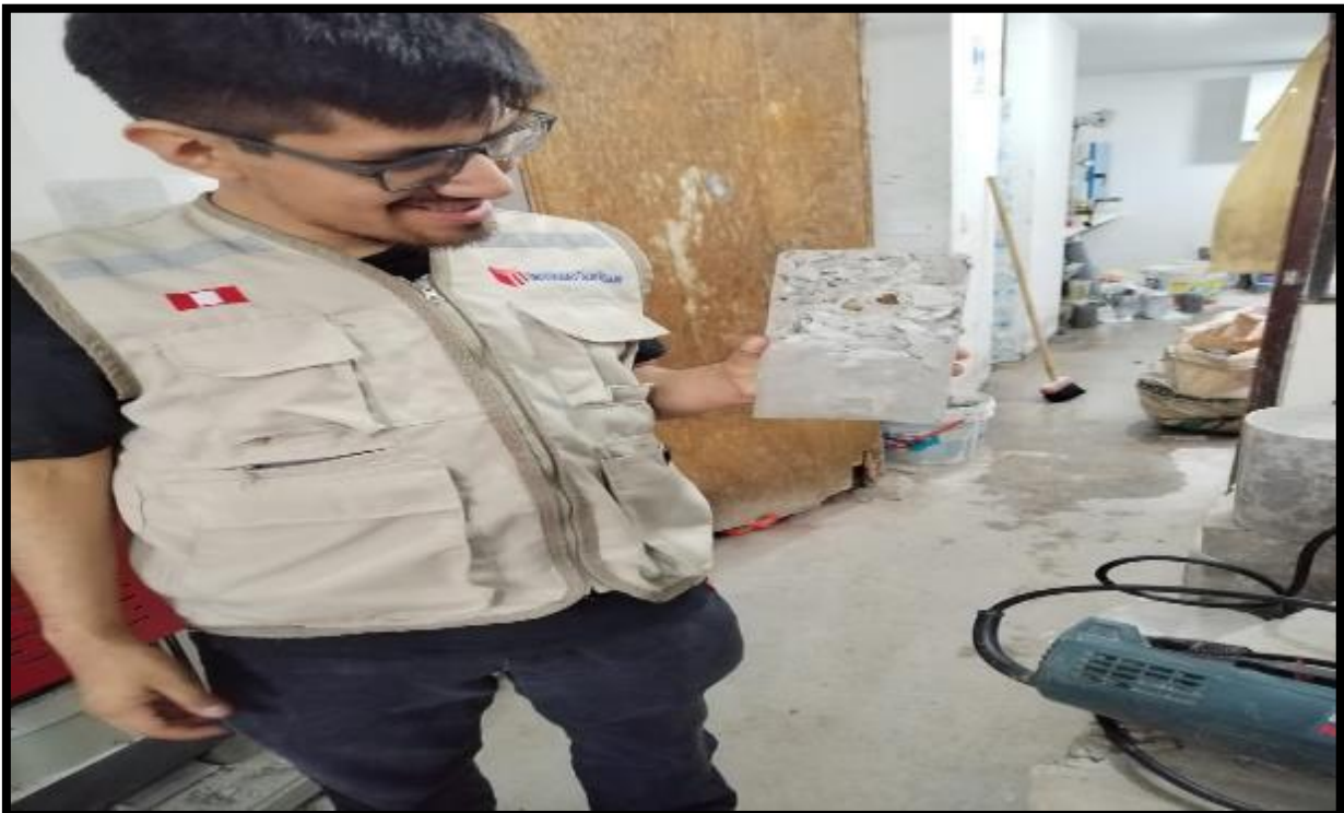
Foto 78. Tesista Villarroel Cieza Marlon, con la muestra de losa extraída, mostrando la falla por compresión.
