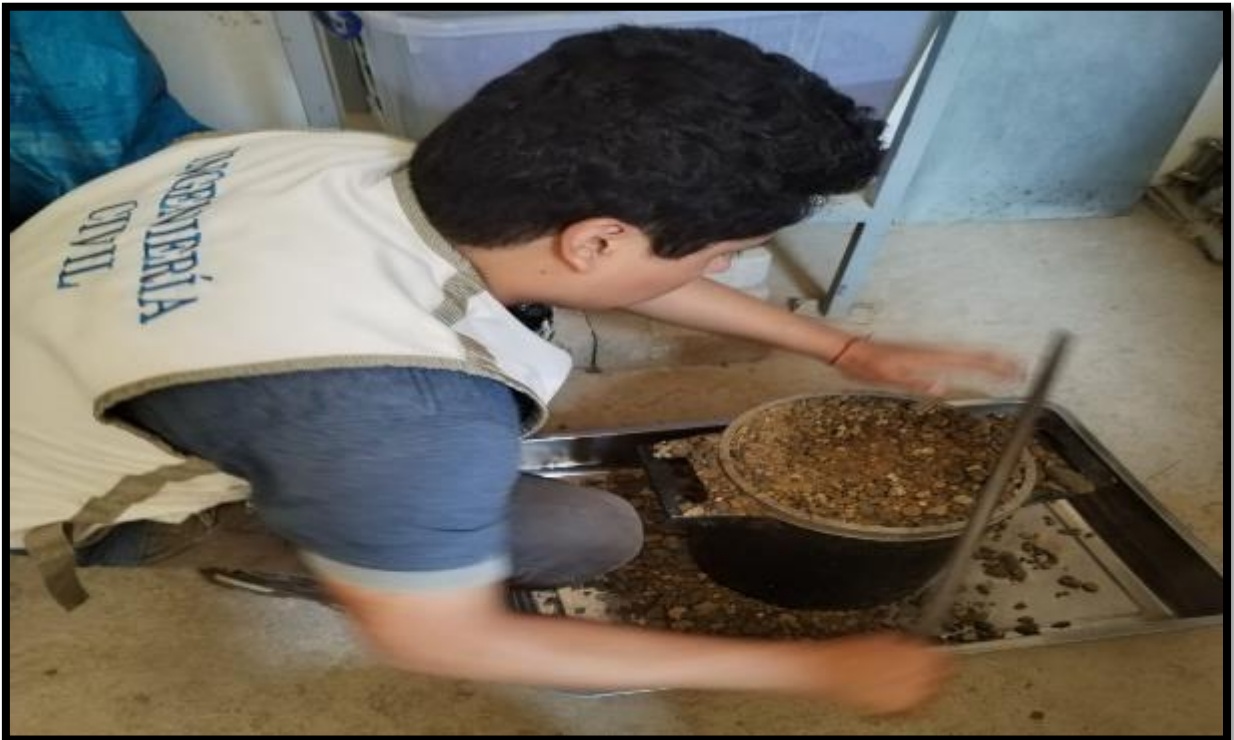
Foto 06. Tesista Quiliche Álvarez Gesvin Julio realizando el ensayo del peso unitario del agregado grueso.
