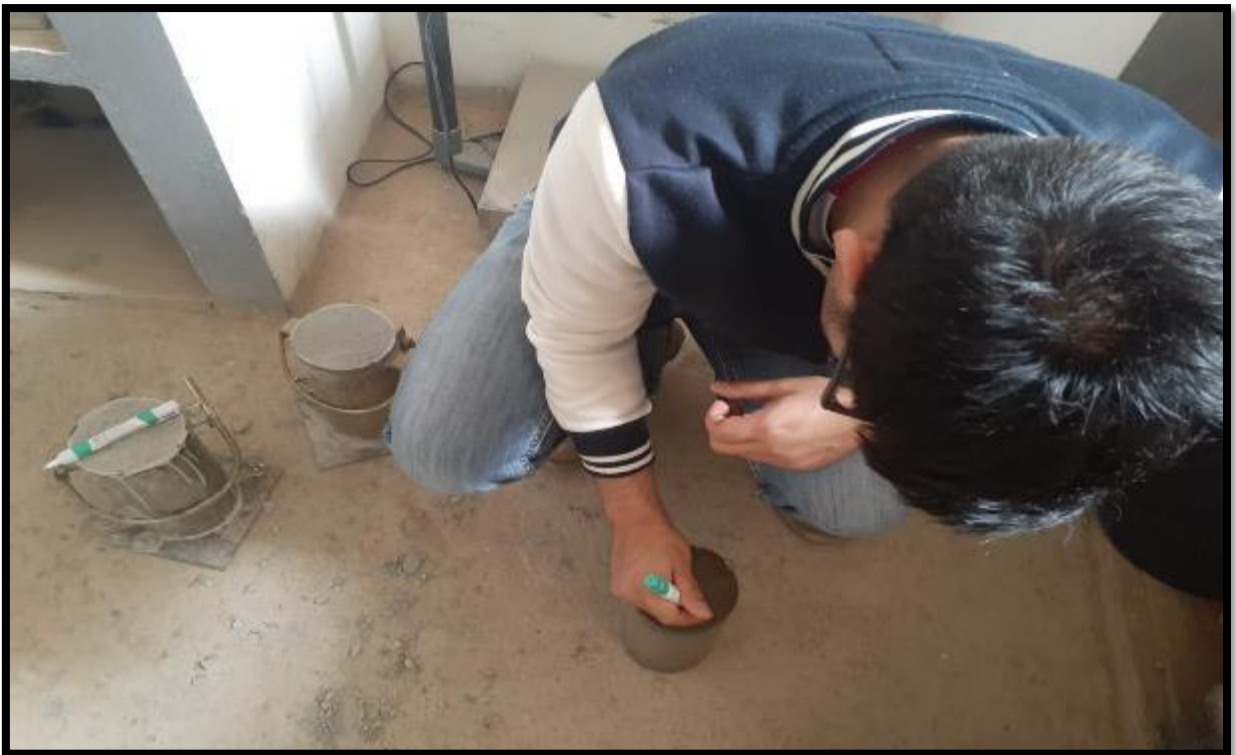
Foto 32. Tesista Villarroel Cieza Marlon, colocando los códigos de probetas de concreto para ensayos a compresión.
