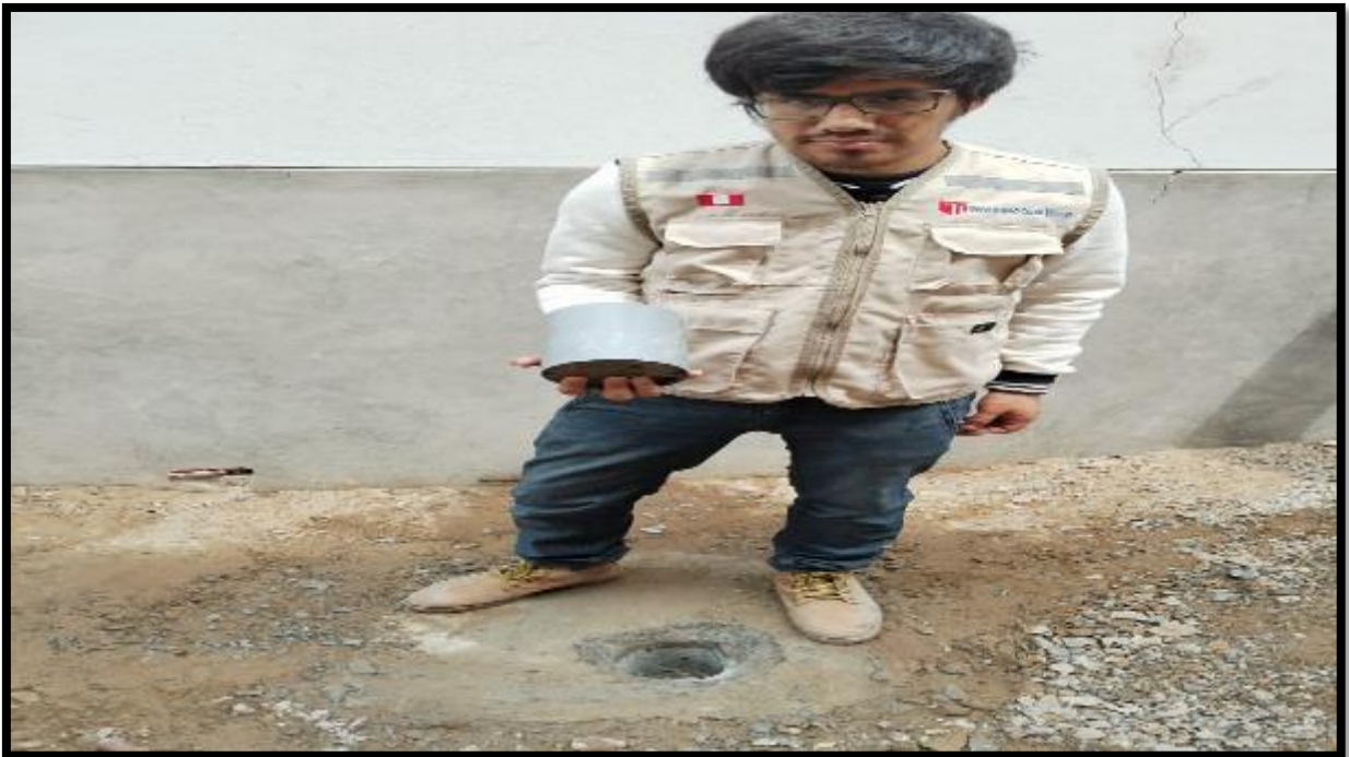
Foto 72. Tesista Villarroel Cieza Marlon con la muestra de concreto extraída para su posterior ruptura.
