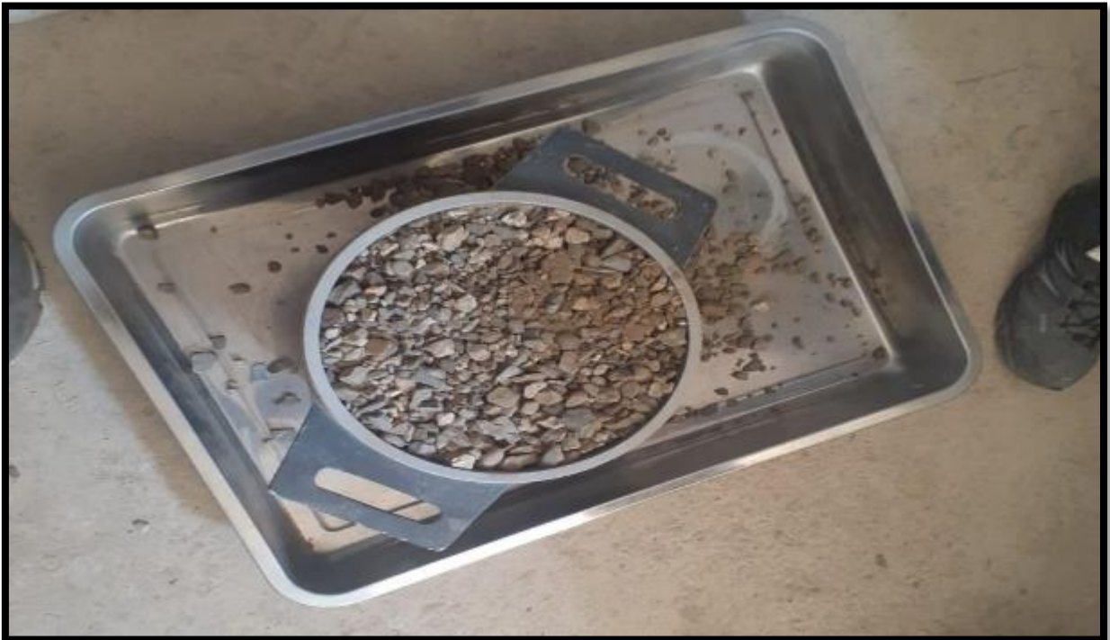
Foto 04. Ensayo del peso unitario del agregado grueso.
