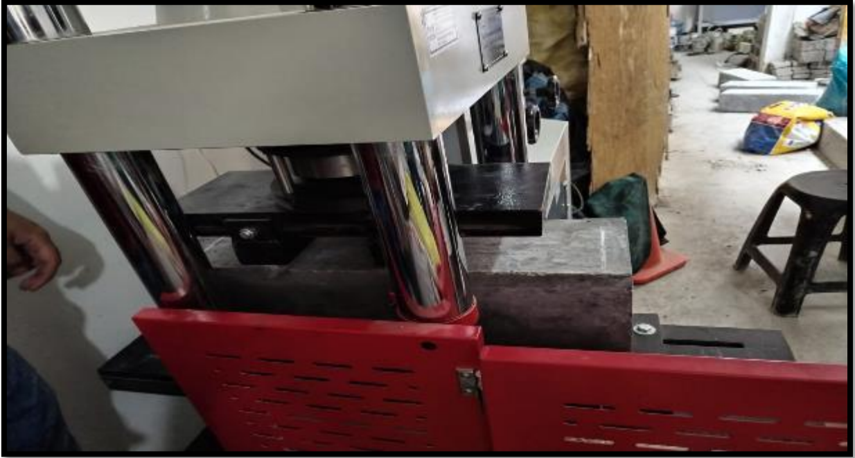
Foto 51. Viga de concreto con adición de AM al 3.00% ensayado a flexión a los 28 días.
