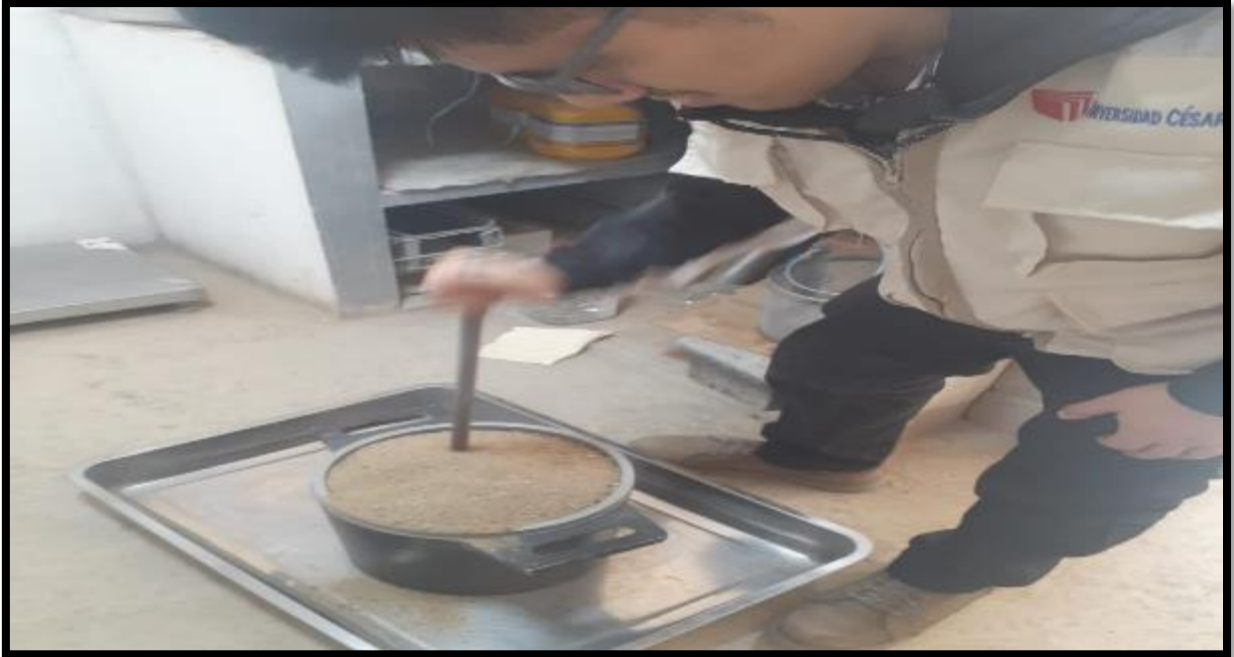
Foto 05. Tesista Villarroel Cieza Marlon realizando el ensayo del peso unitario del agregado fino.
