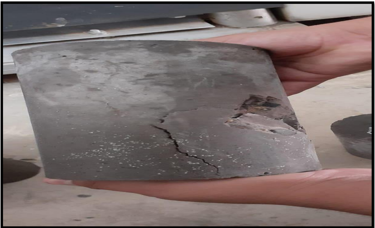
Foto 42. Bloque de concreto con adición de AM con las fallas ocasionadas por la carga de la máquina a compresión.
