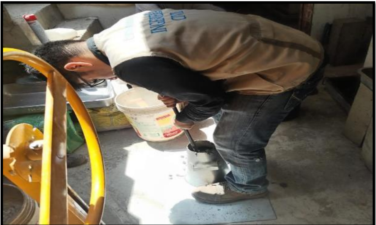
Foto 12. Tesista Villarroel Cieza Marlon realizando el compactado con la varilla en el tronco de cono para el ensayo del asentamiento en la mezcla de concreto con adición de AM.
