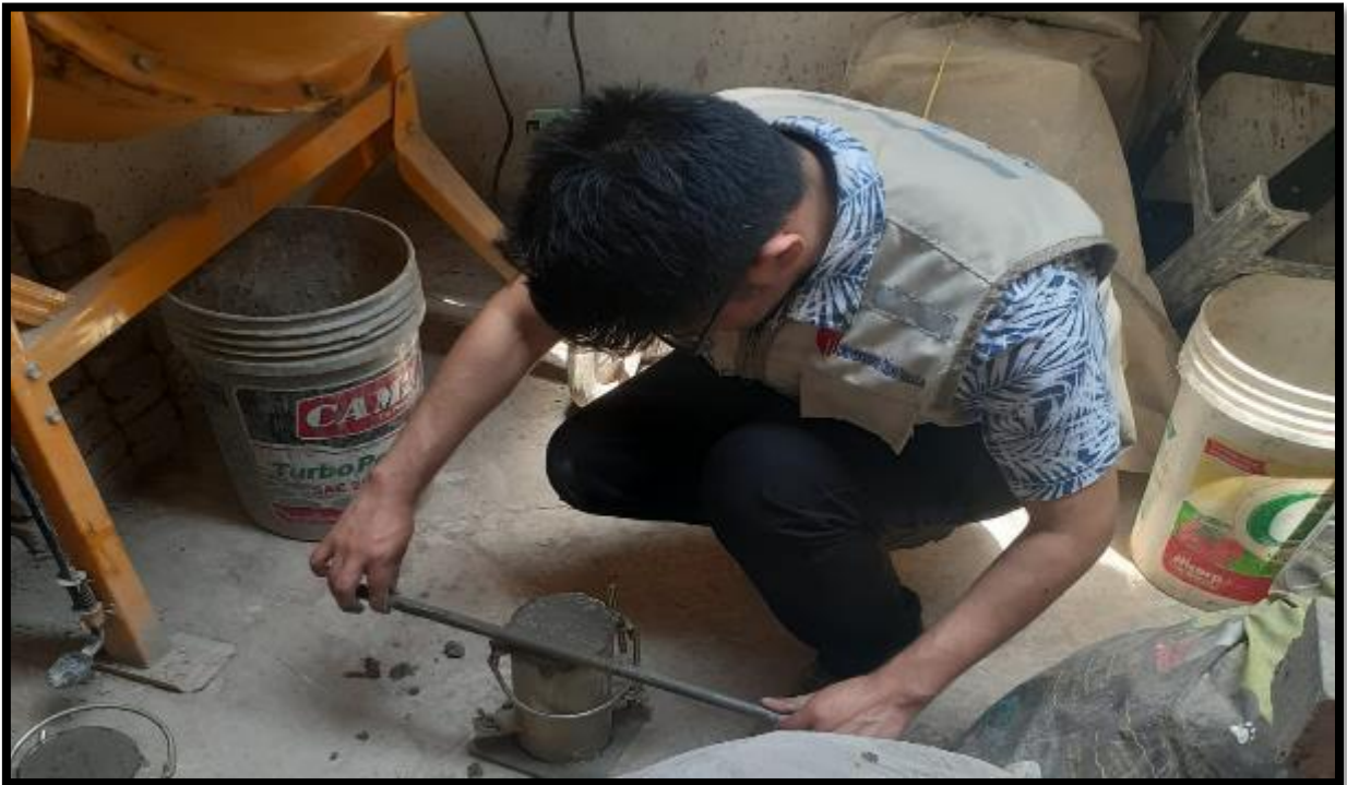
Foto 16. Tesista Villarroel Cieza Marlon enrasando con la varilla lisa en la última capa de concreto en las probetas cilíndricas con concreto con adición de AM.
