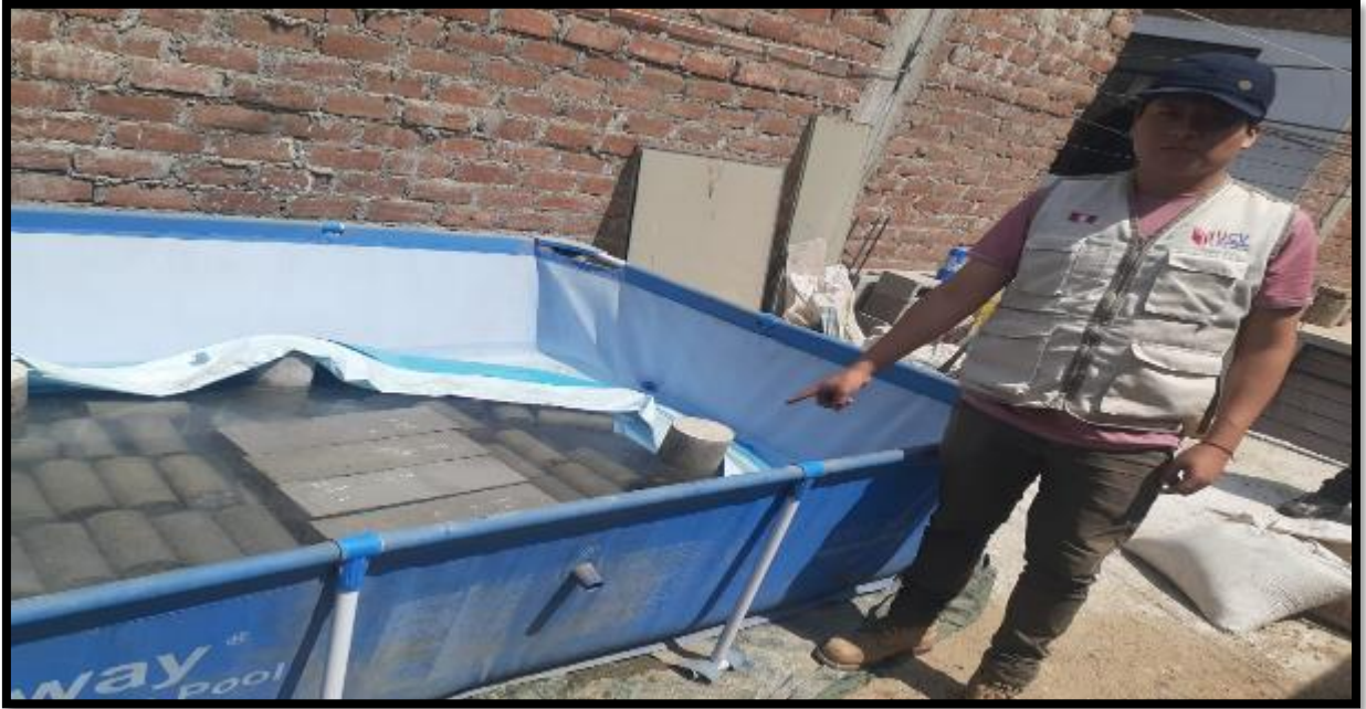
Foto 39. Tesista Quiliche Álvarez Gesvin señalando las probetas y vigas de concreto en agua para su curado.
