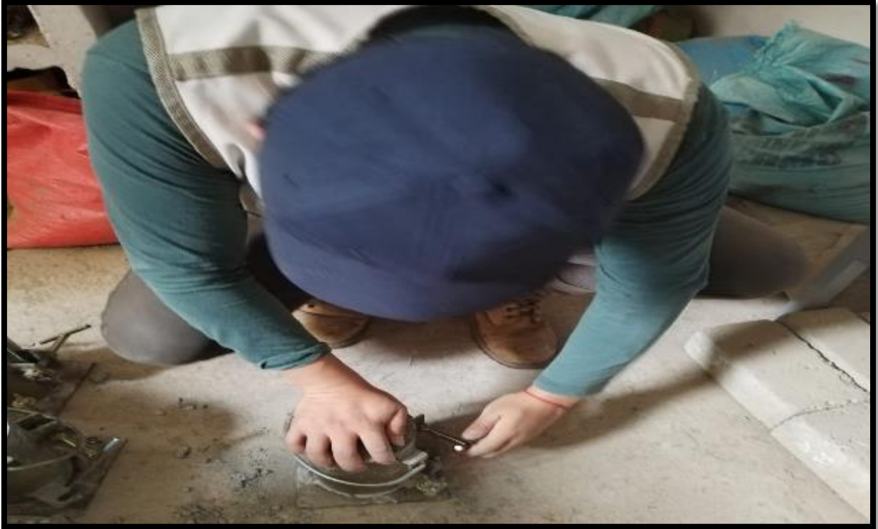
Foto 35. Tesista Quiliche Álvarez Gesvin Julio desmoldando las probetas de mezcla para el posterior curado a los días establecidos.
