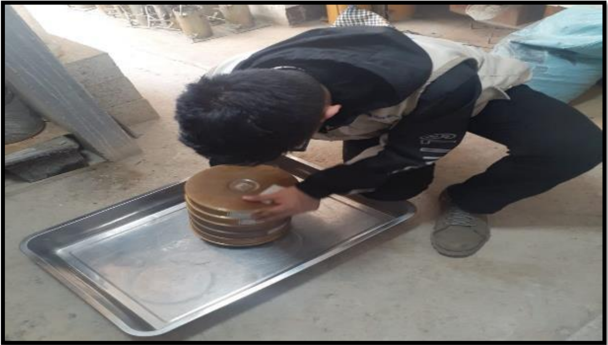
Foto 01. Tesista Villarroel Cieza Marlon realizando el tamizado para el análisis granulométrico.
