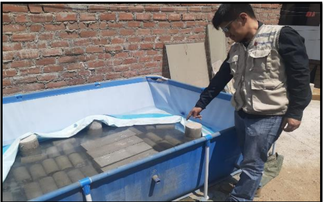
Foto 38. Tesista Villarroel Cieza Marlon señalando las probetas y vigas en agua para su curado.
