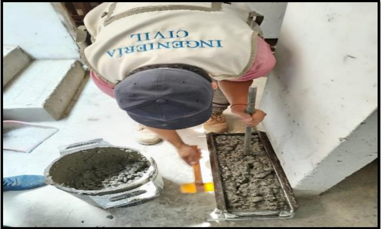
Foto 27. Tesista Quiliche Álvarez Gesvin Julio compactando con la varilla lisa y golpeando con el martillo de goma la mezcla de concreto con adición de AM en los moldes tipo viga.
