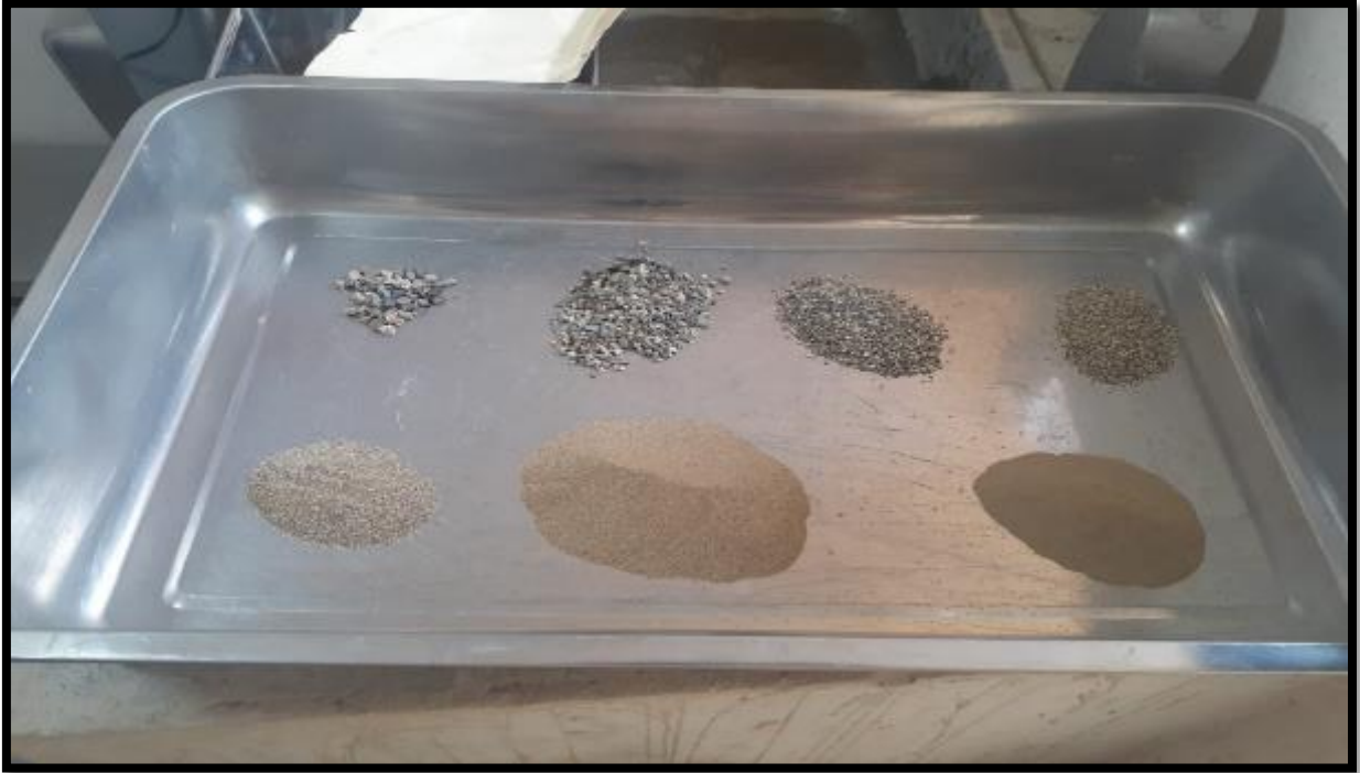
Foto 03. Separación de las diferentes partículas de la muestra del agregado por el método de tamizado.
