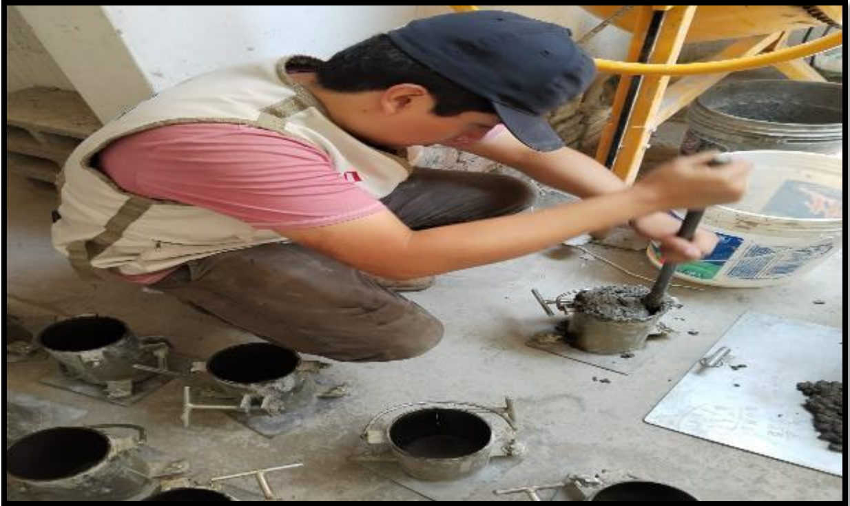
Foto 13. Tesista Quiliche Álvarez Gesvin Julio compactando con la varilla lisa 25 con golpes en la probeta cilíndrica para el concreto control.
