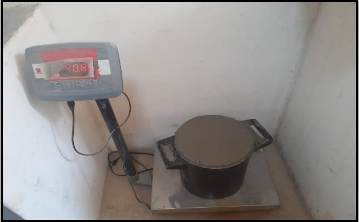
Foto 21. Peso unitario del concreto control.
