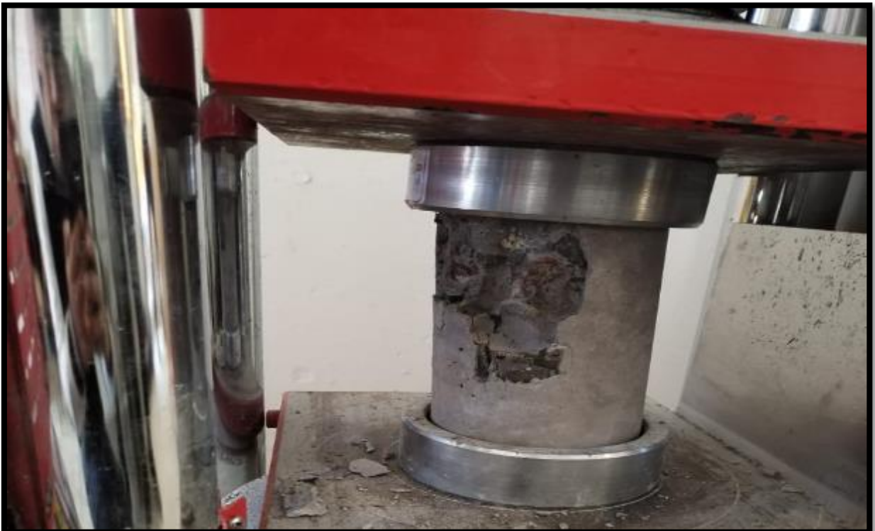
Foto 76. Muestra de concreto extraída de la losa sometida a ensayos de compresión.
