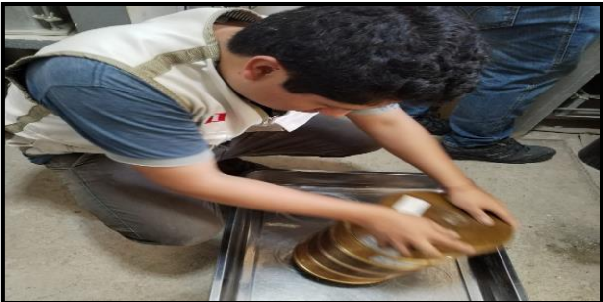
Foto 02. Tesista Quiliche Álvarez Gesvin Julio realizando el tamizado para el análisis granulométrico.
