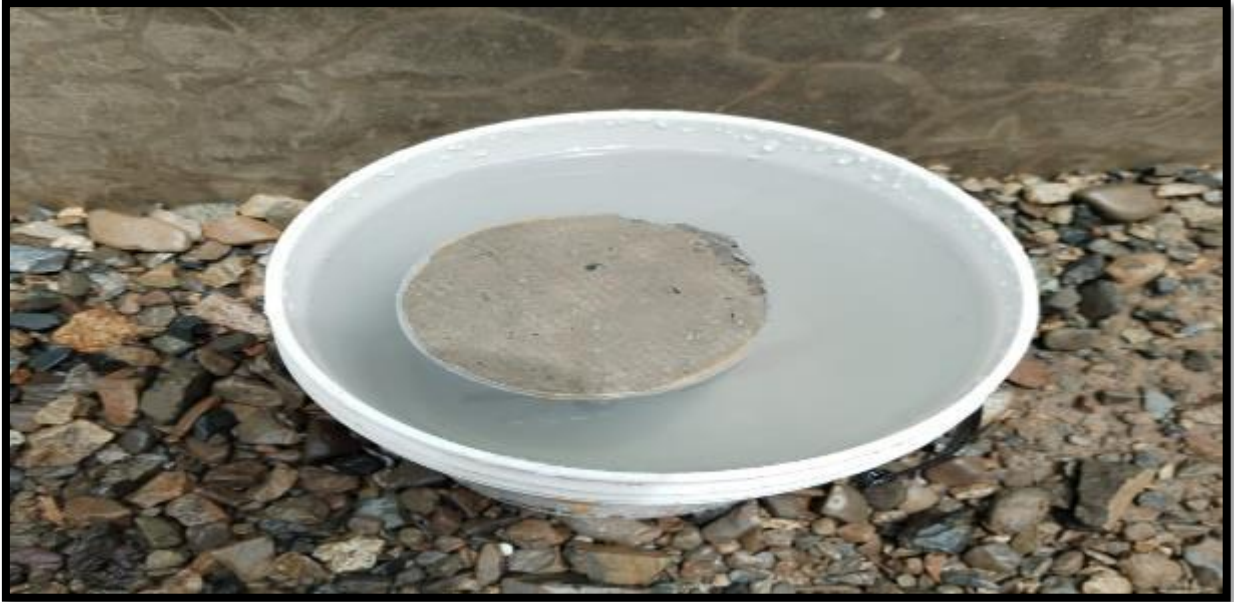
Foto 73. Muestra de concreto extraída del paño de losa, puesto en agua para su hidratación hasta ser llevada al laboratorio para su posterior ruptura.
