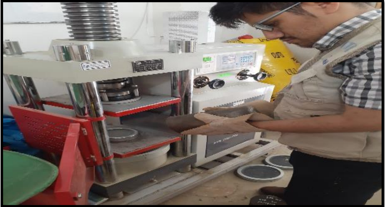
Foto 41. Tesista Villarroel Cieza Marlon introduciendo el bloque de concreto control a la máquina de compresión.
