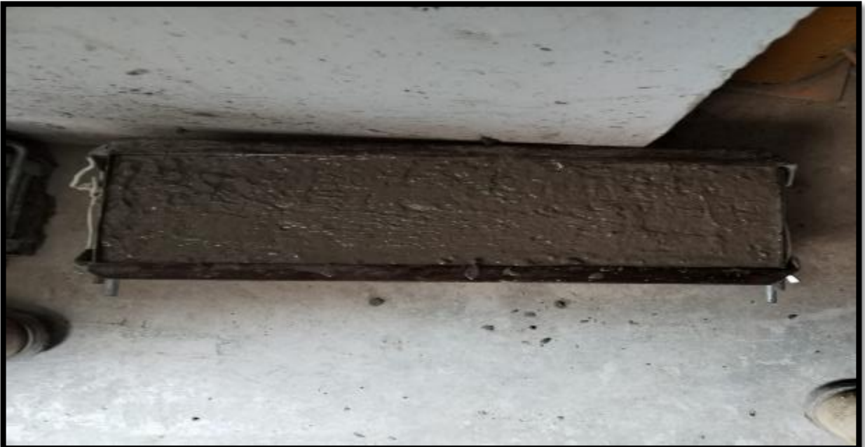
Foto 28. Realización de la viga de concreto con adición de AM.
