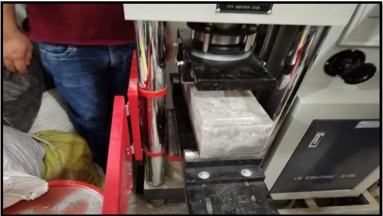
Foto 50. Probetas tipo vigas de concreto control ensayados a pruebas de flexión a los 28 días.
