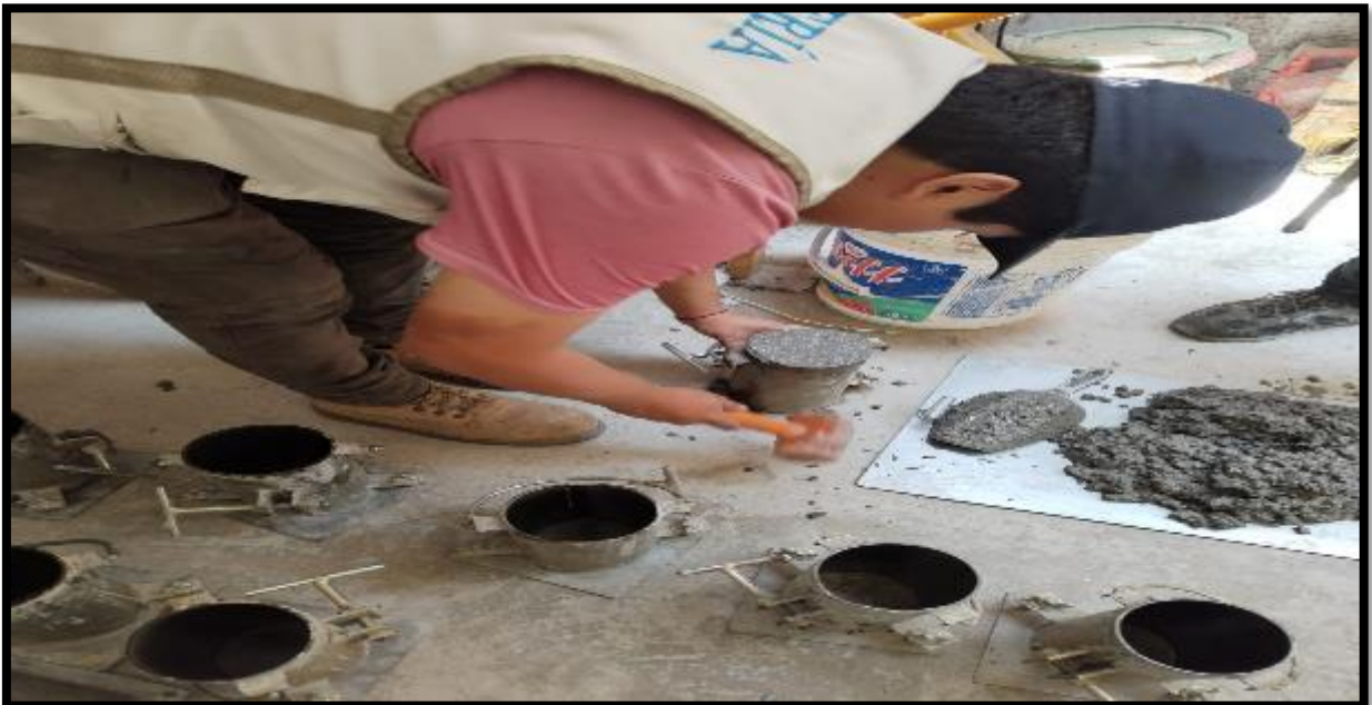
Foto 14. Tesista Quiliche Álvarez Gesvin Julio golpeando los costados de las probetas cilíndricas con el martillo de goma para eliminar los vacíos restantes.
