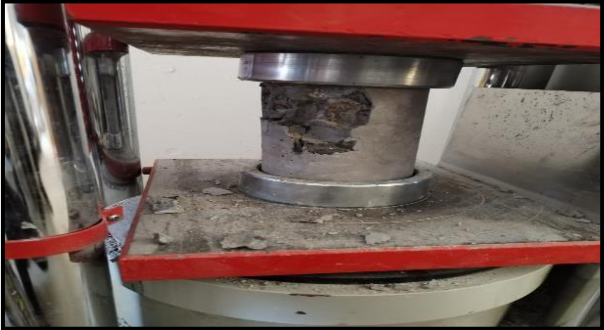
Foto 77. Muestra de concreto extraída de la losa siendo sometida a carga por la maquina a compresión.
