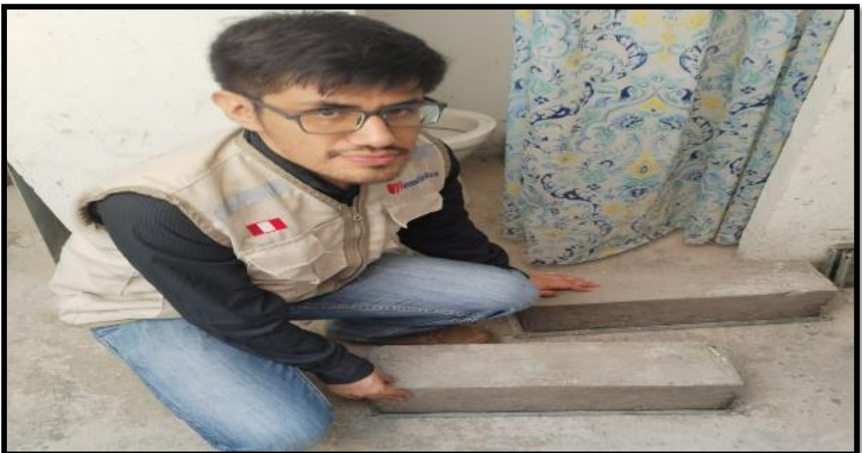
Foto 36. Desmoldado de las vigas de concreto para su posterior curado.
