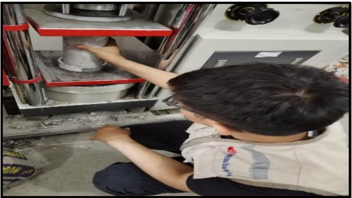
Foto 74. Tesista Villarroel Cieza Marlon, colocando la muestra de losa extraída en la máquina de ensayo a compresión.
