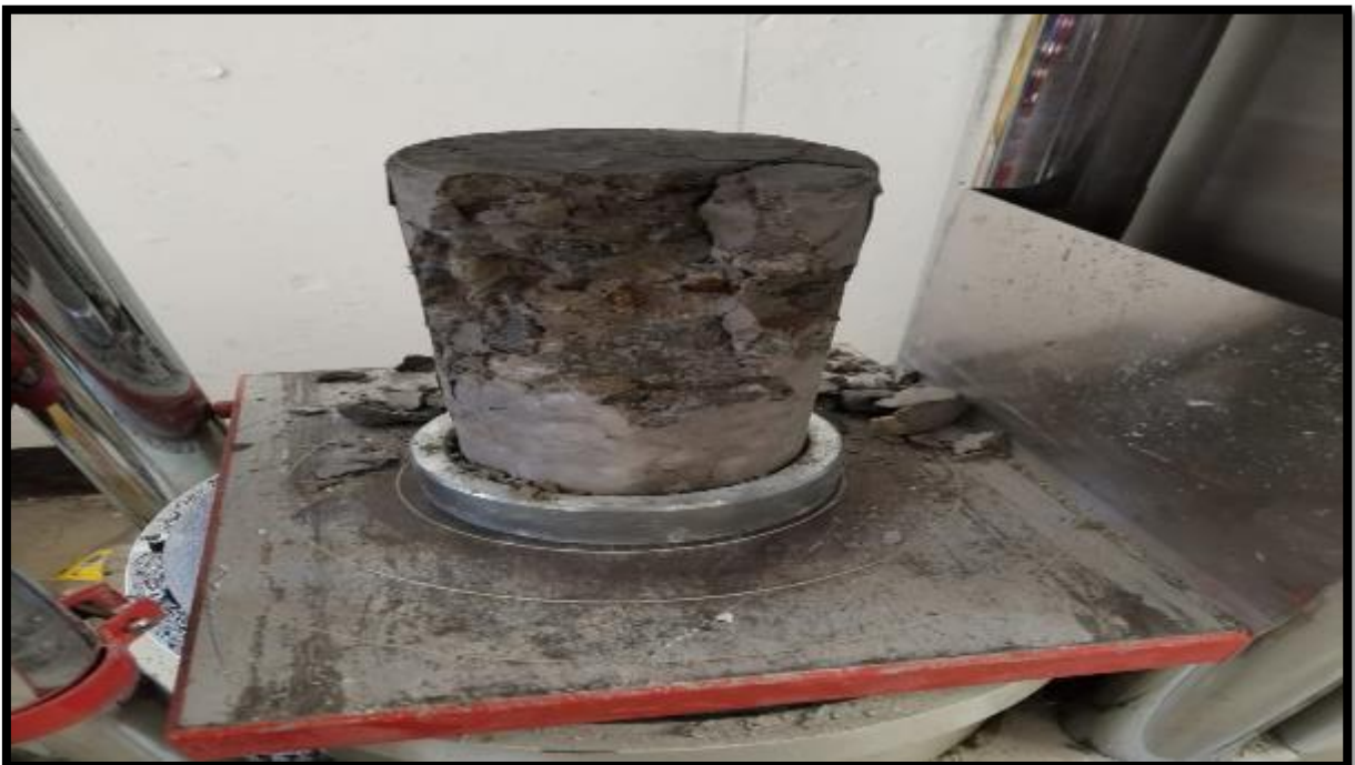
Foto 80. Muestra de concreto extraída del paño de losa después de la rotura a compresión.
