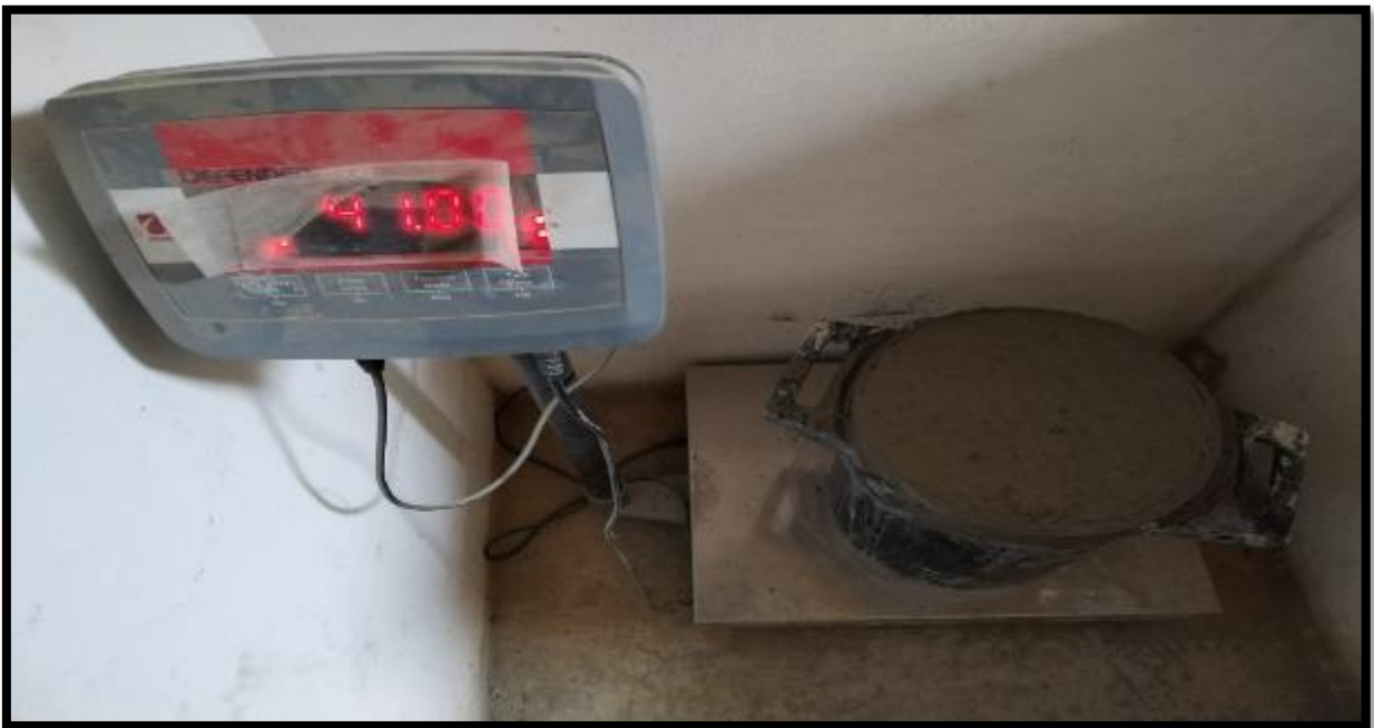
Foto 22. Peso unitario del concreto con adición de AM.
