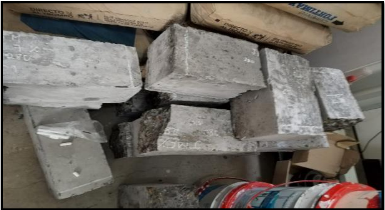
Foto 52. Vigas de concreto ya ensayados a la resistencia a la flexión a los 28 días.
