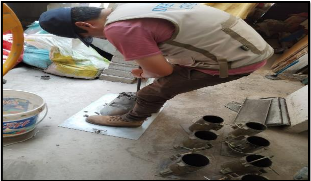
Foto 10. Tesista Quiliche Álvarez Gesvin Julio realizando el compactado con la varilla en el tronco de cono para el ensayo del slump de la mezcla de concreto control.
