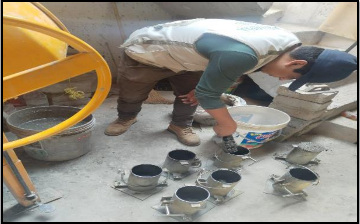
Foto 17. Tesista Quiliche Álvarez Gesvin Julio llenando con concreto con adición de AM en las probetas cilíndricas.
