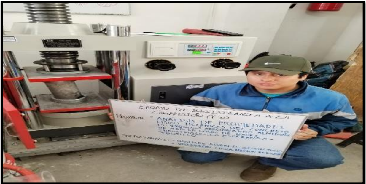
Foto 48. Ensayo de resistencia a la compresión de las probetas de concreto a los 28 días.
