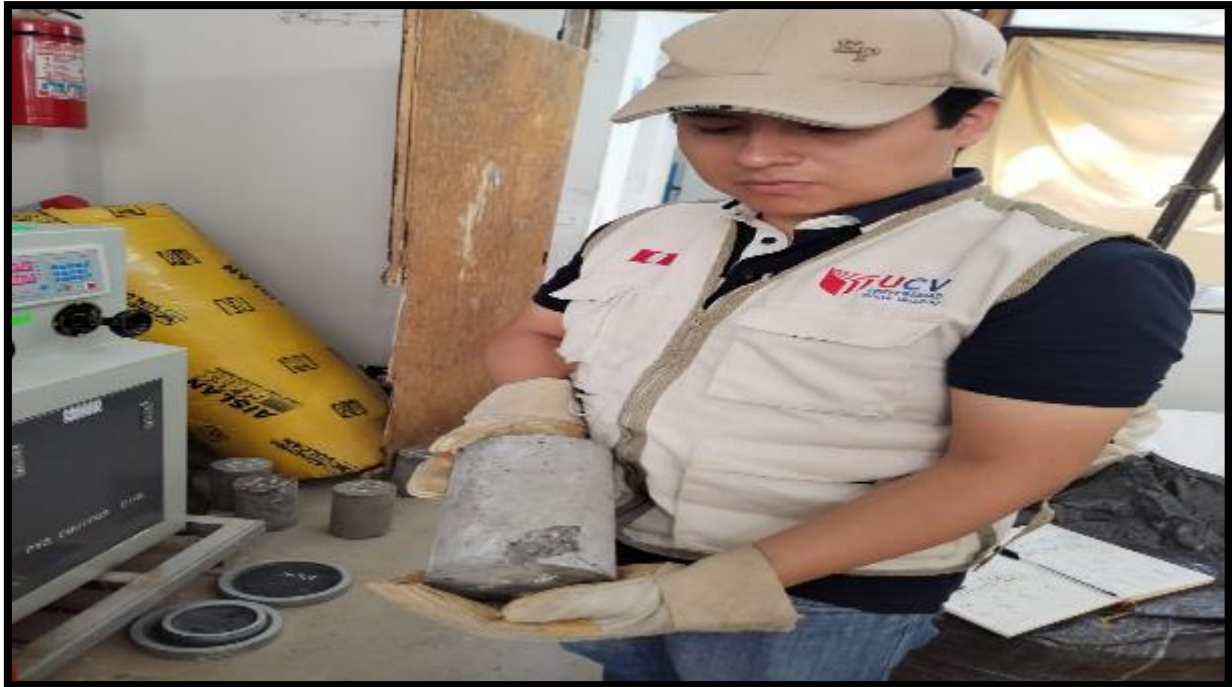
Foto 45. Tesista Quiliche Álvarez Gesvin Julio mostrando la falla de la probeta de concreto con adición de AM a compresión a los 14 días.
