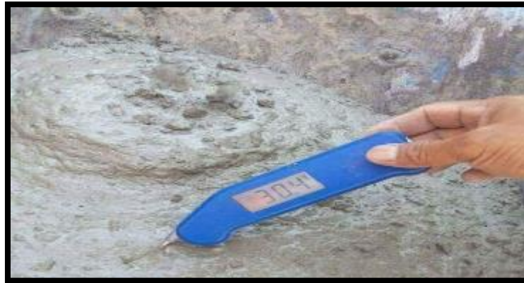
Figura 13. Ensayo de temperatura en mezcla fresca de concreto.
