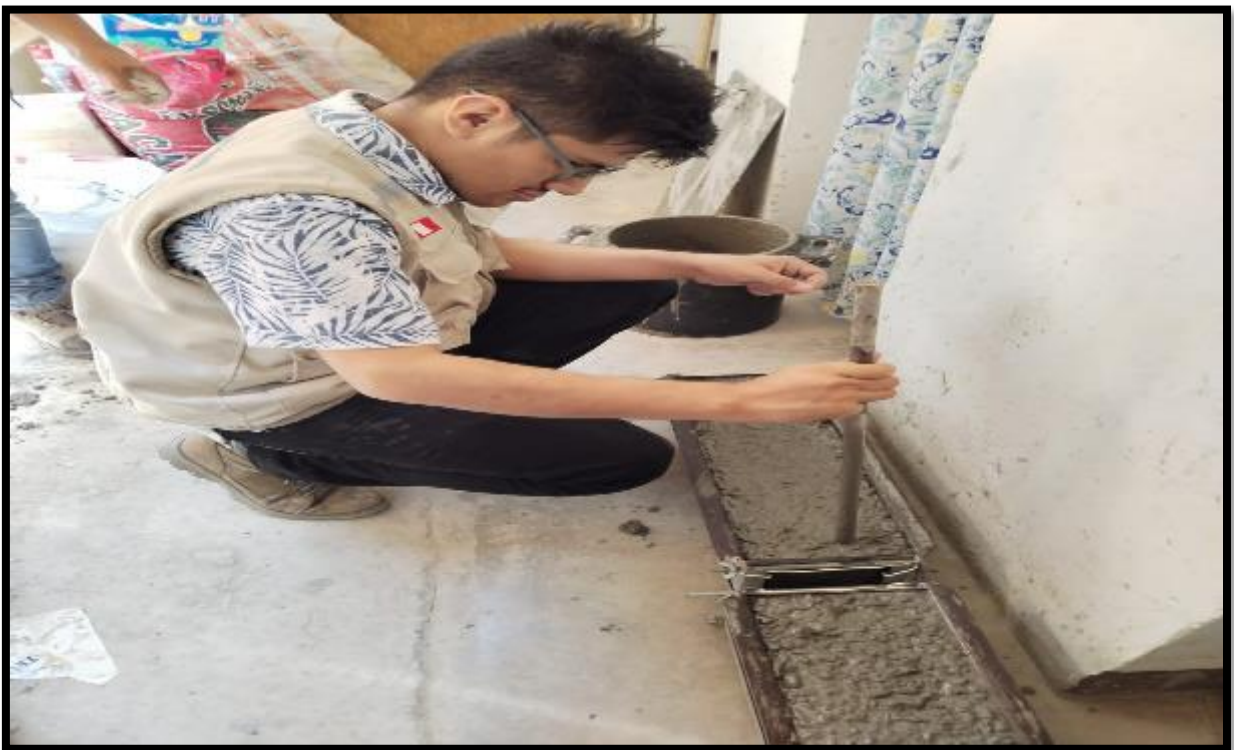
Foto 24. Tesista Villarroel Cieza Marlon compactando con la varilla lisa la mezcla de concreto control en los moldes tipo viga.
