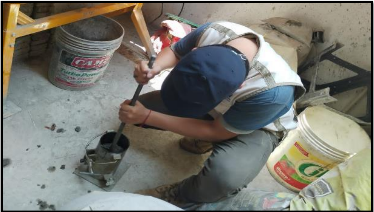
Foto 18. Tesista Quiliche Álvarez Gesvin Julio compactando el concreto con adición de AM en las probetas cilíndricas.
