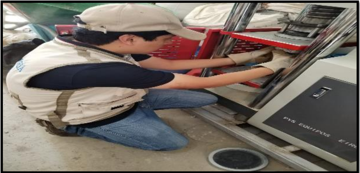
Foto 44. Tesista Quiliche Álvarez Gesvin Julio introduciendo la probeta de concreto con adición de AM a la máquina a compresión.
