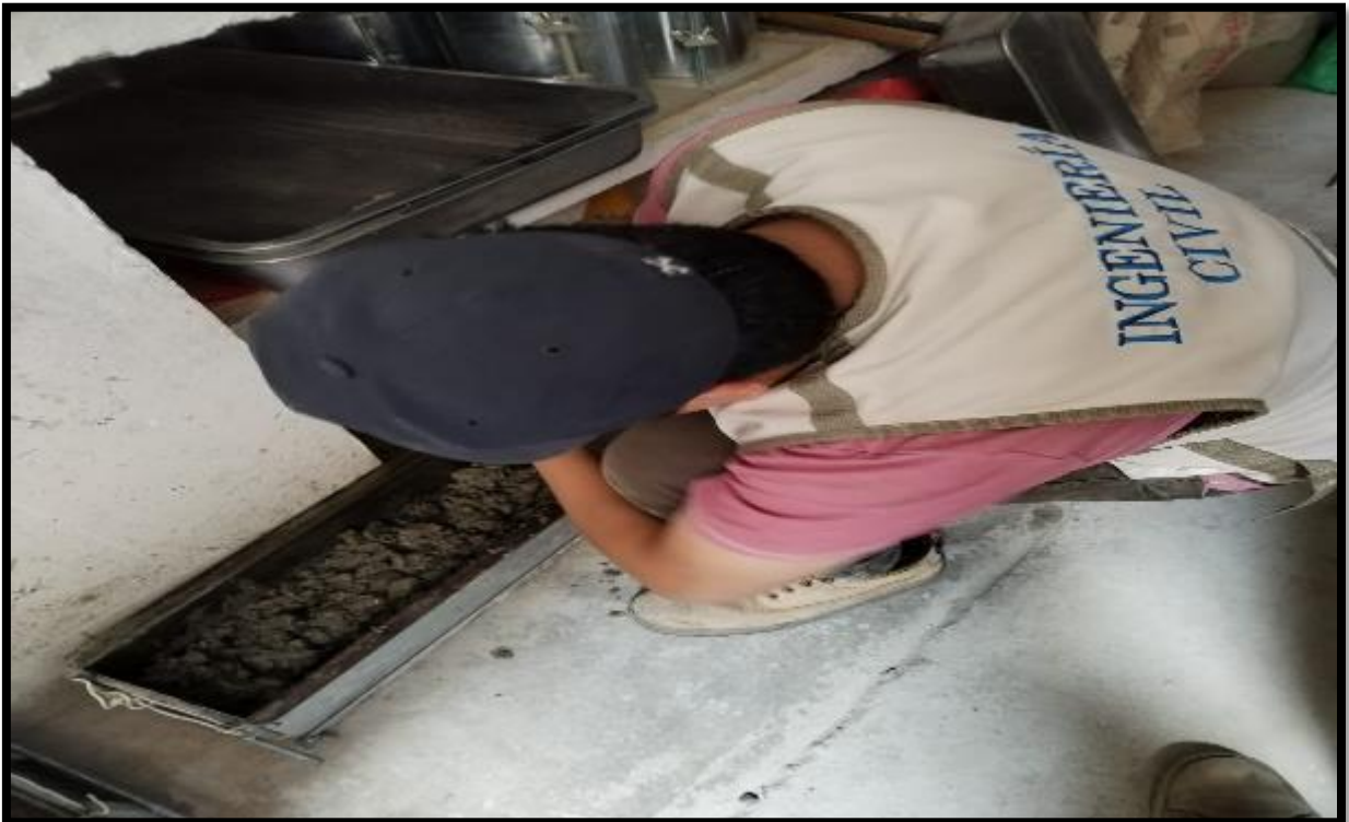
Foto 26. Tesista Quiliche Álvarez Gesvin Julio compactando con la varilla lisa la mezcla de concreto con adición de AM en los moldes tipo viga.
