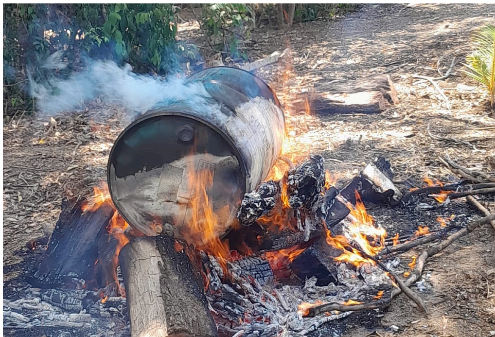
Realizó la incorporación de los materiales en el horno para la carbonización.
