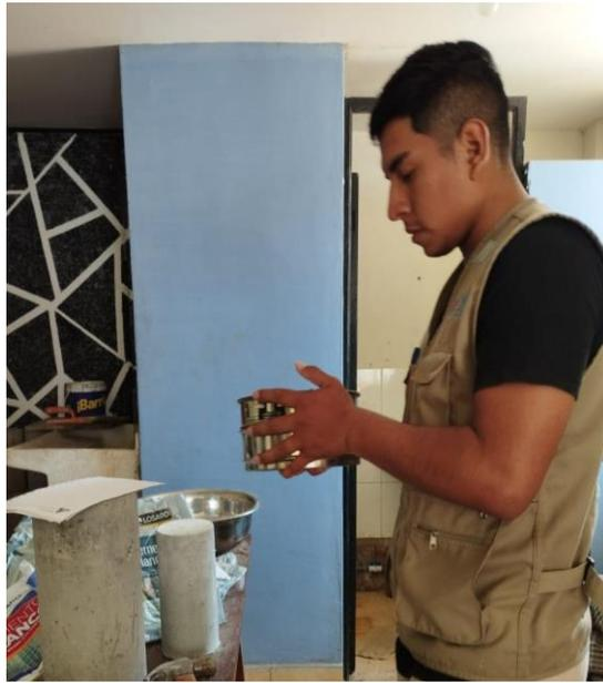
**FOTO N°5:** Vaciado de mezcla a las probetas
