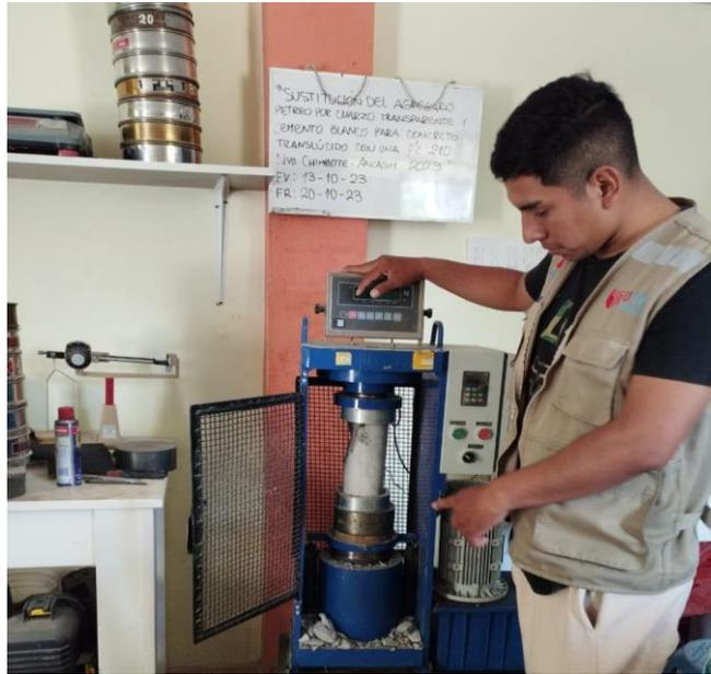
**FOTO N°9: Ensayo de traslucidez al concreto patrón**
