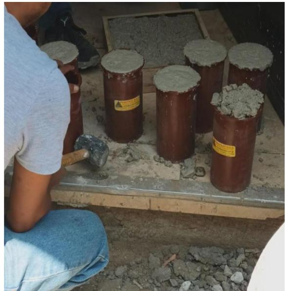
**FOTO N°6:** Enrasado o reglado de mezcla en probetas
