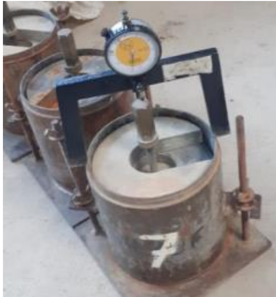
FOTOGRAFIA 01: PRUEBA DE CBR A CALICATA C-01.
