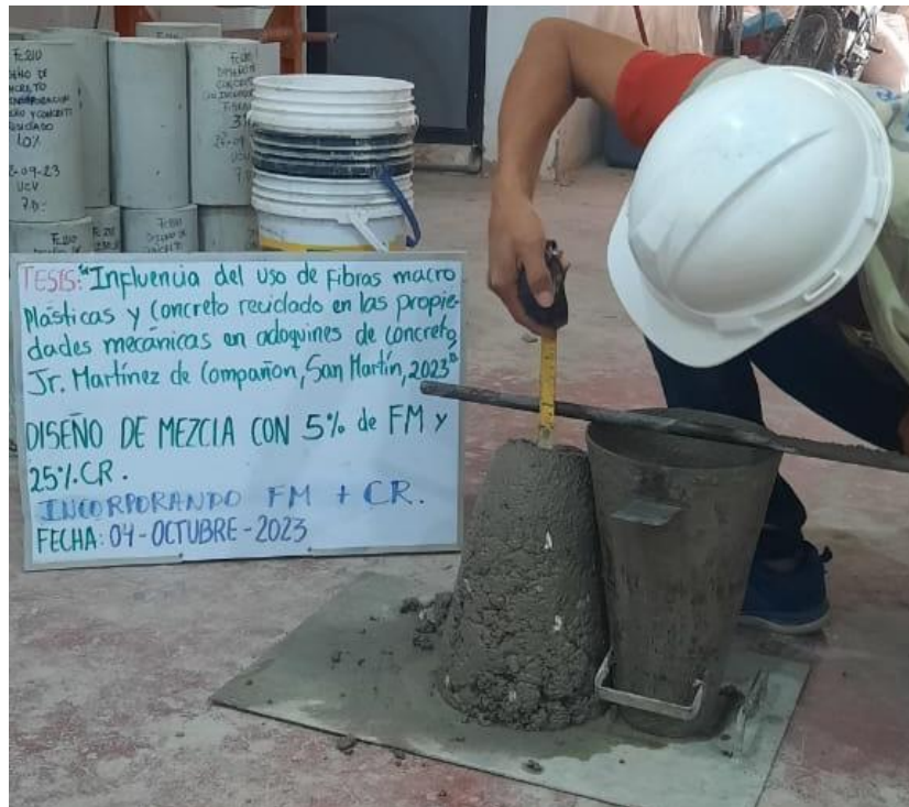
Figura 22. Asentamiento con adición de fibra macroplástica y concreto reciclado.
