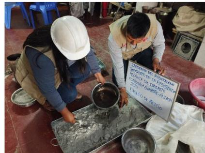
**Paso 6:** Se realiza la prueba de slump.
