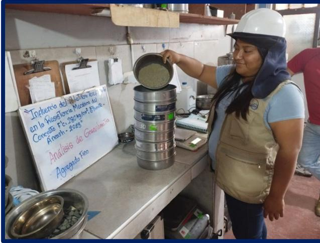
**Figura N° 10.** Fotografía de agitando los tamices con el agregado fino.
