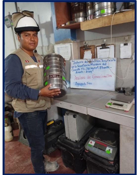
**Figura N° 11.** Fotografía del peso retenido del agregado fino en el tamiz.
