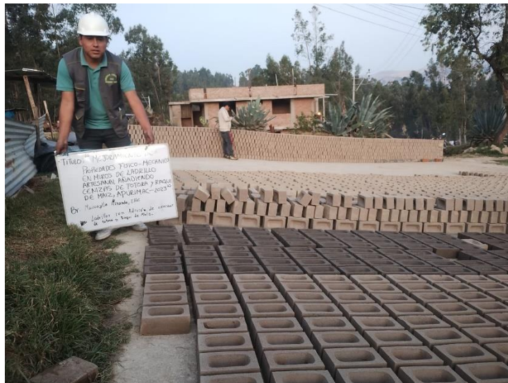
Figura 18. Unidades de ladrillos expuestos al sol Fuente: Autoría
