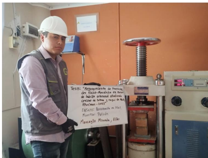
Figura 35. Ensayo de compresión axial en pilas Fuente: Autoría
