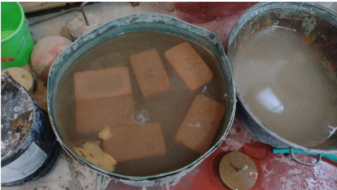
Remojado del ladrillo para determinar el porcentaje de absorción.
