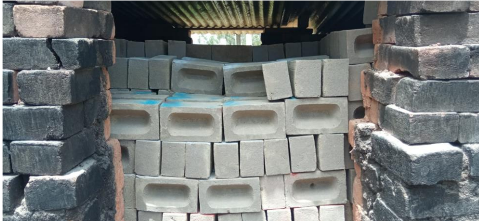
Figura 19. Almacenamiento del ladrillo en el horno Fuente: Autoría
