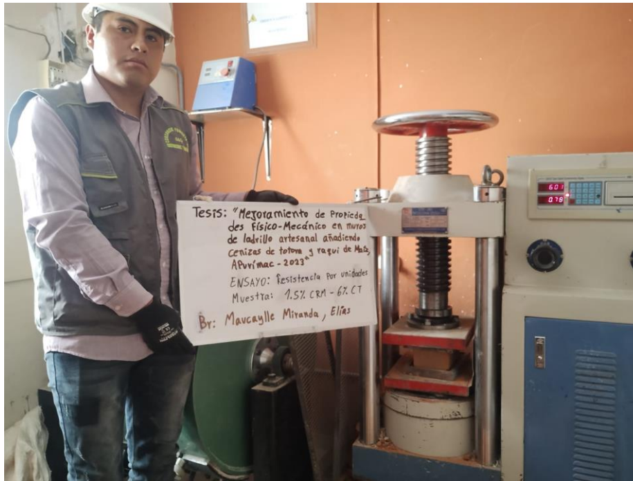
Figura 33. Ensayo de resistencia a la compresión axial por unidades Fuente: Autoría
