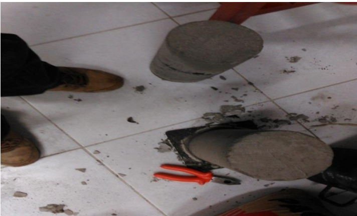
Probetas sustituyendo el 3%, 5% y 10% de yeso
