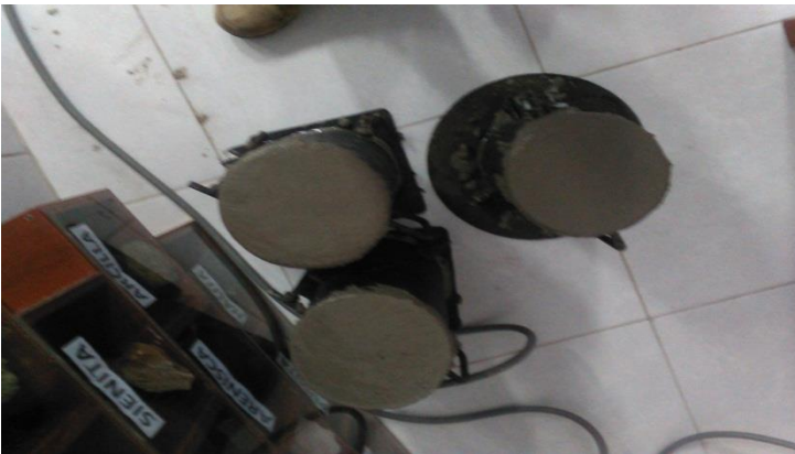
Probetas con sustituyendo el 3%, 5% y 10% de yeso.
