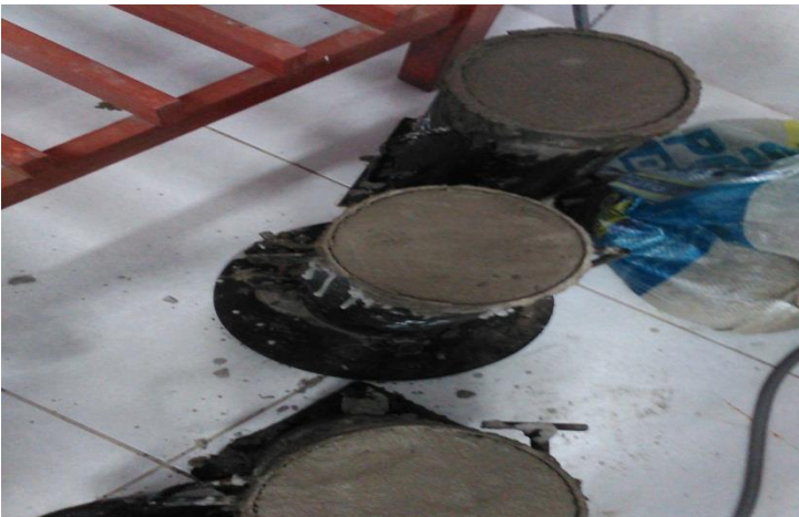
Probetas sustituyendo el 3%, 5% y 10% de arcilla.
