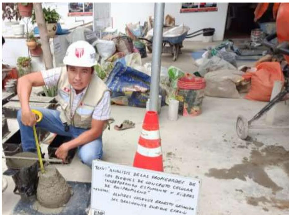
Imagen. Prueba de slump.
