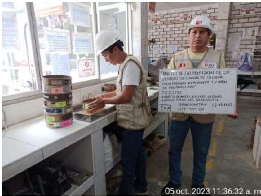
Imagen. Análisis granulométrico, tamizado de agregado fino.
