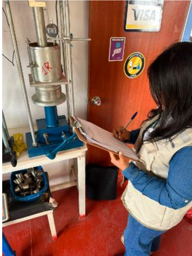
Figura 37. Ensayo de CBR. Fuente: elaboración propia.
