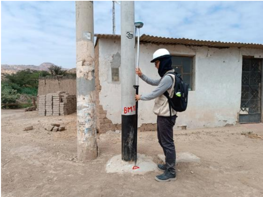
Figura 22. Toma de Punto, BM N°18 – camino a Centro Poblado San Pablo. Fuente: elaboración propia.
