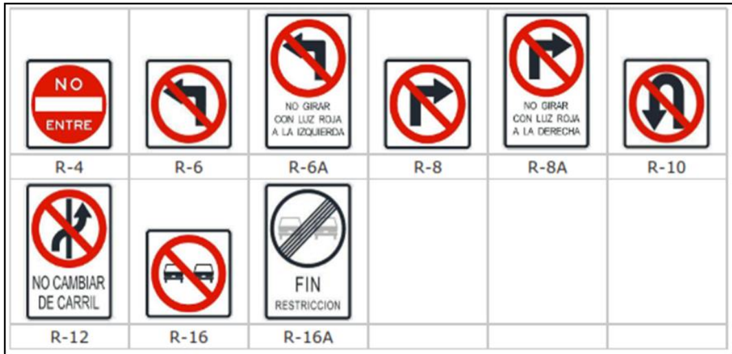
Figura 65. Señales de Prohibición de Maniobra y Giros.
