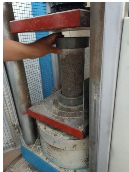
Fotografía 30: Resistencia a la compresión Fuente: Laboratorio ESSENOR S.A.C
