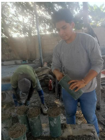
Fotografía 23: Elaboración de las probetas Fuente: La empresa
