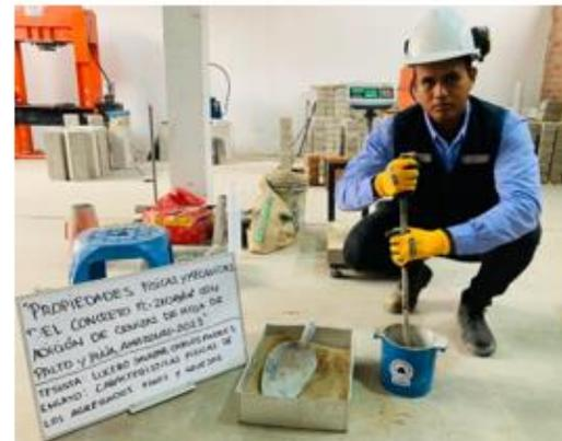
**DETERMINACION DEL PESO ESPECIFICO Y ABSORCION DEL AGREGADO GRUESO**
