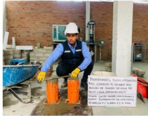
**ELABORACION DE PROBETAS CILINDRICAS**
