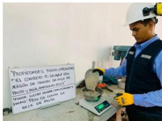
PESO DE LOS MATERIALES PARA DISEÑO DE MEZCLA
