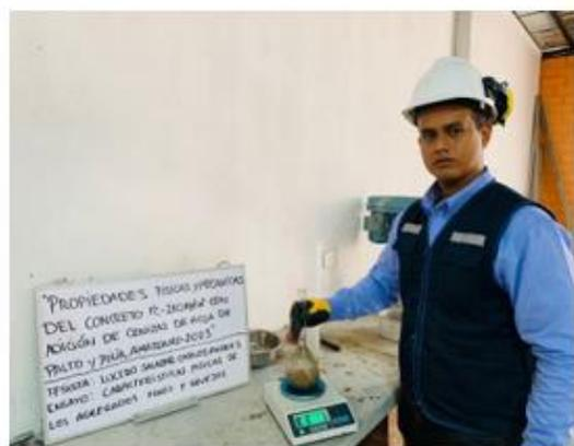
**DETERMINACION DEL PESO ESPECIFICO Y ABSORCION DEL AGREGADO FINO**
