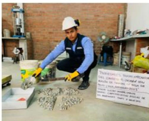
**ENSAYO DE CUARTEO MANUAL DE AGREGADO GRUESO Y FINO**
