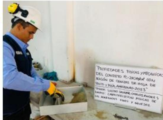
ENSAYO DE GRANULOMETRIA PARA AGREGADOS FINOS Y GRUESOS
