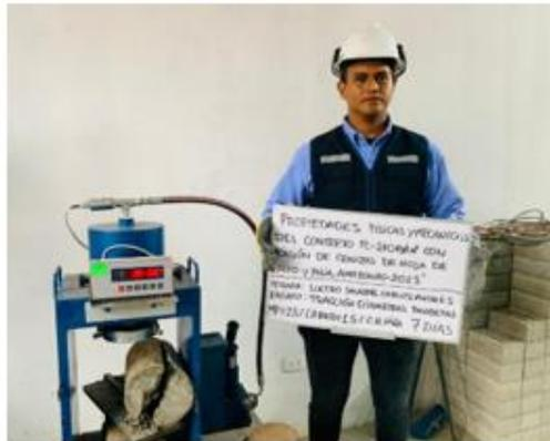
ENSAYO DE TRACCION POR COMPRESION DIAMETRAL
