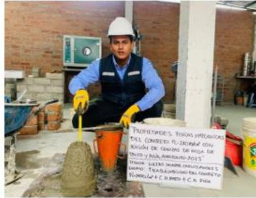
ENSAYO DE ASENTAMIENTO PARA MEDICION DE SLUMP DE 3° -
