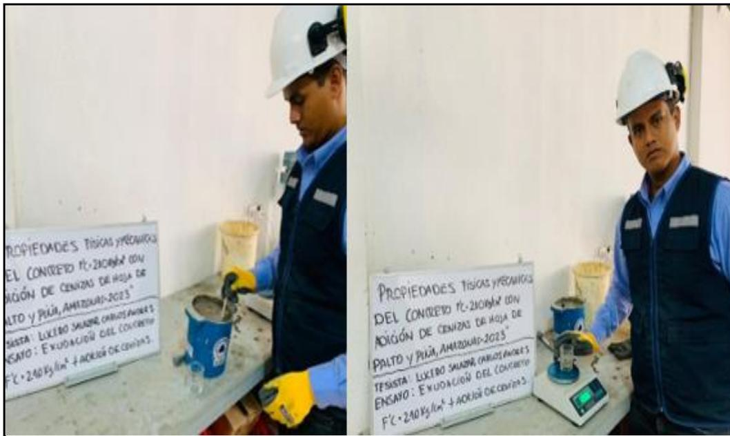
*Figura 22.* Exudación del concreto
