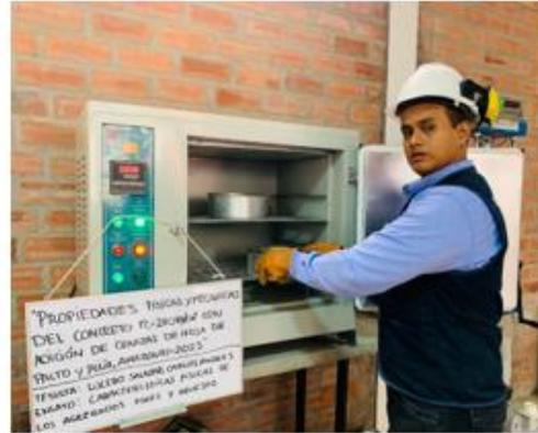
**SECAO DE MUESTRAS DE AGREGADO FINO Y GRUESO AL HORNO POR 24HRS**
