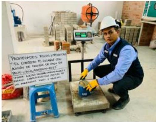
**PESO UNITARIO SUELTO Y COMPACTADO DEL AGREGADO FINO**
