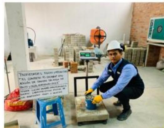
**PESO UNITARIO SUELTO Y COMPACTADO DEL AGREGADO GRUESO**
