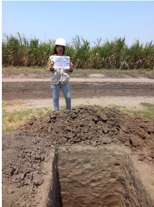
Figura 26. Excavación de la calicata N°17 a una profundidad de 1.50m.
