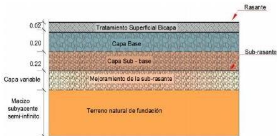
Figura N° 3 Estructura del pavimento flexible
