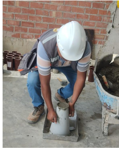
Figura 11. Ensayo de Slump
