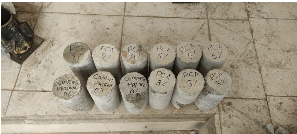
Figura 13. Rotura de probetas con adición de polvo de concha de abanico.
