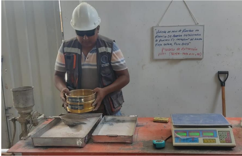
Figura 04. Proceso de triturado con molino manual y separando el filler de PCA
