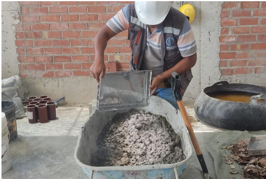
Figura 07. Preparación de la mezcla de concreto con adición de polvo de concha de abanico.
