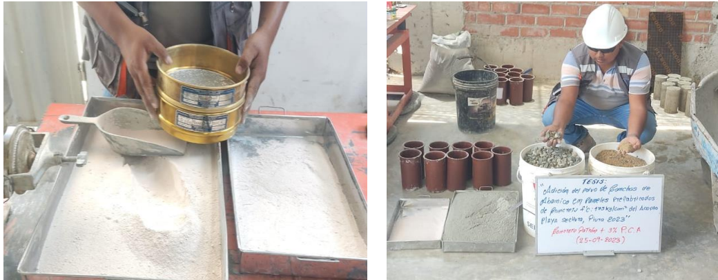
Figura 9. Proceso de tamizado de PCA y preparación de la mezcla.
