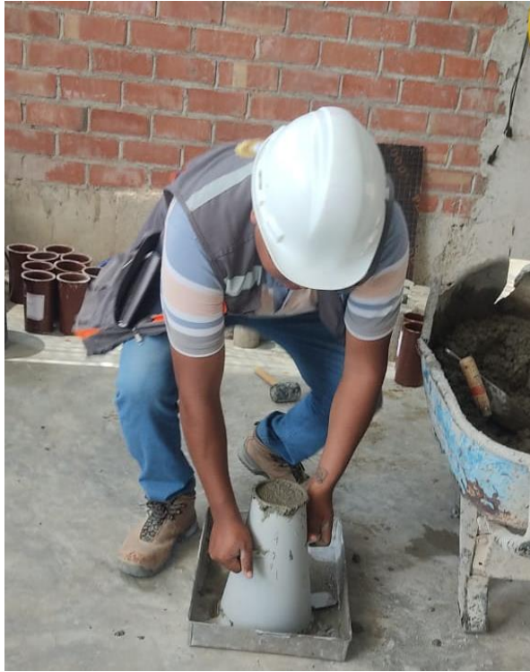
Figura 10. Ensayo de Slump del concreto estado fresco
