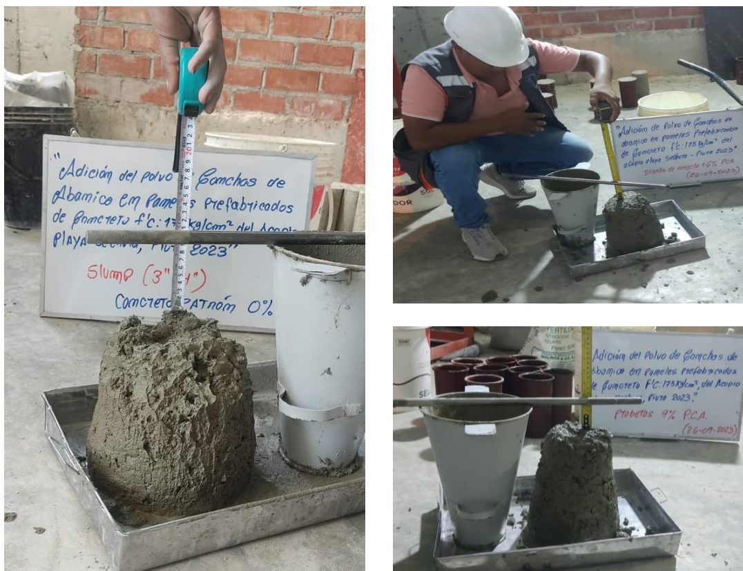
Figura 18. Ensayo de Slump (trabajabilidad del concreto).
