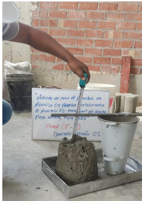
Figura 11. Resultado del ensayo de Slump para un concreto fresco.
