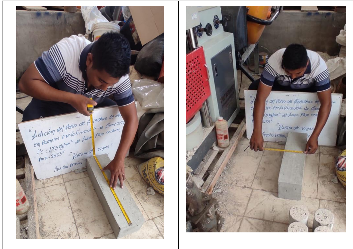
Figura 24. Esfuerzo a flexión + adición de PCA.
