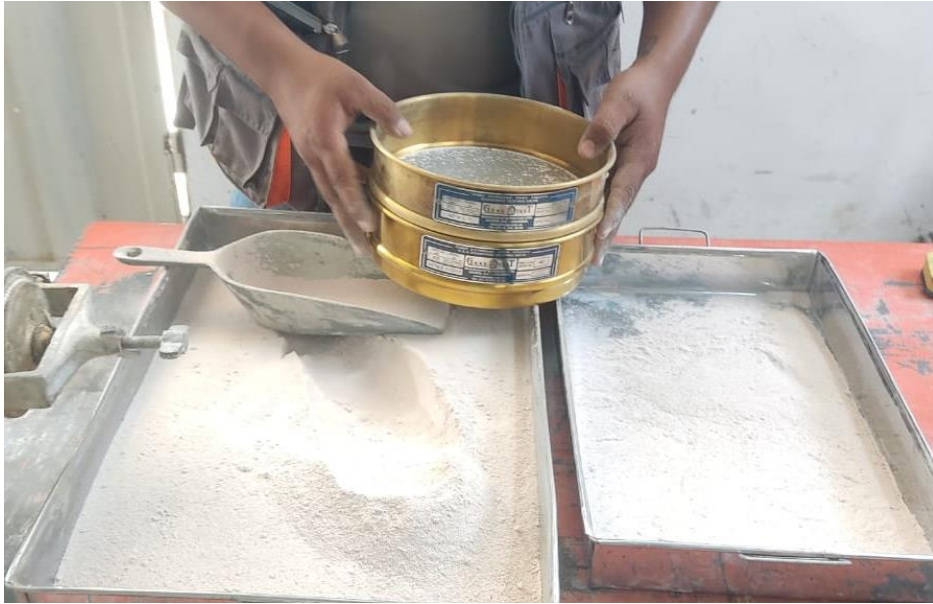
Figura 06. Proceso de seleccion de polvo de concha de abanico empleando tamices.
