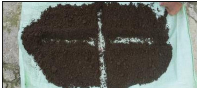
Figura 10: Cuarteo de Muestra de Suelo
