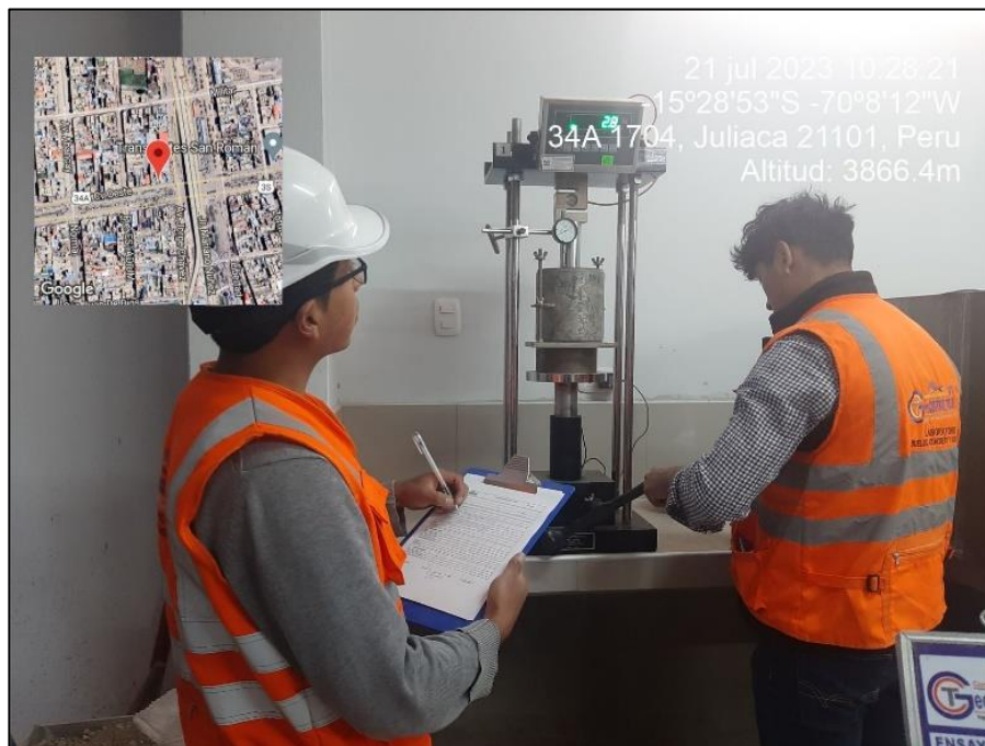
Figura 15: Prueba de penetración para determinar del CBR.
