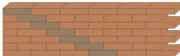
Figura 4: Asentado de ladrillo de soga.
